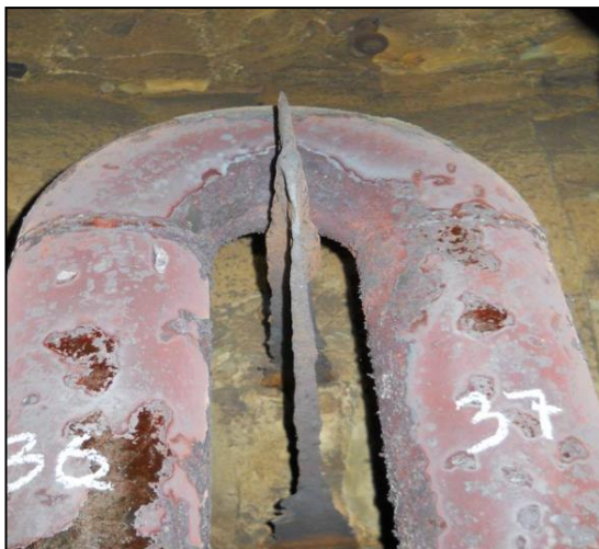
Figura 10. Soporte de tubo desgastado Fuente: elaboración propia.
