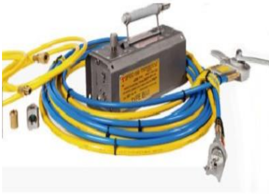
Figura 16. Equipo de gammagrafía industrial fuente: Inspectra S.A.
