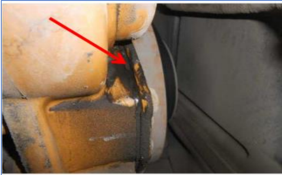
Figura 11. Humedecimiento por cubierta delantera lado derecho del motor Sello N/P 223-7852 SEAL-INTEGRAL
