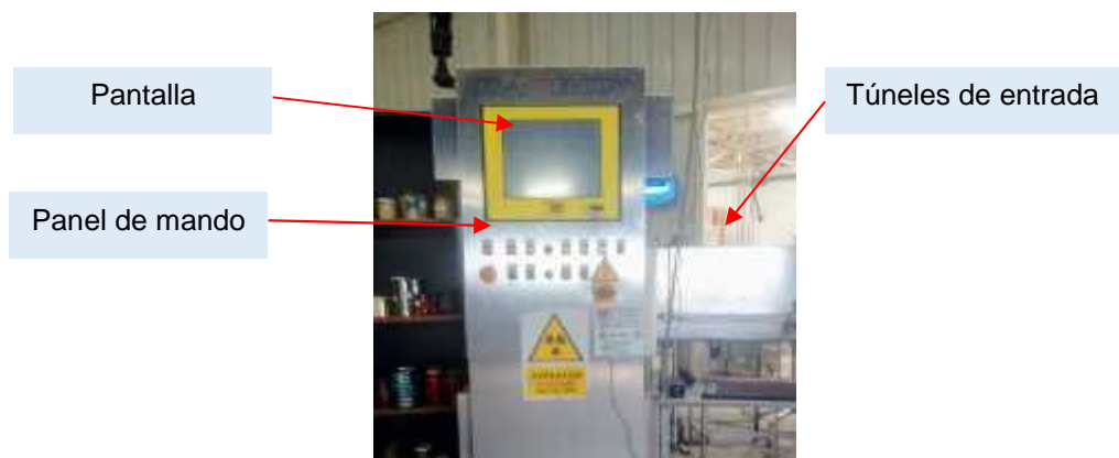
Figura 22: Calibración de máquina Rayos X
