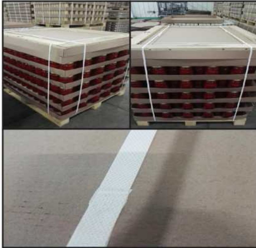
Figura 19: Enzunchado con Maquina Enzunchadora a batería
