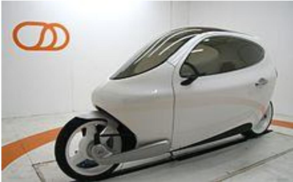
**Vehículo totalmente eléctrico, estabilizado giroscópicamente.**
