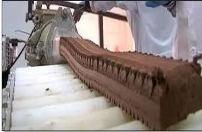
Figura39. Formado del Ladrillo Techo N° 15.
