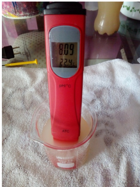
Figura. Medición del ph a la muestra de agua de acequia (testigo)
