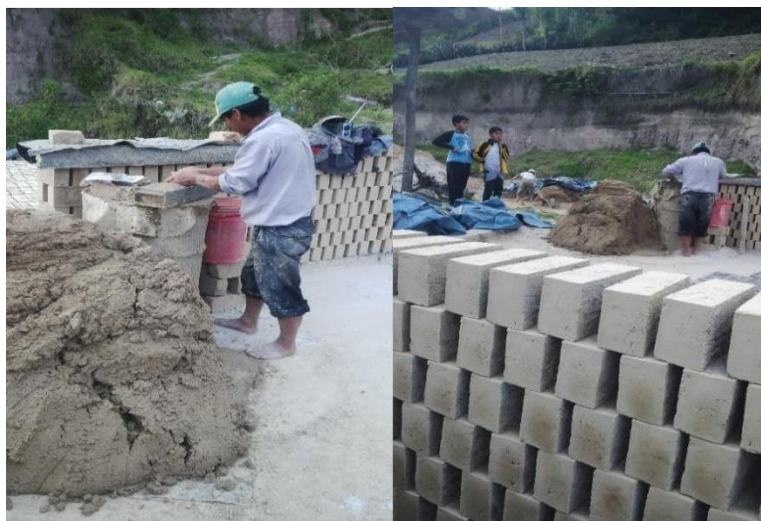
Ilustración 3. Moldeo del ladrillo artesanal
