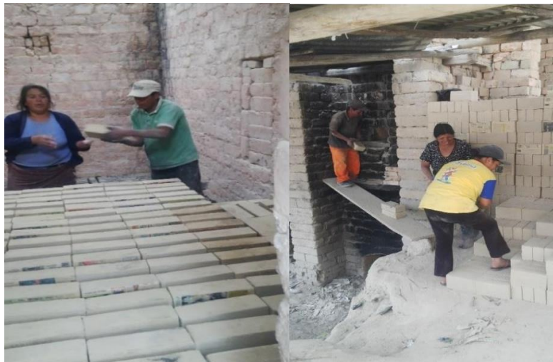
Ilustración 5. Carguío del horno
