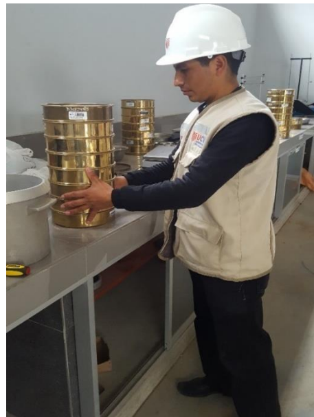
Ilustración 12. Tamizado de suelos
