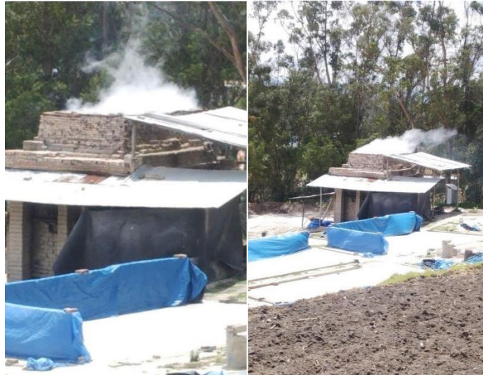
Ilustración 6. Cocción de los ladrillos
