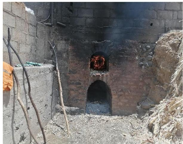
**Figura 09:** Calcinación del bagazo de caña
