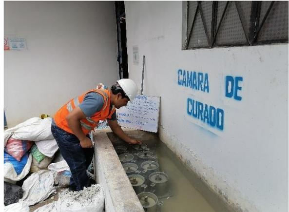
**Figura N°28:** ensayo de CBR + 15% ceniza caña
