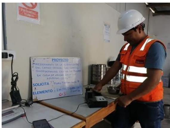
**Figura N°25:** Ensayo de Limite Líquido y plástico
