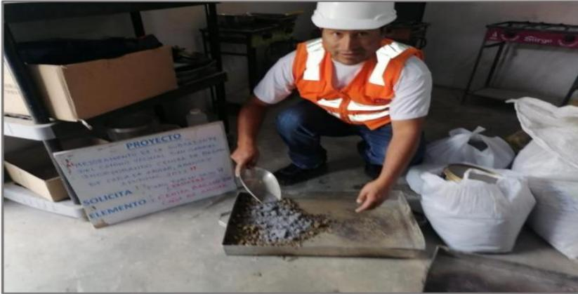
**Figura N°22:** mezclado muestra C-3 con 5% ceniza de caña.
