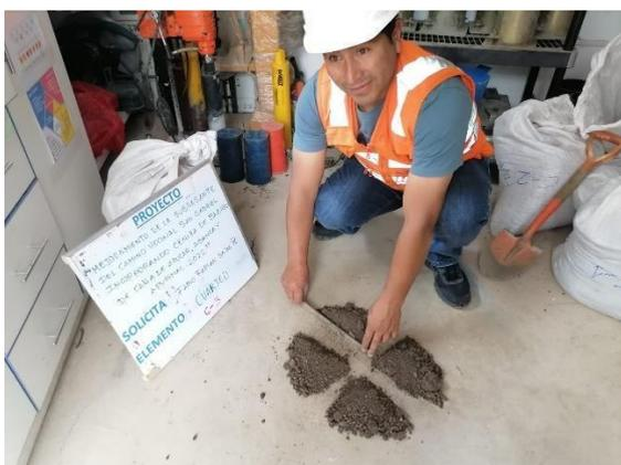
**Figura N°20:** cuarteo muestra C-3
