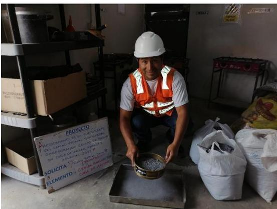
Tamizado de ceniza de bagazo de caña para realizar la granulometría y posteriormente el mezclado con la muestra natural, en 5%, 10% y 15% de CBCA.
