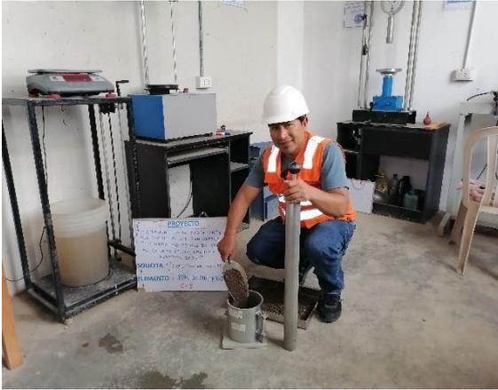
**Figura N°27:** Ensayo de Proctor
