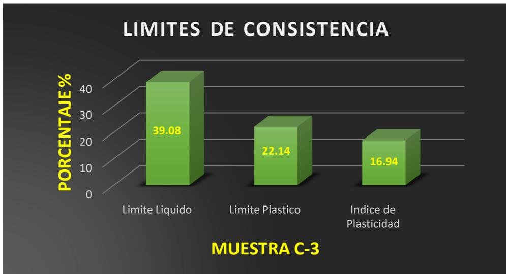
**Figura N° 16:** Gráfico límite de consistencia de la muestra natural
