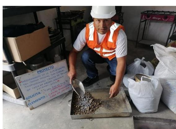
Mezclado de muestra patrón con adición de ceniza de bagazo de caña
