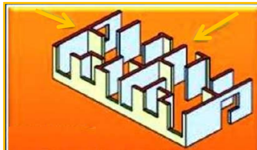
FIGURA N° 18 Cantidad de muros en las dos direcciones
