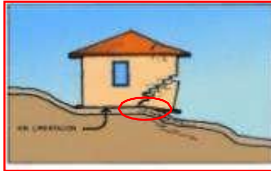
FIGURA N° 52 Vulnerabilidad alta: cimentación
