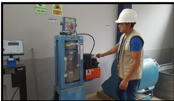
Figura 41: Ruptura probetas en la máquina de compresión.
