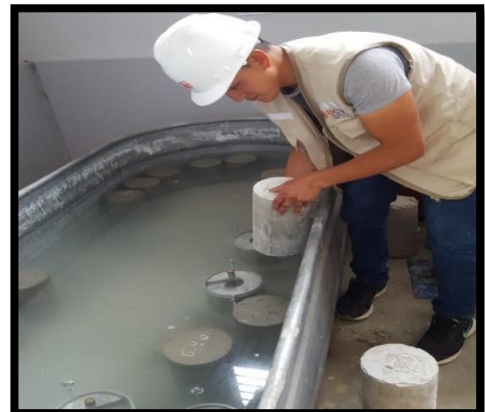
Figura 40: Colocación de las probetas en agua.
