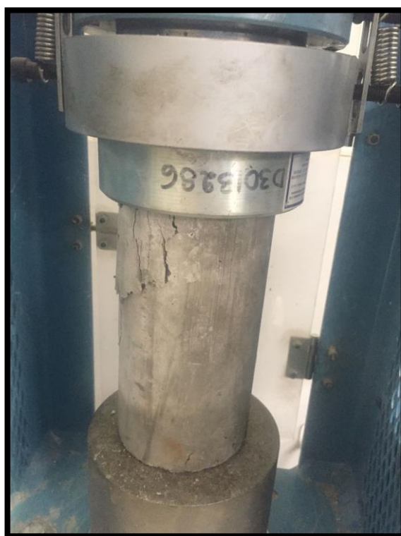
Figura 43: Rotura de probeta.
