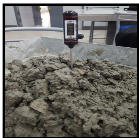
Figura 25: Temperatura obtenida con el 3% cal viva.
