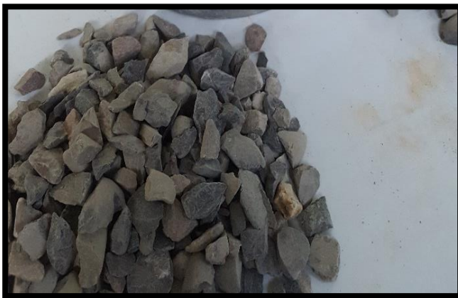
Figura 18: Después de cumplir el agregado en el agua es sacado
