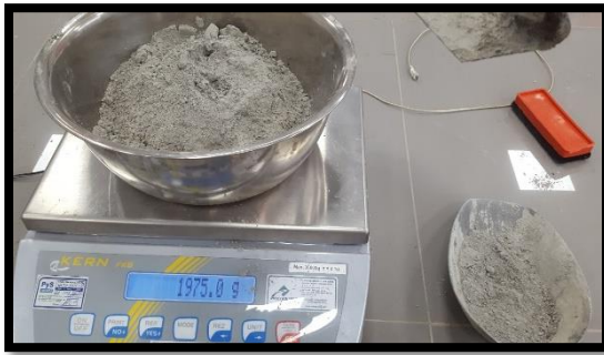
Figura 31: Pesado de cemento.
