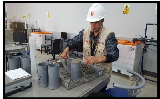
Figura 36: Enrasado de probetas.
