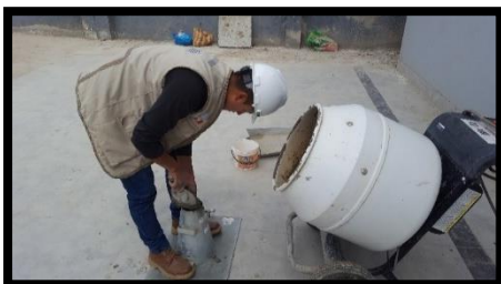
Figura 27: Llenado de cono de Abrams.
