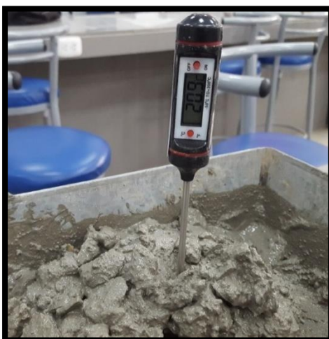
Figura 24: Temperatura obtenida con el 1% cal viva
