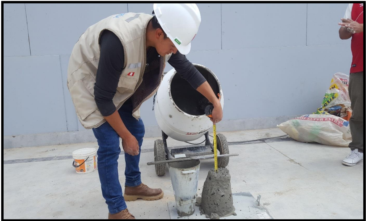
Figura 30: Medición del asentamiento.
