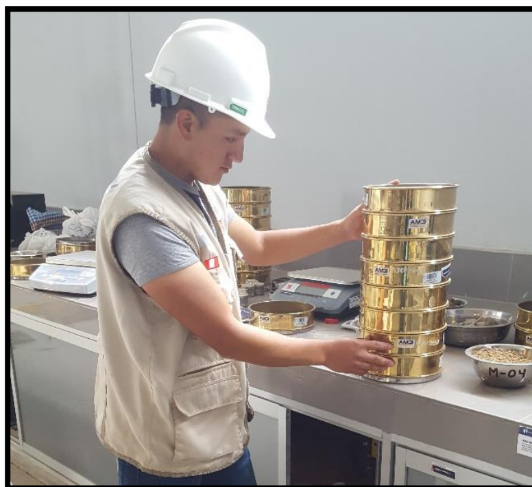
Figura 13: Colocación de los tamices en el Orden correcto.
