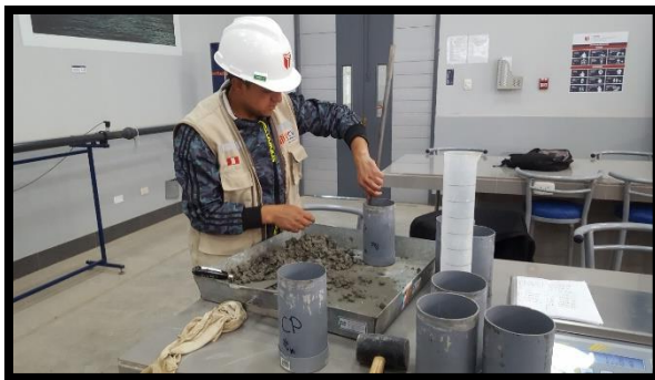
Figura 35: Varillado en la elaboración de probetas.
