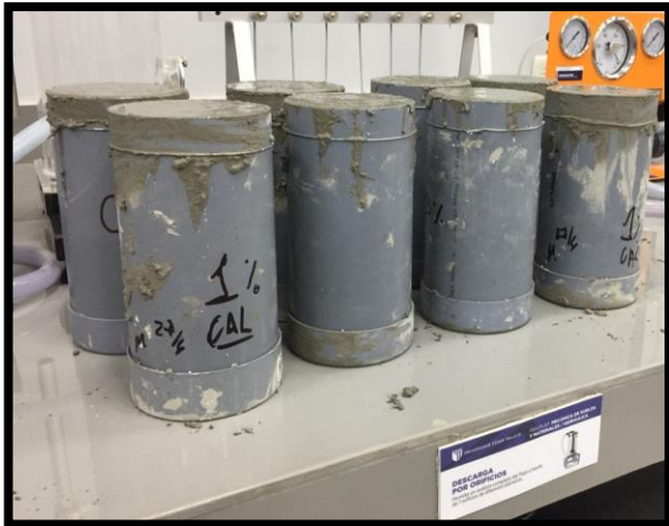
Figura 37: colocación de una bolsa para evitar la evapotranspiración.
