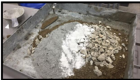
Figura 33: Colocación de la cal viva en peso de cemento.
