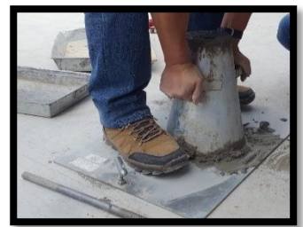
Figura 29: Preparación para levantar el cono cuidadosamente.
