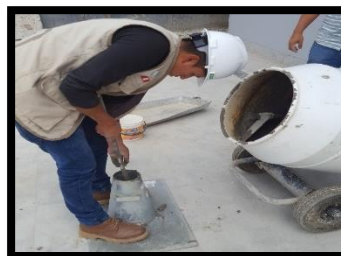
Figura 28: Varillado por cada copa.
