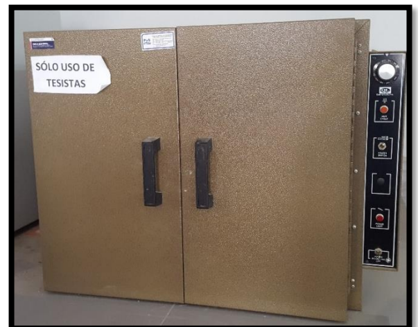
Figura 19: Luego es colocado para determinar su contenido de Humedad
