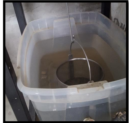
Figura 17: Colocación del Agregado en el agua.
