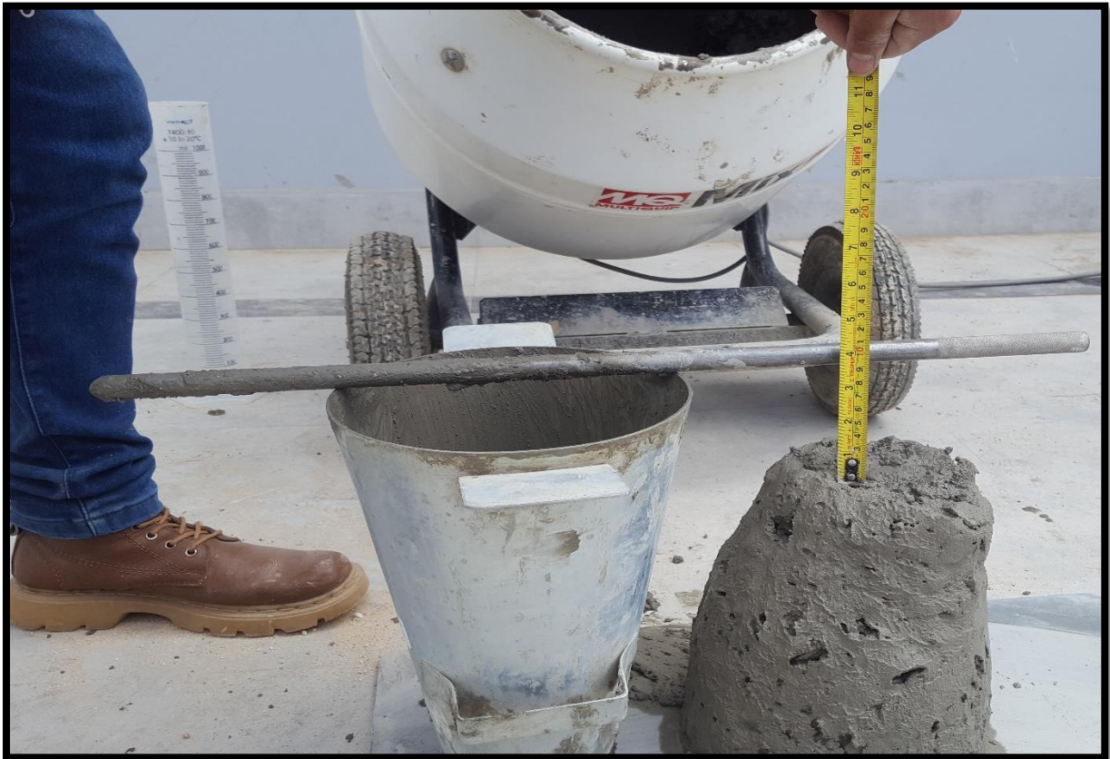
Figura 30: Medición del asentamiento.
