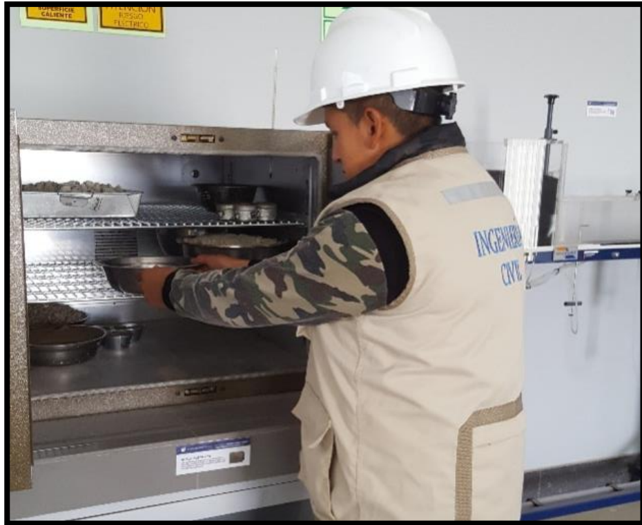
Figura 11: Colocación de Muestras en el Horno.
