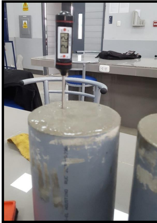
Figura26: Temperatura obtenida con el 5% de cal viva.
