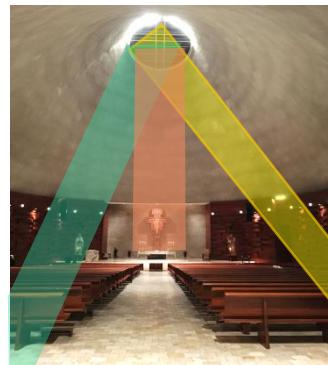
La iluminación en la capilla se da por un gran ducto circular en el techo inclinado hacia el norte, permitiendo el ingreso del sol de mayor longitud solo en horarios de la mañana, como se muestra en la fig. 1, 2 y 3
