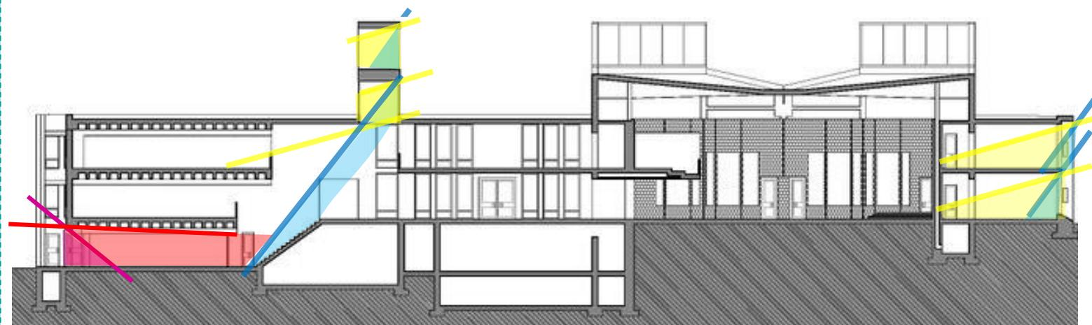
Los muros laterales de las ventanas funcionan como parasoles, evitando el ingreso total de los rayos del sol.
