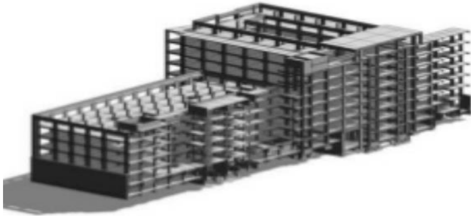
Figura I-2: Estructura con base en columnas y muros estructurales, sistema dual, de acuerdo con la norma E030.
