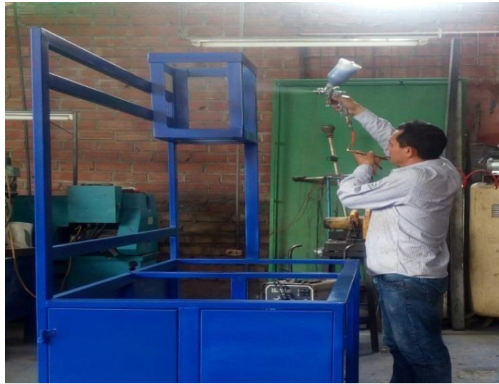
Pintado de la estructura
