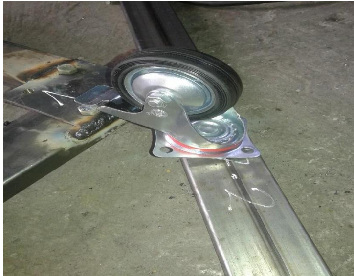
Montaje de garruchas
