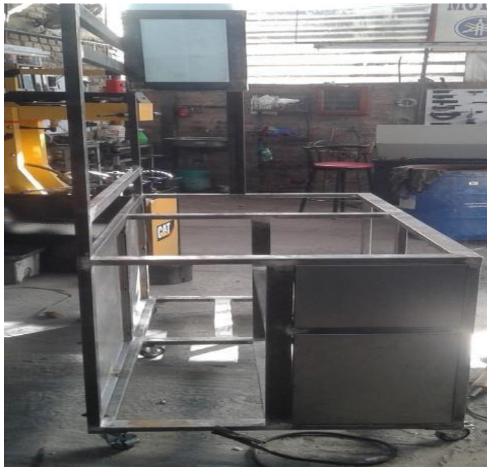
Montaje de planchas metálicas
