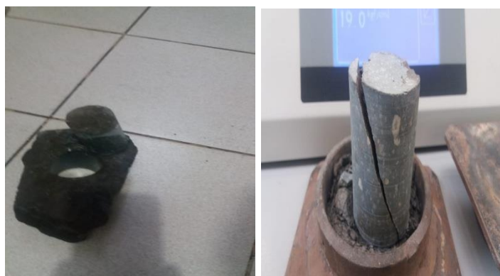
Figura 13. Ensayo de compresión de corazones diamantinos
