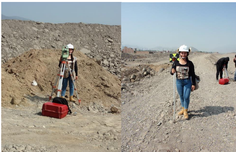
Figura 10. Estación total Leica y Prisma.
