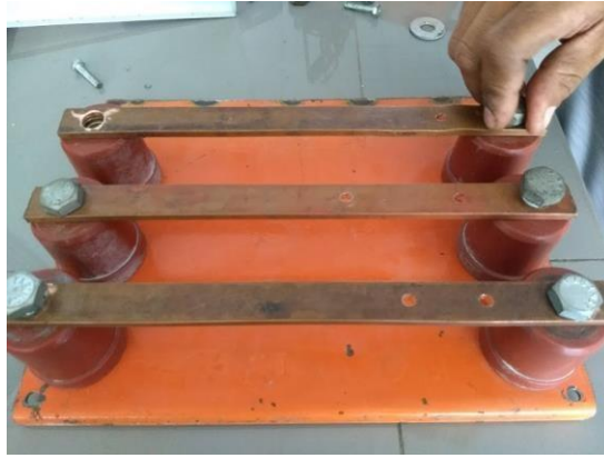
Fig 10. Montaje de barras rectangulares de Cu
