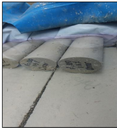
Figura 26. Curado de muestras de concreto.
