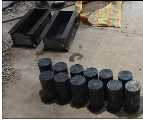
Figura 21. Moldes para elaboración de cilindros y vigas de concreto.
