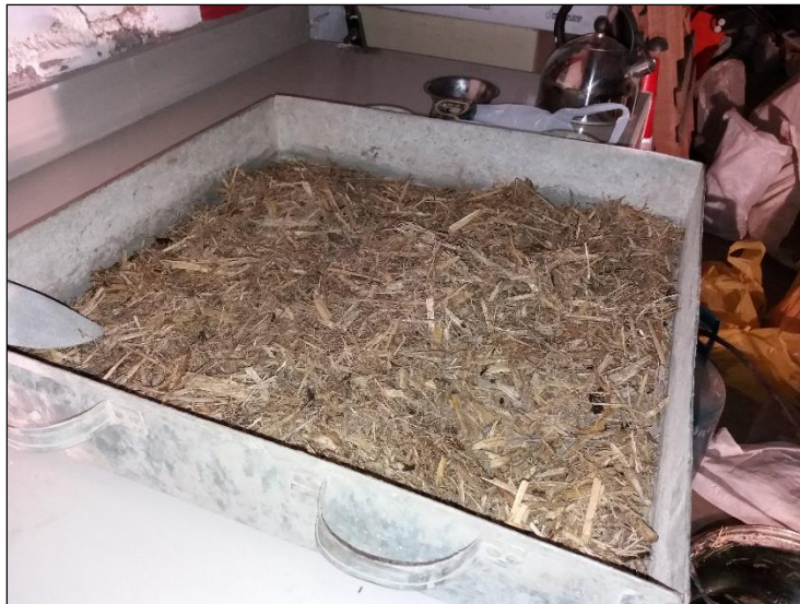
Figura 44. Fibra mezclada en su totalidad con parafina.
