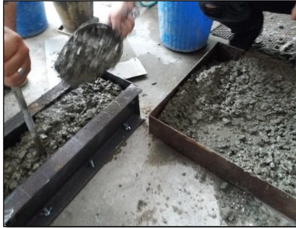
Figura 23. Compactado de la mezcla de concreto.
