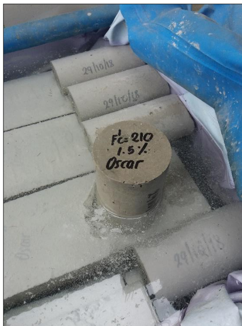
Figura 48. Tanque improvisado para curado de probetas y vigas. Fuente: Elaboración propia.
