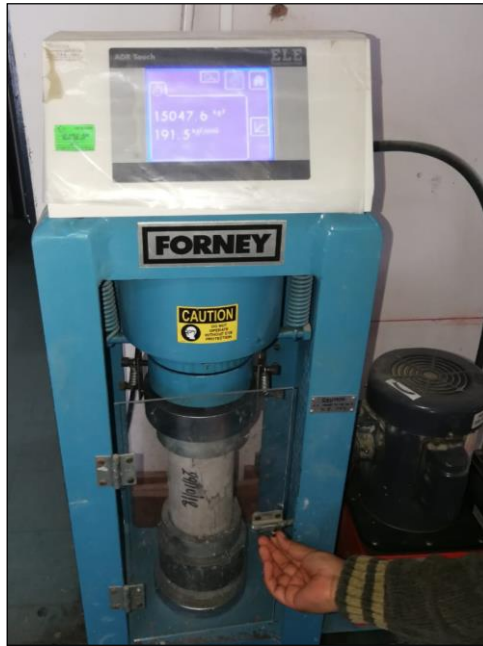
Figura 49. Ensayo a compresión.
