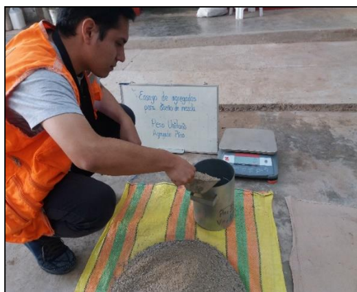
Figura 13. Ensayo de peso unitario del agregado fino.
