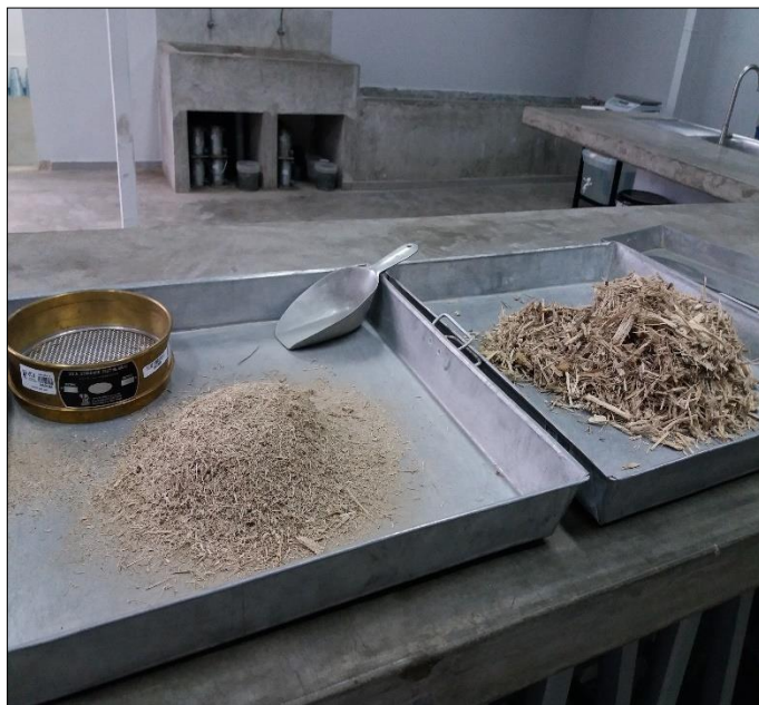
Figura 39. Fibra que pasa y fibra retenida por la malla N°6(3.35mm). Fuente: Elaboración propia.
