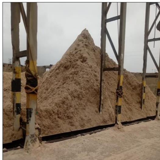
Figura 38. Desecho industrial, conocido como fibra de bagazo Fuente: Elaboración propia.
