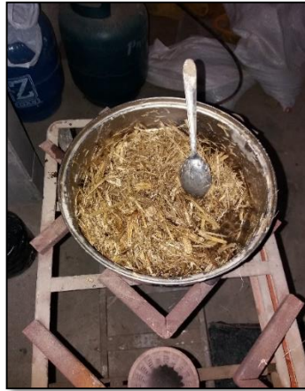
Figura 19. Tratamiento del bagazo con parafina.
