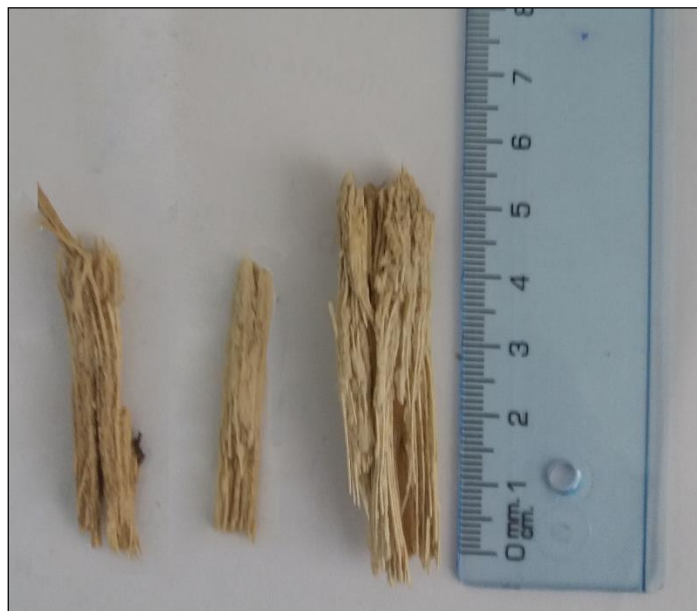
Figura 40. Fibra homogénea de 3-6cm Fuente: Elaboración propia.
