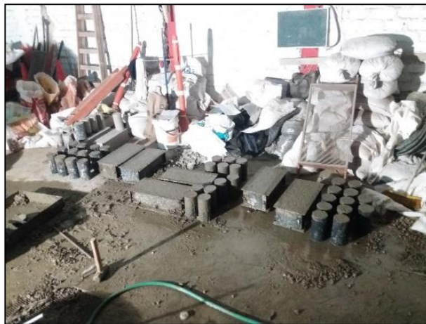
Figura 24. Elaboración de las 56 muestras de concreto a ensayar.
