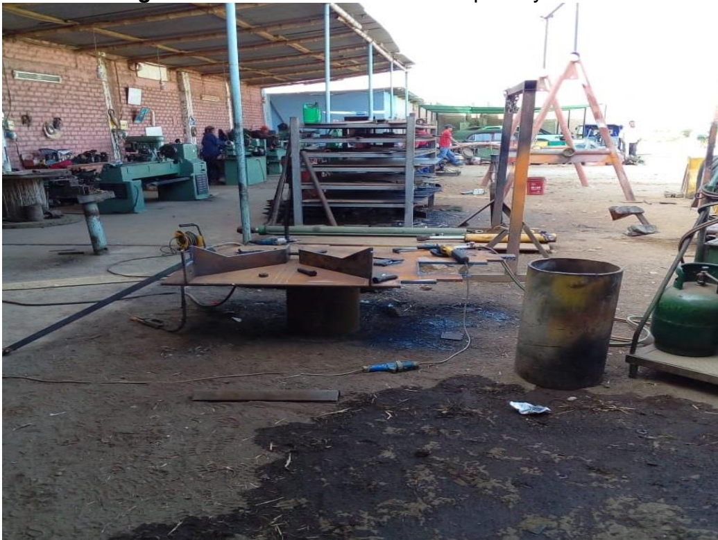
Figura 25: Taller con deficiencia limpieza y orden
