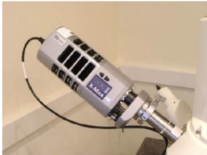
Fotografía N°02: Sonda EDS utilizado para detectar rayos X y dispersa en un espectro su energía.
