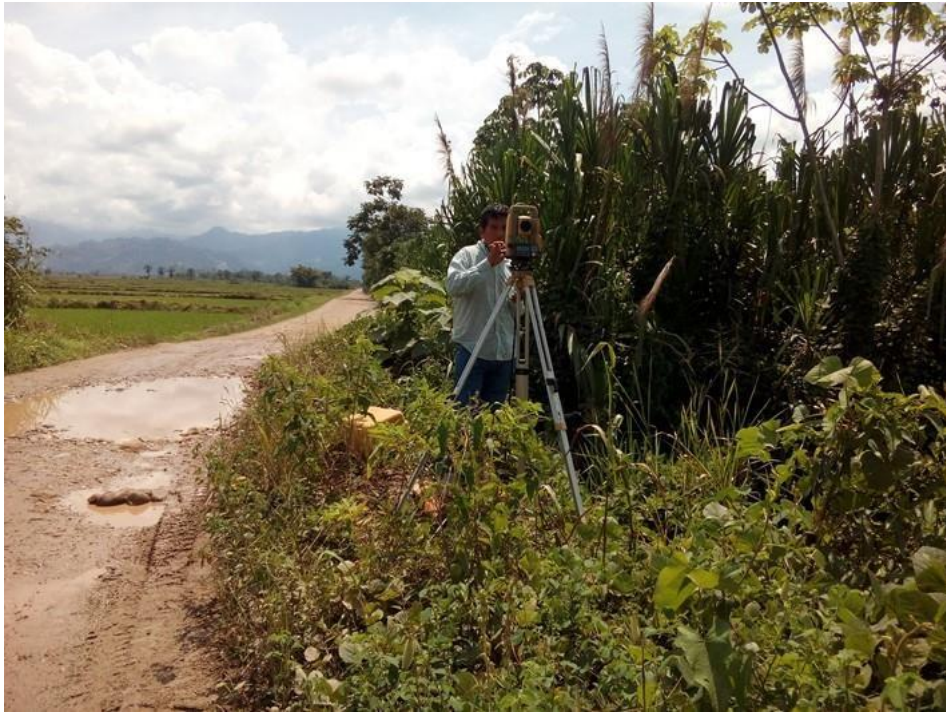
FOTOGRAFIA N° 03. En la vista se aprecia el equipo de estación total empleado en el levantamiento topográfico.
