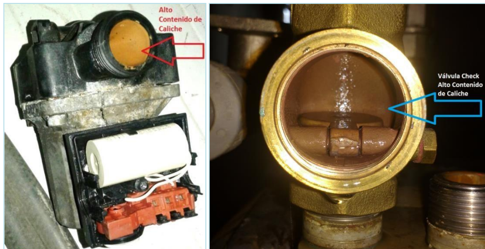
Figura 15 Alto Contenido de Caliche en Accesorios
