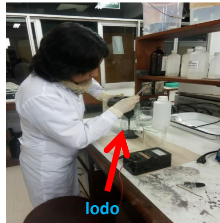
Figura 11. Colocación de Lodo anaerobio y agua residual en la CCM
