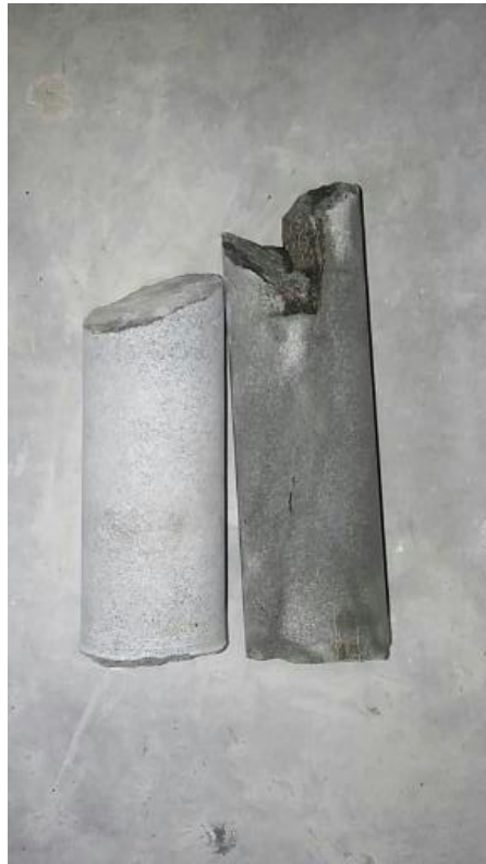
Figura 71: Testigos de la roca andesita Fuente: Propia
