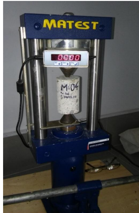
Figura 87: Ensayo de carga puntual de tipo de roca dacita Fuente: Propia
