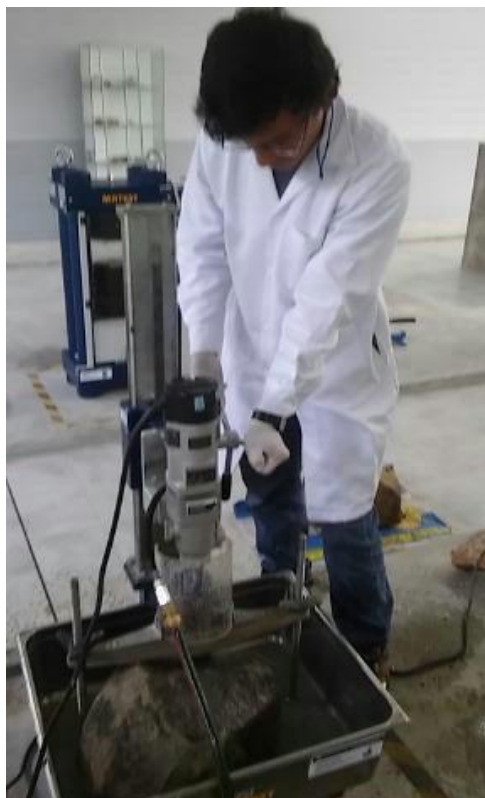
Figura 70: Se perfora la roca para poder sacar testigos Fuente: Propia
