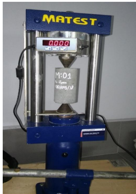
Figura 84: Ensayo de carga puntual Según Louis Fuente: Propia
