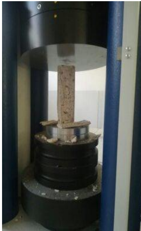
Figura 91: Termino del ensayo de compresión uniaxial Fuente: Propia
