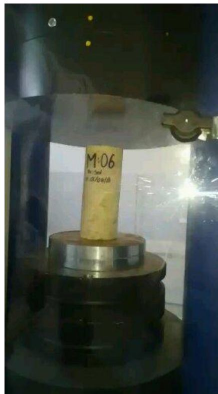
Figura 89: Desarrollo del ensayo uniaxial para rocas Fuente: Propia
