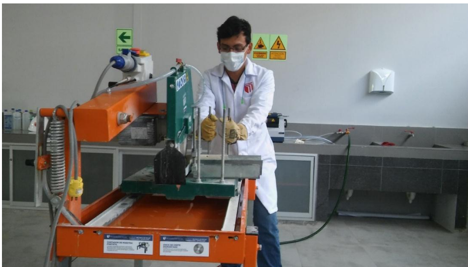
Figura 74: Pulido de las testigos para su posterior ensayo Fuente: Propia
