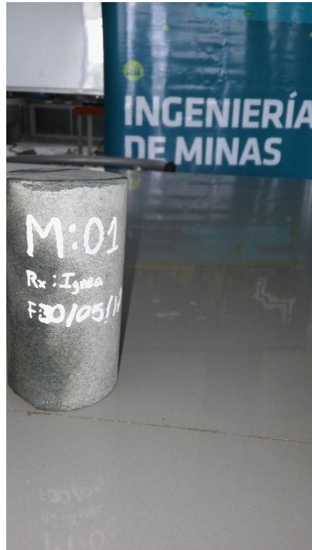
Figura 79: Testigo terminado de andesita Fuente: Propia
