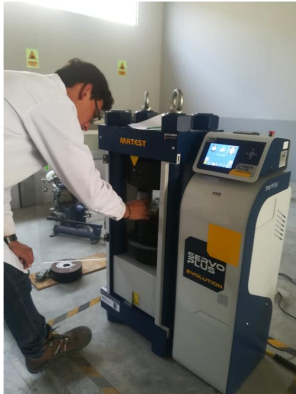
Figura 90: Se coloca la muestra en la maquina Fuente: Propia
