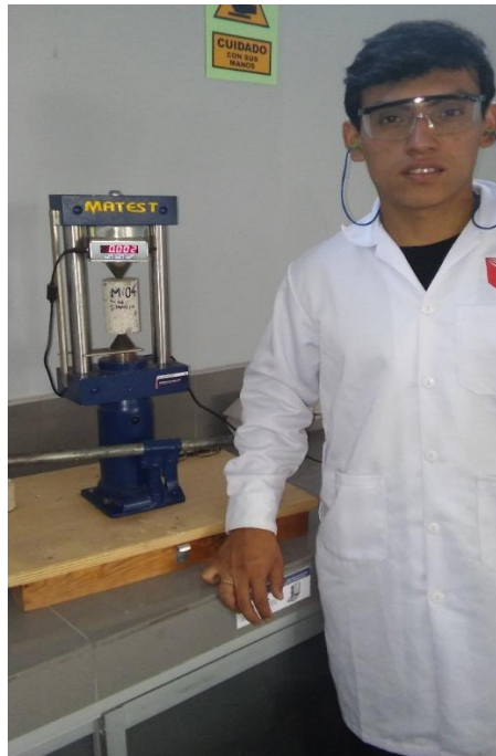
Figura 86: Ensayo de carga puntual según Louis Fuente: Propia
