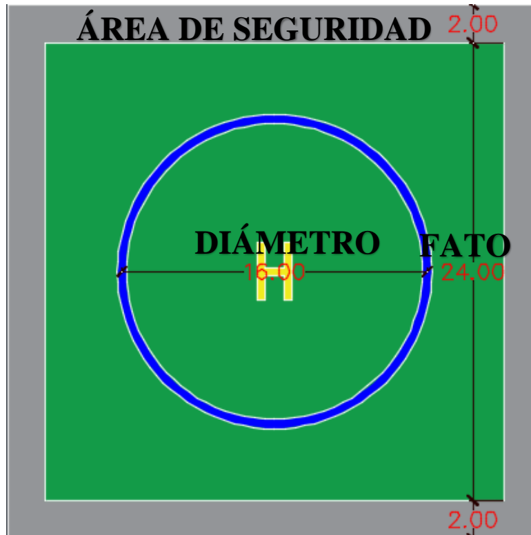
Figura 12: Planta de helipuerto – elaboración propia
