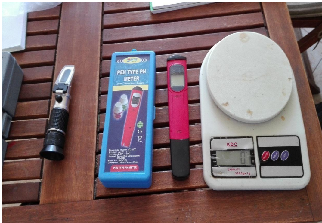
Equipos (balanza, pH metro y refractómetro) utilizados en la elaboración de mermelada mixta.
