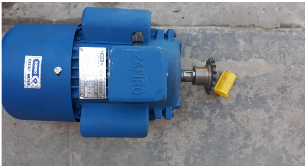
IMAGEN N°4: MOTOR ELECTRICO DE 1 HP
