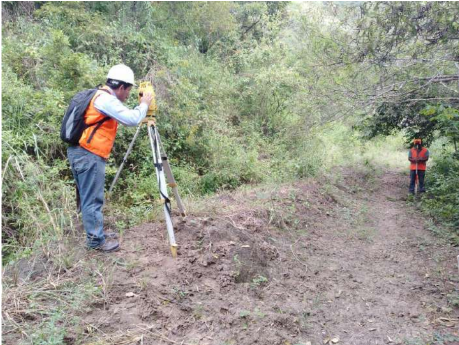
Fotografía 8. Levantamiento topográfico proyectado a línea de conducción
