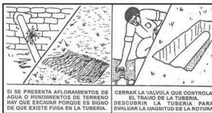
Inspeccionar la línea para detectar fugas y repararlas
