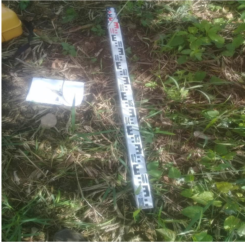
Figura 38. Estadal telescópico propiedad de la UCV – Tarapoto, empleado en el levantamiento topográfico de la vía de acceso al Centro Poblado Mamonaquihua.
