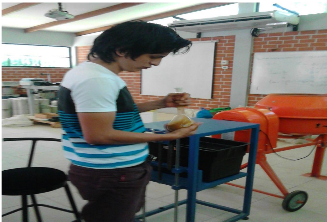
Figura 51. Fiola de 500cc para el ensayo de peso específico y absorción de la muestra extraída de las calicatas.
