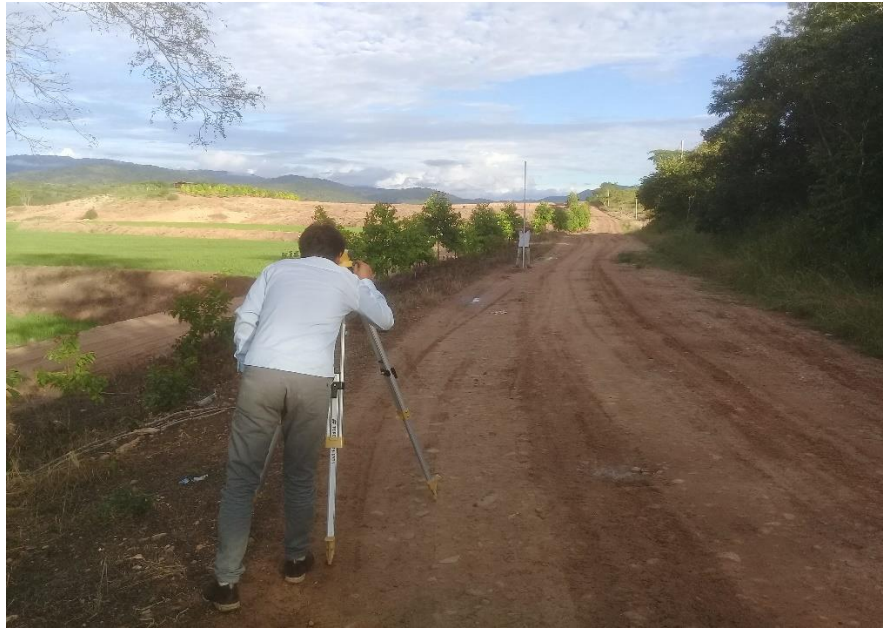
Figura 40. Levantamiento topográfico de la vía de acceso al Centro Poblado de Mamonaquihua.
