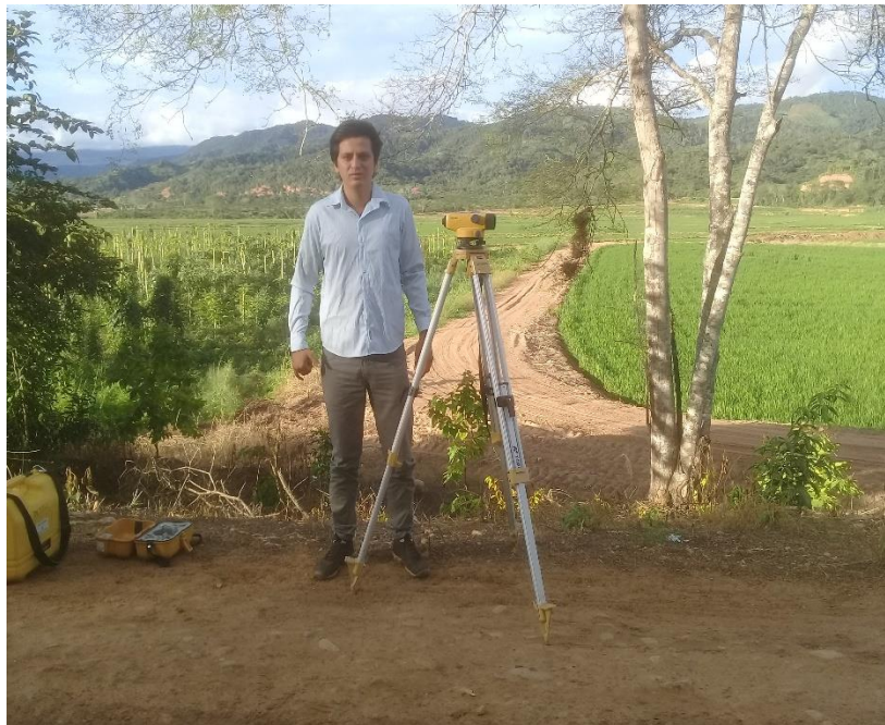
Figura 39. Estación correcta del nivel para el levantamiento topográfico de la vía de acceso al Centro Poblado de Mamonaquihua.
