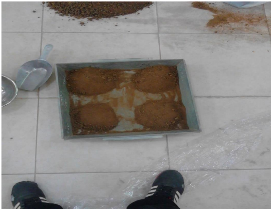
Figura 47. Técnica del cuarteo para la selección de las muestras tomadas de las calicatas de la vía de acceso al Centro Poblado Mamonaquihua.
