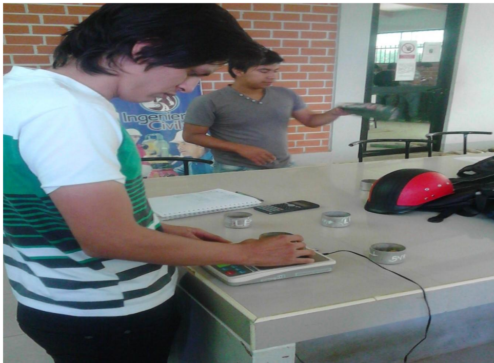
. Figura 49. Toma del peso de la muestra para la evaluación de la humedad natural.
