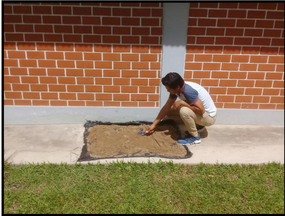
. Figura 48. Secado de las muestras extraídas de las calicatas al aire libre.
