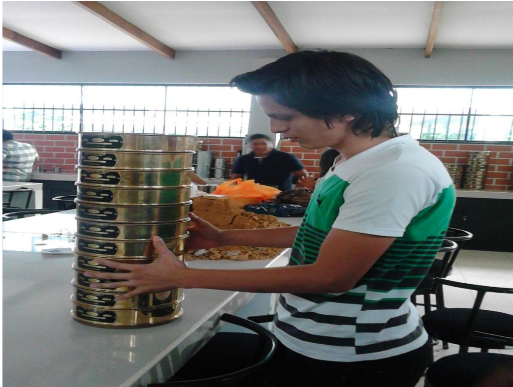
Figura 50. Tamizado manual de la muestra extraída de las calicatas.
