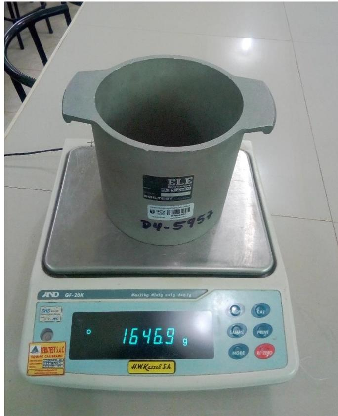
**Figura 37.** Toma de peso del recipiente para el análisis de peso unitario.
