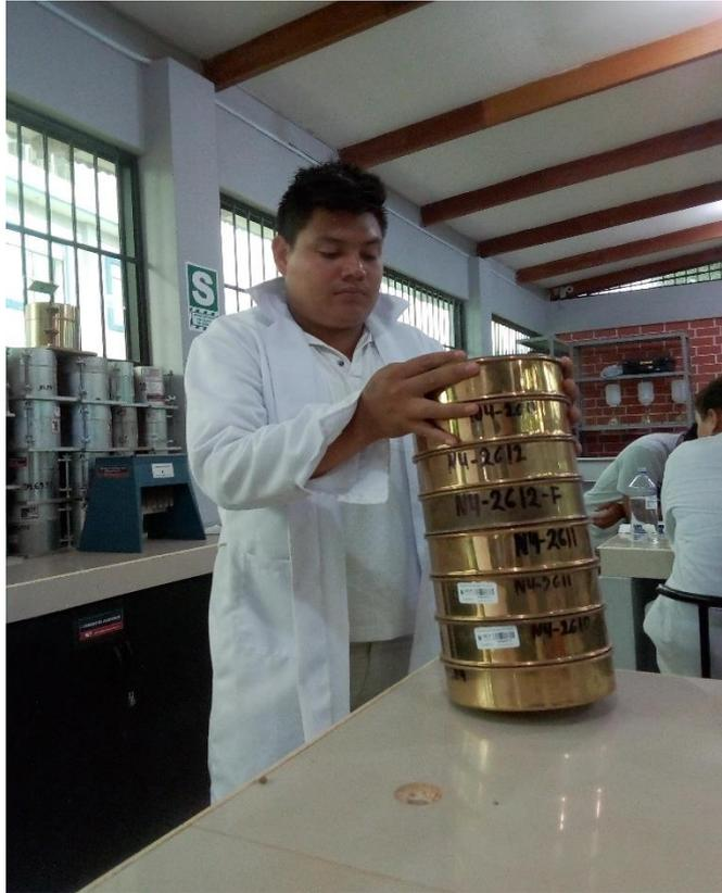
**Figura 35.** *Análisis granulométrico por tamizado del agregado fino.*
