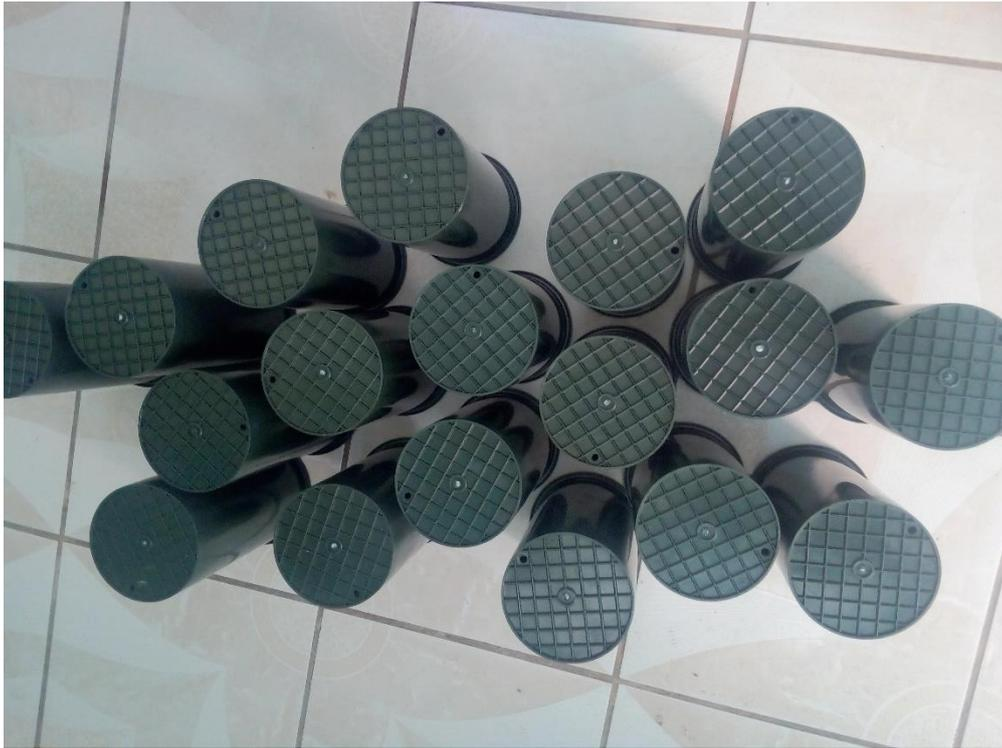
**Figura 43.** *Moldes cilíndricos para la fabricación de probetas.*
