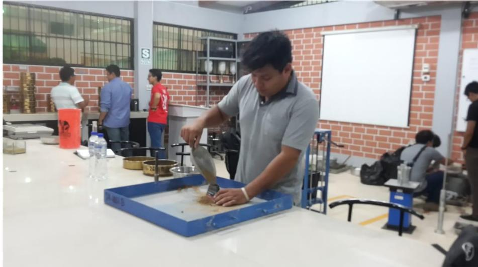
**Figura 41.** *Realizando el ensayo del cono de absorción de arena.*
