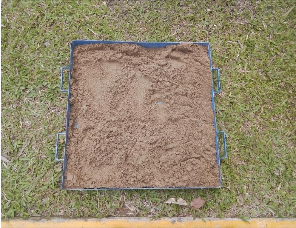
**Figura 31.** *Secado del agregado fino a temperatura ambiente.*
