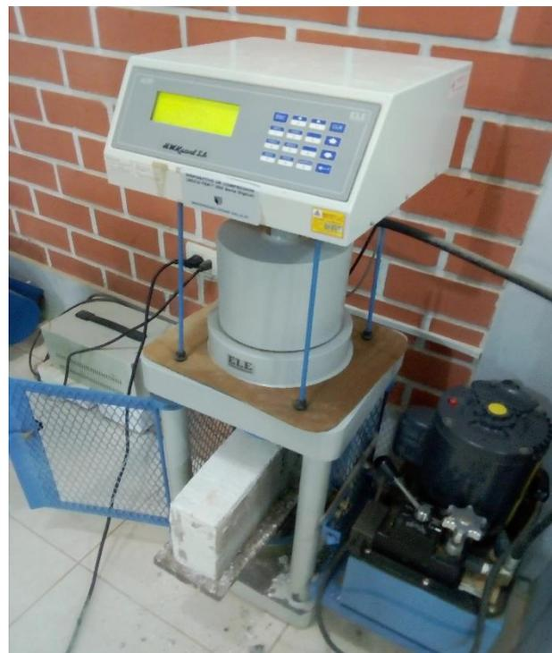
**Figura 60.** *Ensayo de resistencia a la compresión simple de los bloques.*
