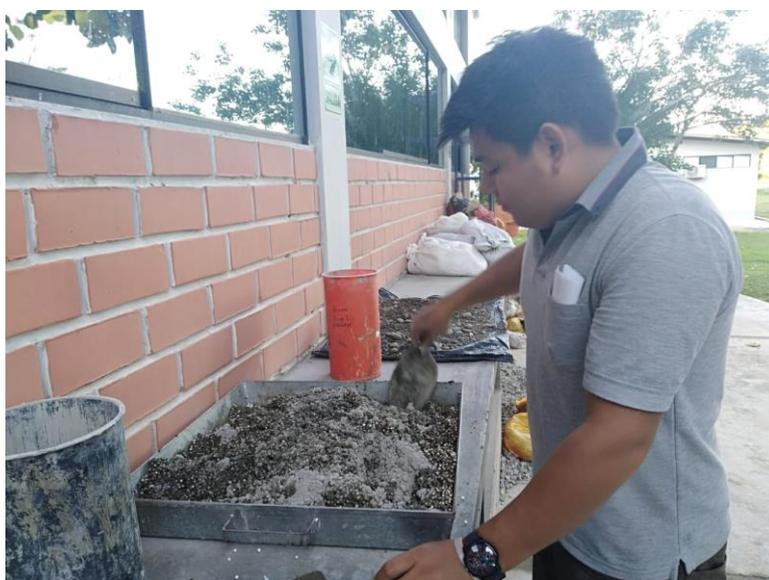
**Figura 20.** *Proceso de elaboración de la mezcla de concreto ligero óptimo cuya densidad de diseño es 1600 kg/m<sup>3</sup>.*
