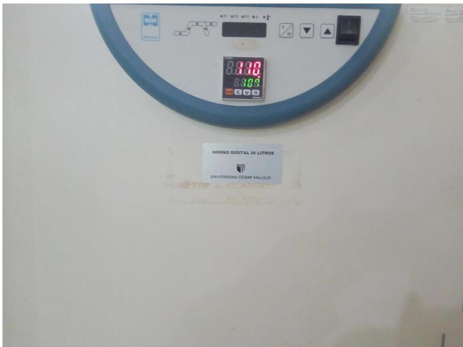
**Figura 34.** *Horno para el secado de la muestra de agregado fino a 110 °C.*
