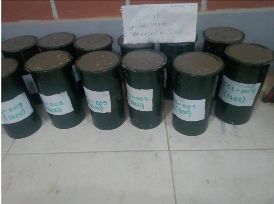
**Figura 49.** *Moldes cilíndricos llenos de concreto ligero.*
