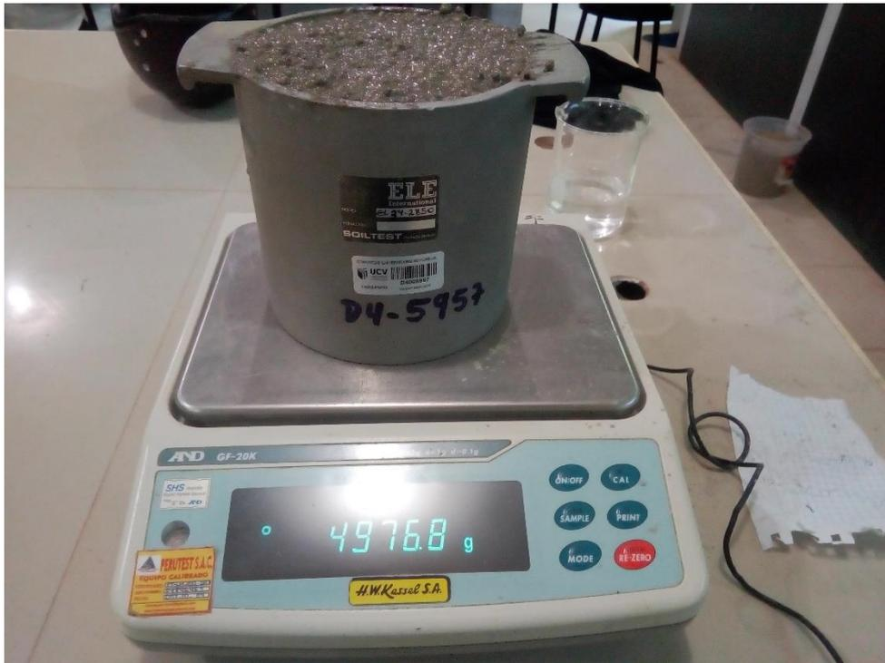
**Figura 47.** *Ensayo de peso específico de la mezcla de concreto ligero fresco.*
