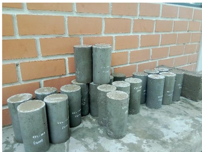
**Figura 13.** *Especímenes cilíndricos para ensayos en concreto ligero.*
