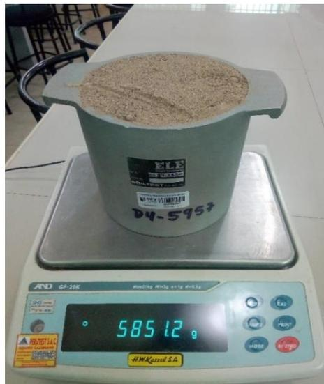
**Figura 8.** *Peso de la muestra de agregado fino para el ensayo de peso unitario suelto.*
