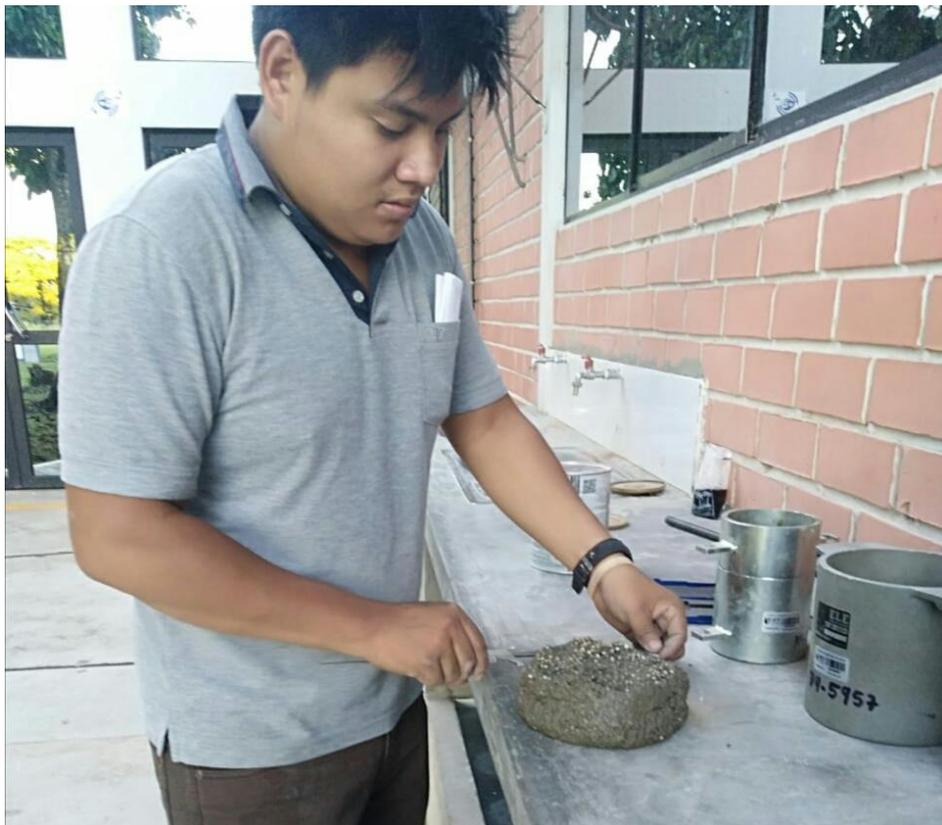
**Figura 46.** Ensayo de fluidez de la mezcla de concreto ligero.
