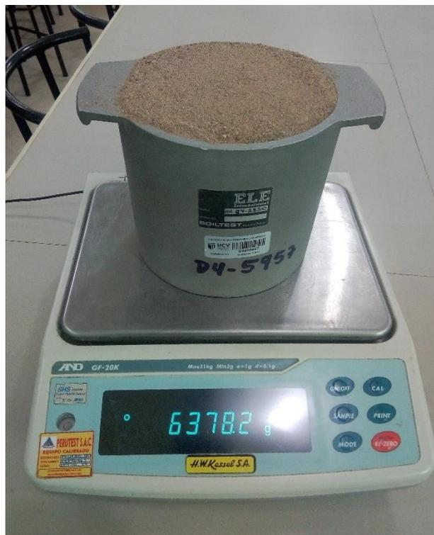
**Figura 40.** *Peso unitario compactado del agregado fino.*
