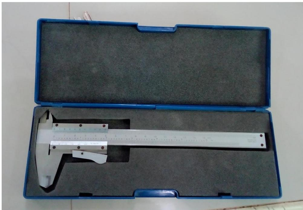
**Figura 38.** Calibrador Bernie para la toma de medidas exactas.
