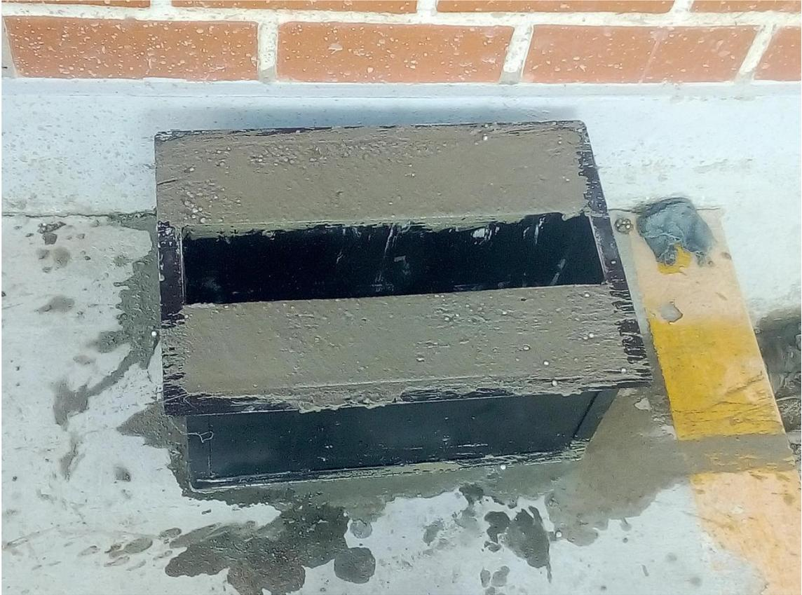
**Figura 57.** *Fabricación de los bloques de concreto ligero.*
