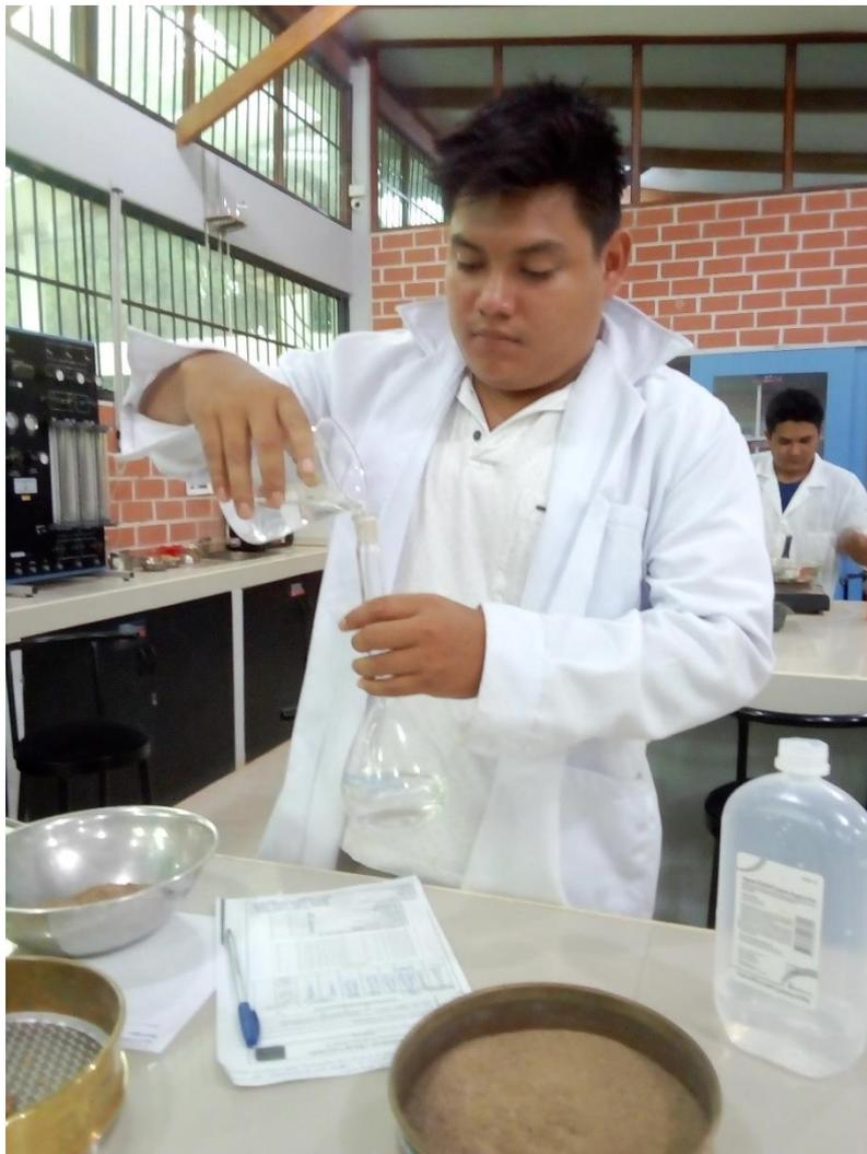
**Figura 42.** *Ensayo de peso específico y absorción.*
