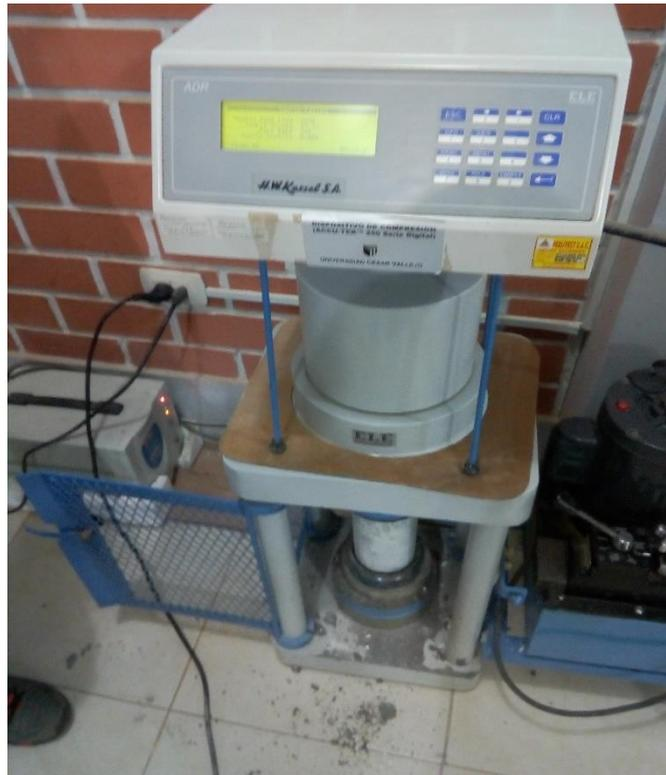
**Figura 53.** Ensayo de resistencia a la compresión simple de las probetas.
