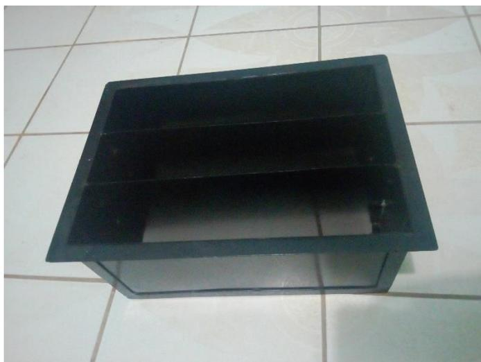
**Figura 21.** *Molde para la fabricación de bloques de concreto ligero.*
