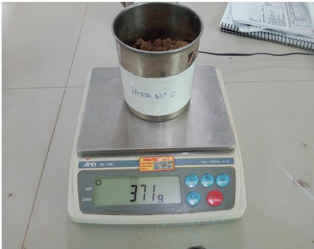
**Figura 32.** *Toma de muestra para el análisis de humedad natural del agregado.*
