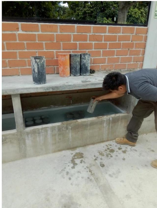
**Figura 50.** *Curado de los especímenes cilíndricos de concreto ligero.*
