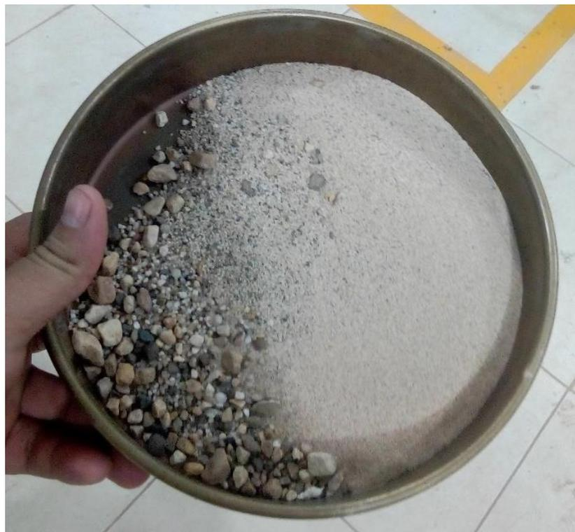
**Figura 2.** *Forma y textura del agregado fino empleado en el diseño.*
