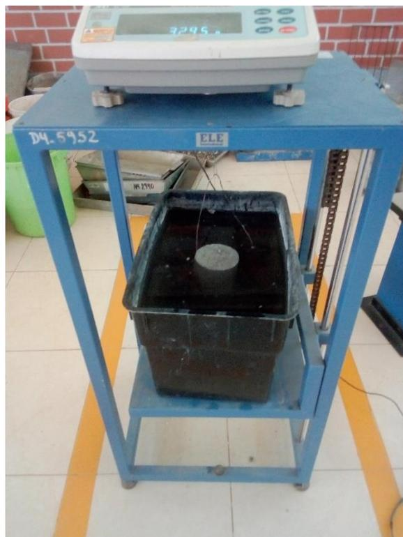
**Figura 54.** Ensayo de peso específico y absorción de las probetas.
