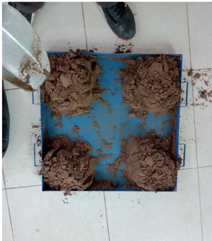
**Figura 30.** *Método del cuarteo para la toma de muestra del agregado fino.*
