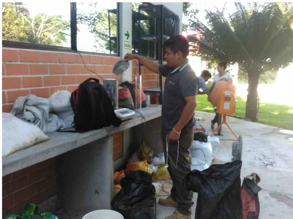
**Figura 55.** Toma de peso de materiales para la mezcla de concreto ligero.
