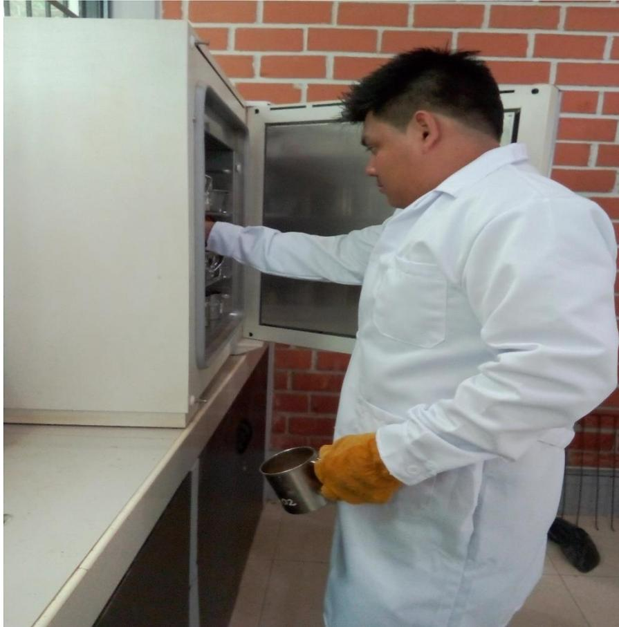
**Figura 33.** *Extracción de la muestra de agregado fino del horno luego de 24h.*
