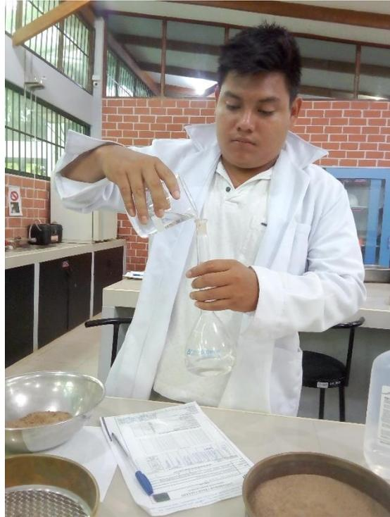
**Figura 6.** *Proceso de obtención del peso específico y la absorción del agregado fino.*
