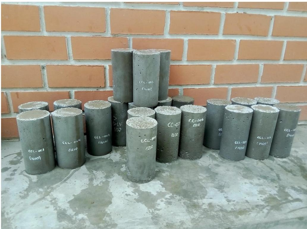
**Figura 52.** Especímenes cilíndricos de concreto ligero para pruebas.
