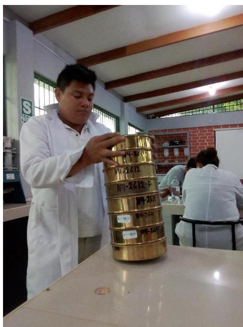
**Figura 5.** *Proceso de tamizado para la obtención del material más fino.*
