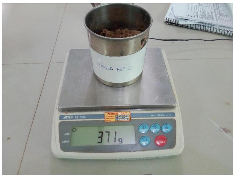
**Figura 7.** *Peso de muestra de agregado fino en estado natural.*
