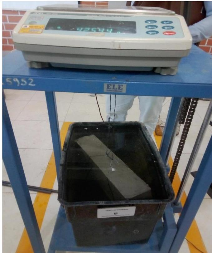
**Figura 59.** *Ensayo de peso específico y absorción del bloque de concreto.*
