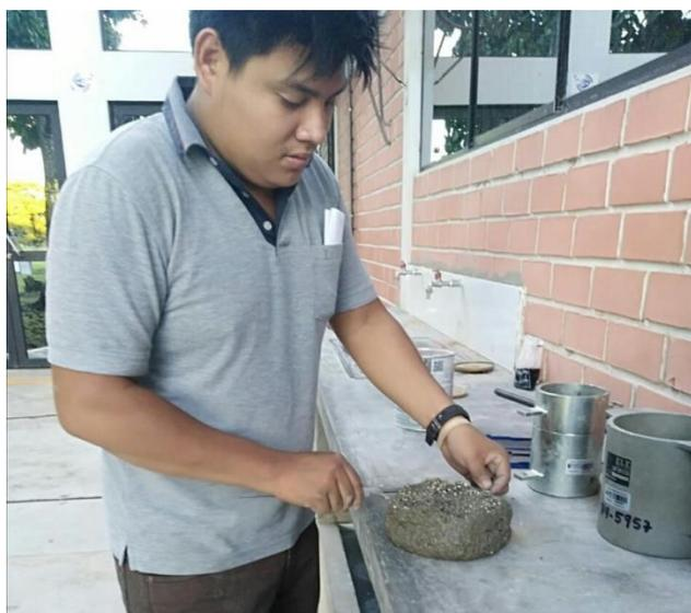
**Figura 14.** Toma de resultados del diámetro de dispersión del concreto ligero.
