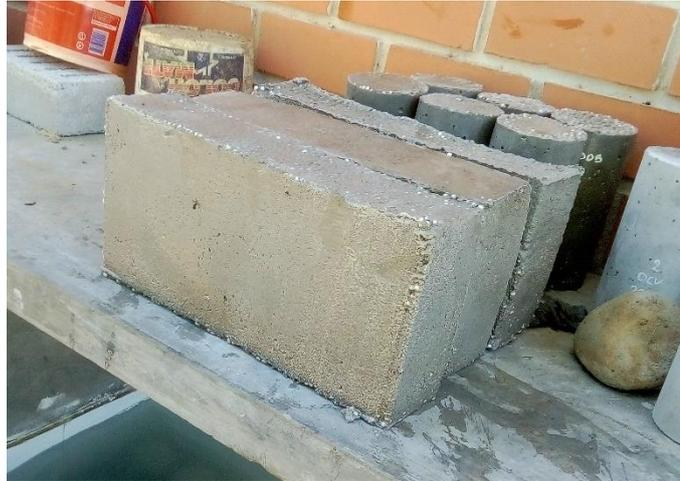
**Figura 22.** *Bloque de concreto ligero con la aplicación de perlas de poliestireno.*
