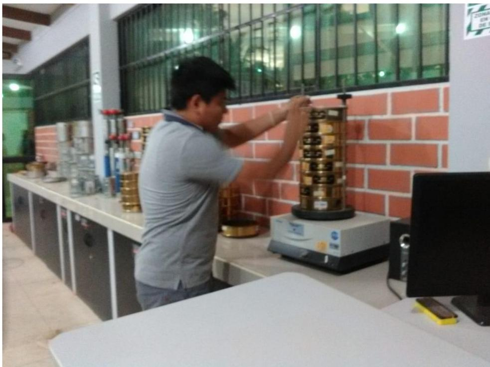
**Figura 36.** *Empleo del tamizador portátil electrónico.*
