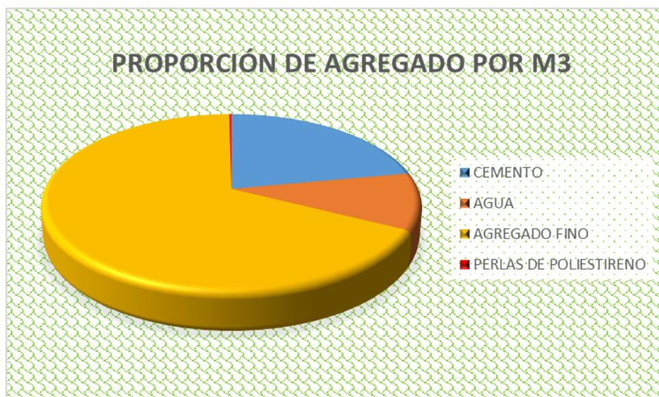
**Figura 12.** *Proporción de material por m<sup>3</sup> de concreto ligero.*
