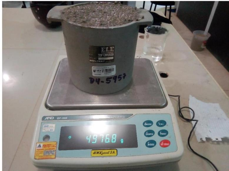
**Figura 15.** *Peso de la masa, para el cálculo del peso específico, densidad teórica y contenido de aire.*
