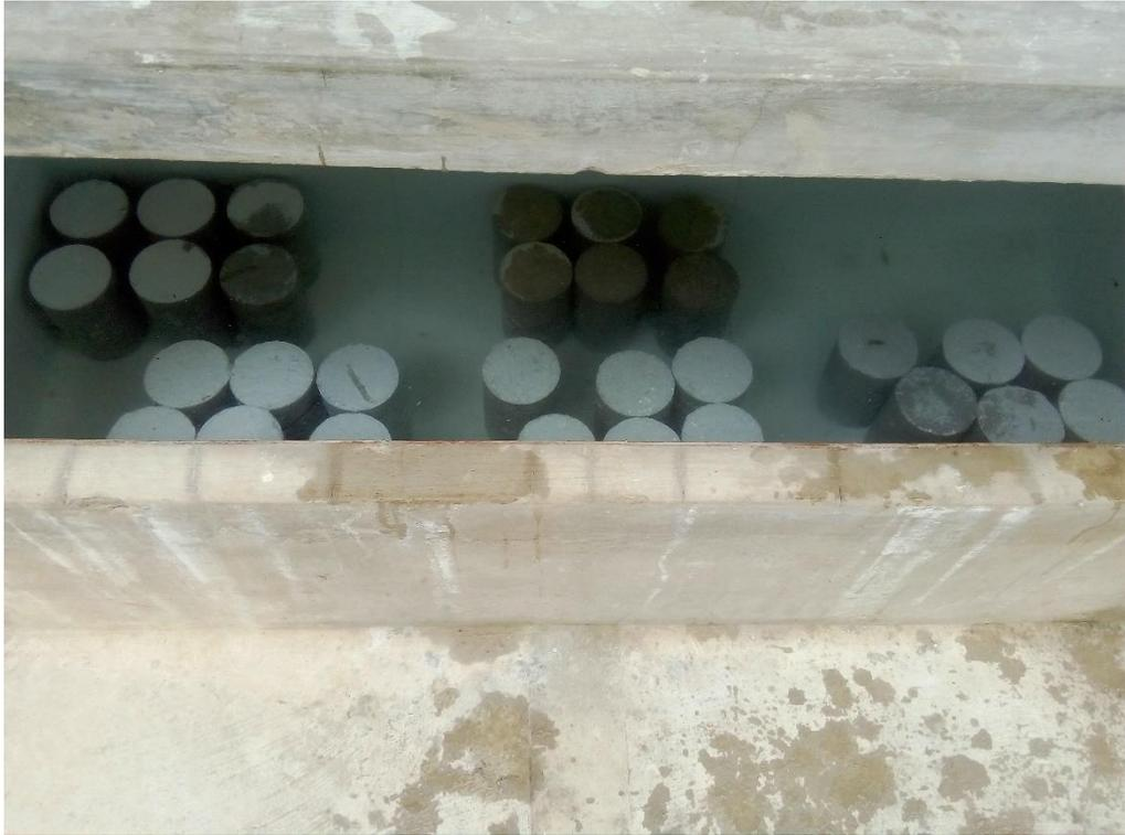
**Figura 51.** Curado de los especímenes cilíndricos de concreto ligero.
