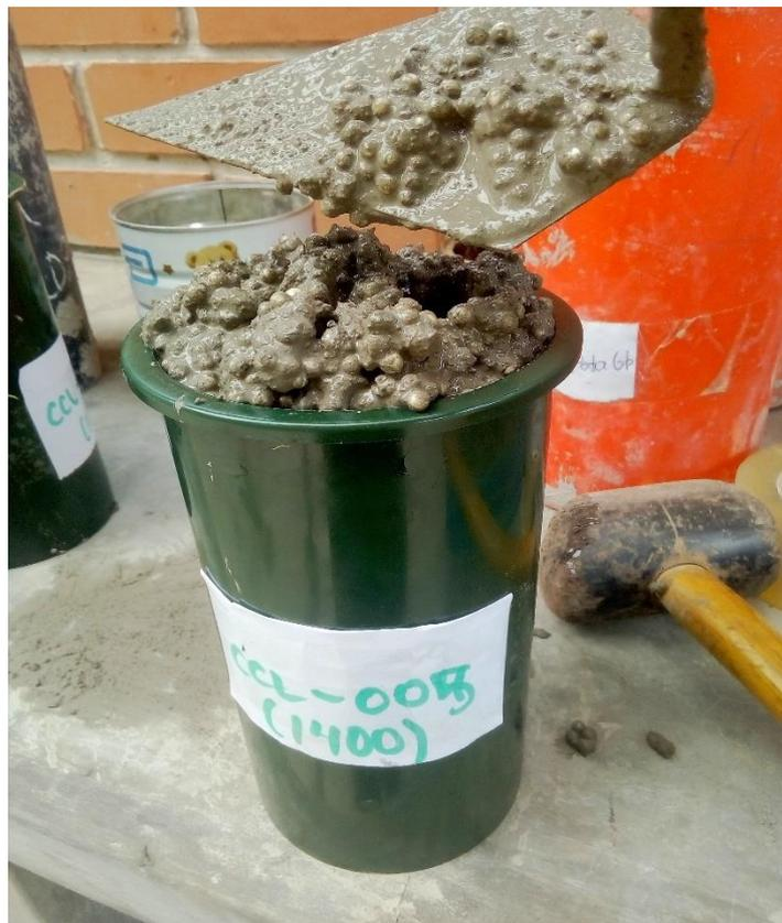
**Figura 48.** *Vertido la mezcla de concreto ligero en los moldes cilíndricos.*
