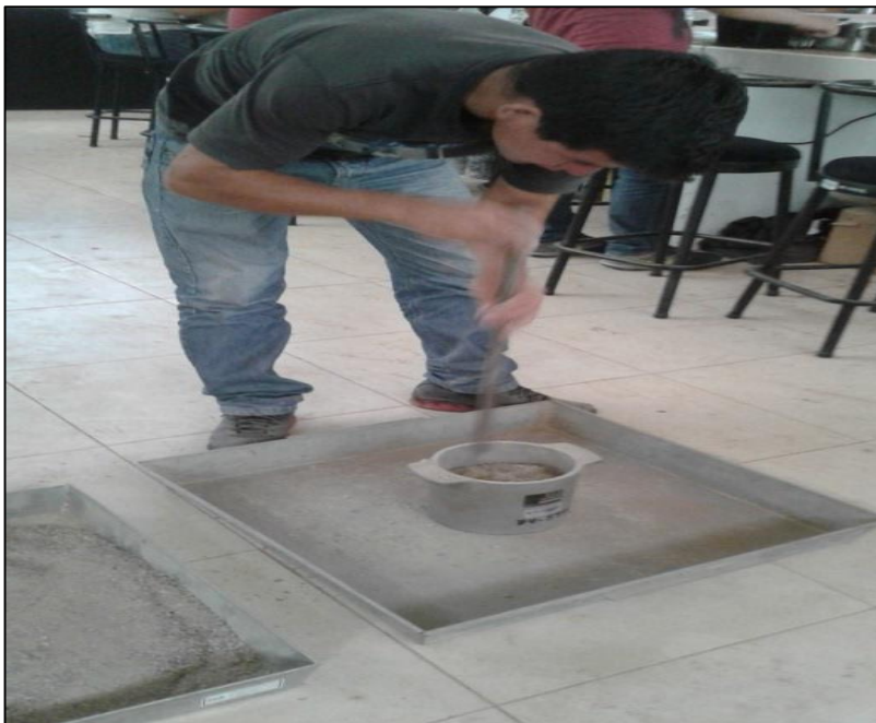
Fotografía 8. Proceso del peso unitario suelto Varillado o Compactado
