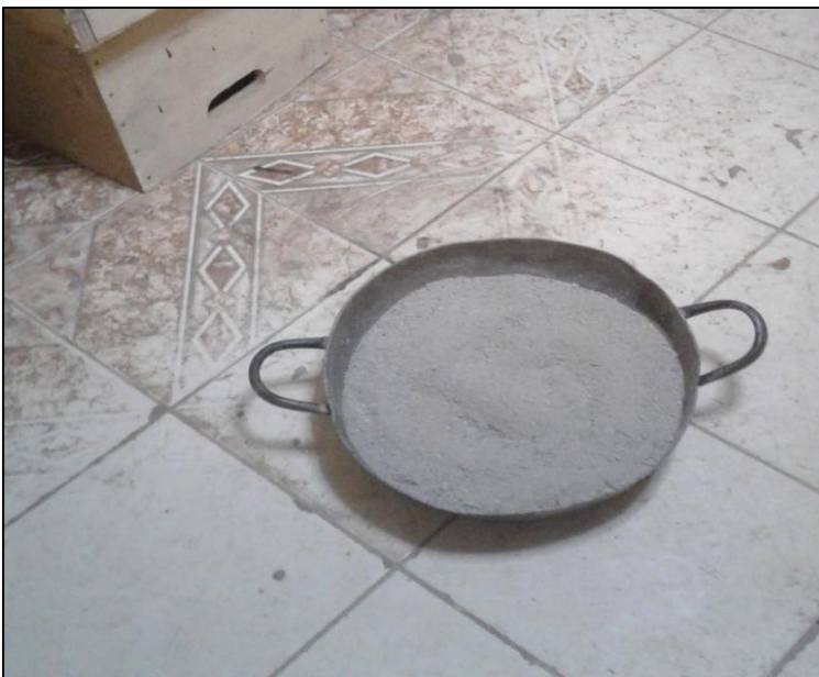
Fotografía 12. Agregado fino listo para ser mezclado con la emulsión asfáltica lenta
