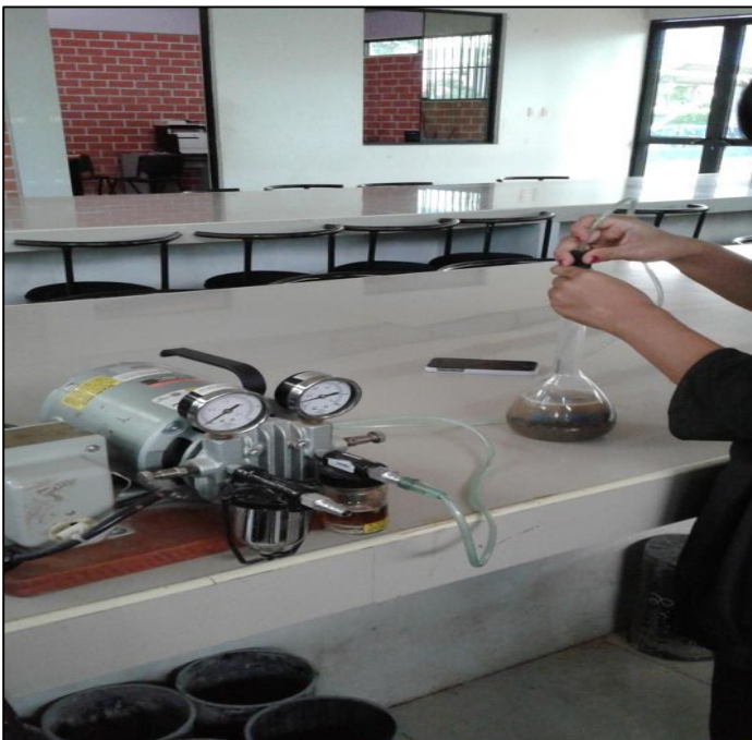
Fotografía 10. Sacando los espacios vacios del agregado con la bomba de aire
