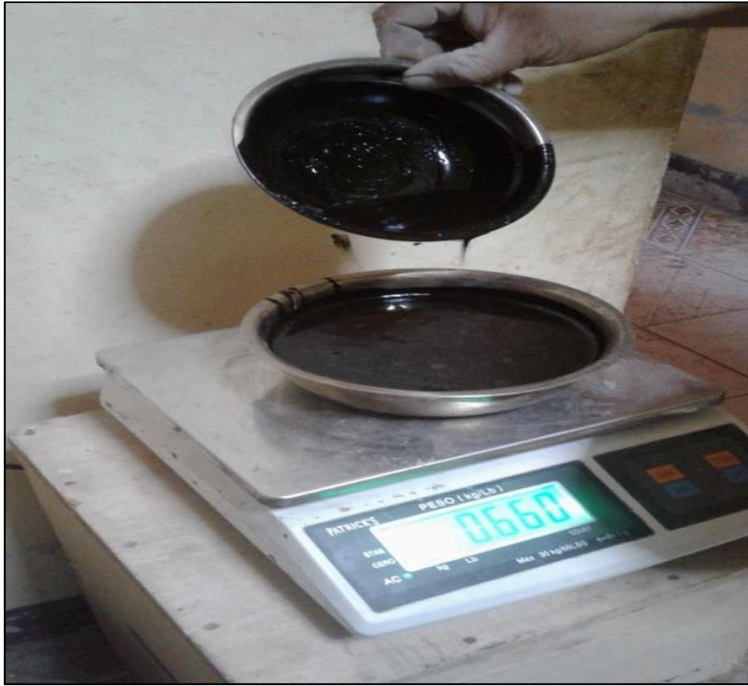
Fotografía 11. Pesado de la emulsión asfáltica lenta
