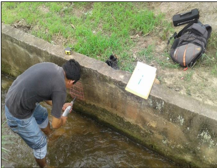
Fotografía 20. Aplicación del ensayo de esclerómetro
