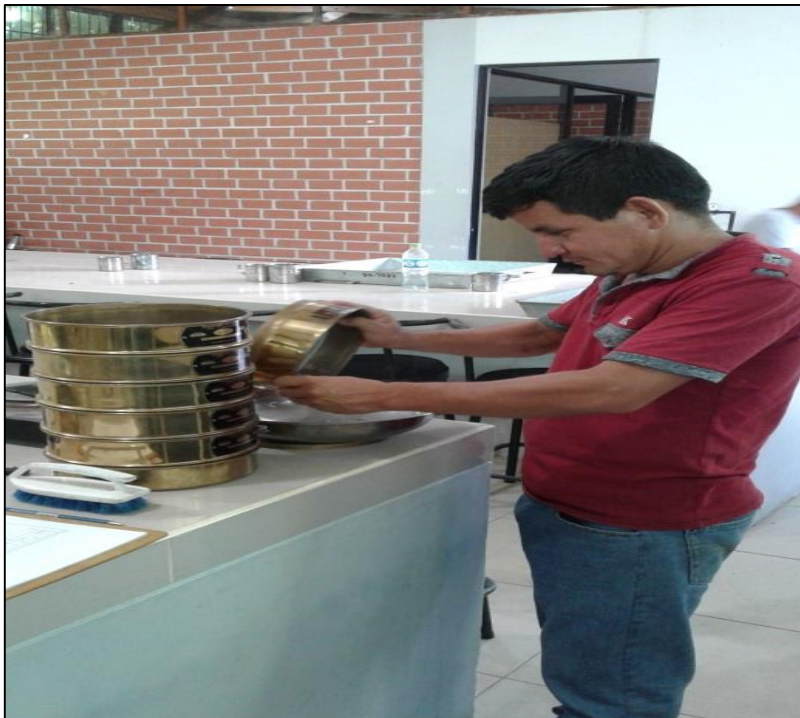
Fotografía 6. Pesado de la muestra retenida en cada uno de los tamices
