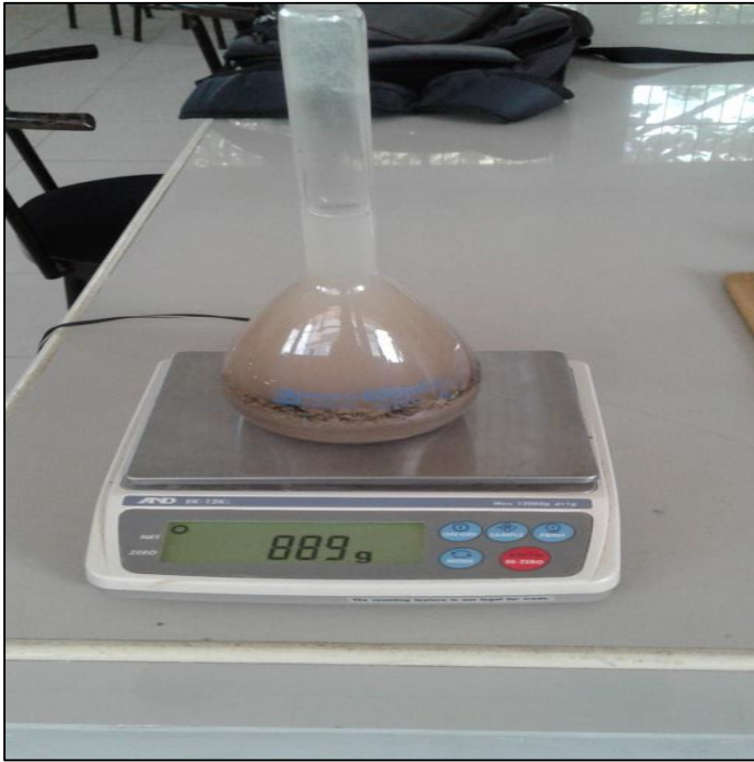
Fotografía 9. Peso de la Fiola con agua + agregado
