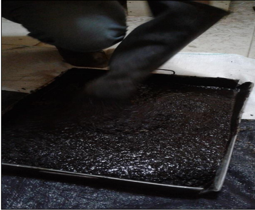
Fotografía 13. Diseño mezclado en su totalidad, comenzando con su estado de rotura que esta dado en un periodo de 120 min
