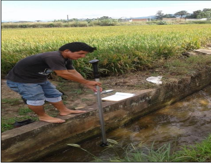
Fotografía 19. Aplicación del correntómetro en campo para tomar las velocidades respectivas
