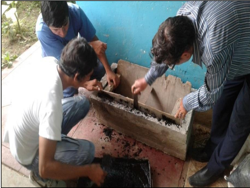
Fotografía 17. Chuseo del baseado del diseño de revestimiento modificado con emulsión asfáltica
