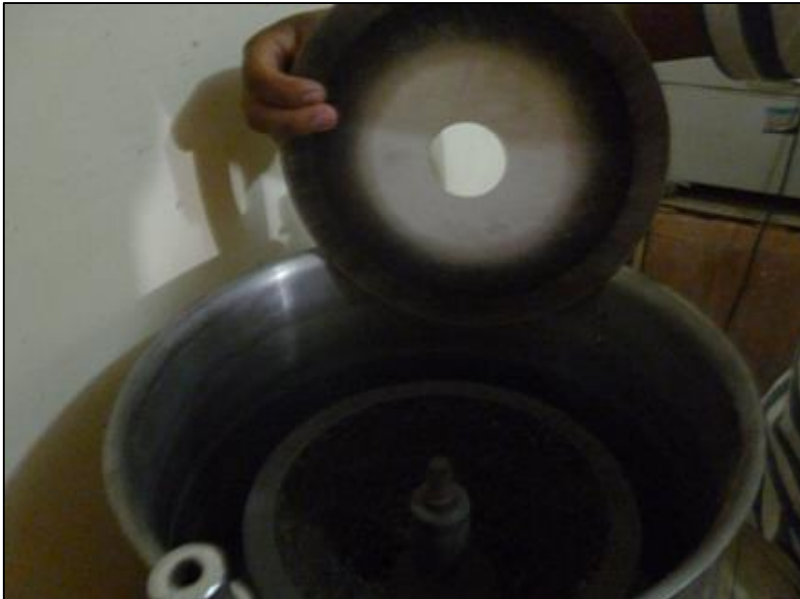
Fotografía 16. Realizando el lavado del material de diseño con emulsión asfáltica lenta (Slurry Seal)
