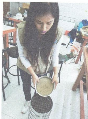
En la imagen se aprecia la realización del tamizado el cual tomara entre unos 10 a 15 minutos
