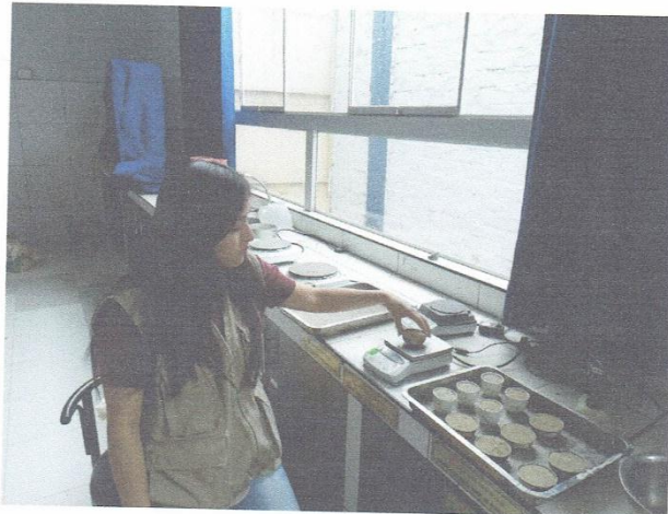
En la imagen se aprecia el pesado de las taras y el pesado de la tara más la muestra para la obtención del contenido de humedad
