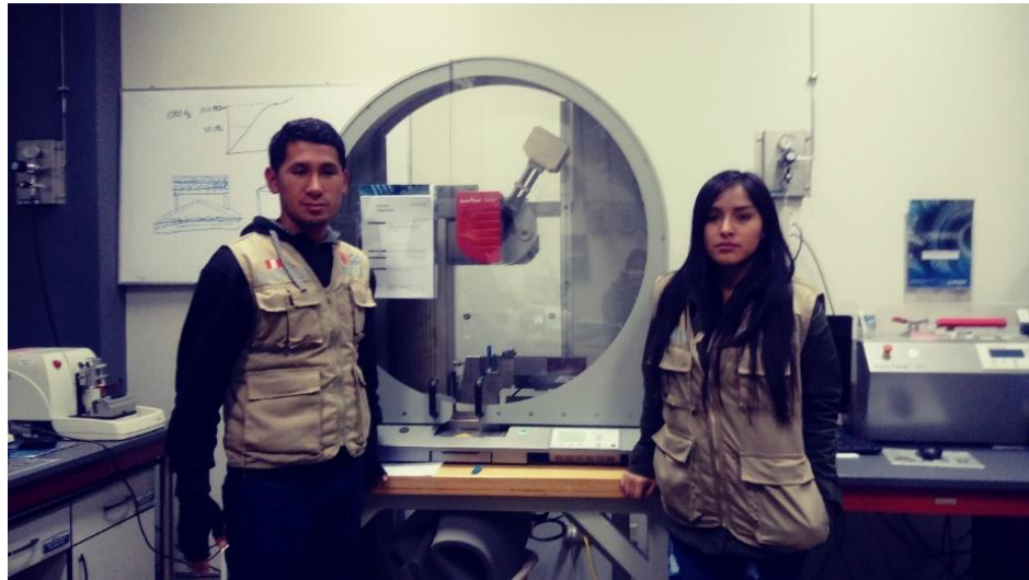
Fotografía N° 09: Se puede apreciar la máquina donde las tuberías fueron ensayadas para determinar la resistencia al impacto.
