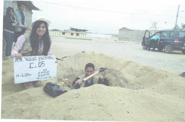
En la imagen se aprecia la toma de muestra aproximadamente 30 kg para realizar los ensayos correspondientes.
