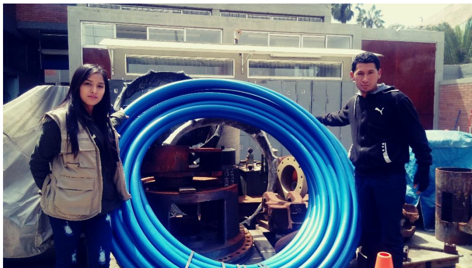
Fotografía N° 10: La tubería de polietileno de alta densidad que fue sometida a los ensayos de resistencia a la tracción y ensayos de resistencia al impacto.
