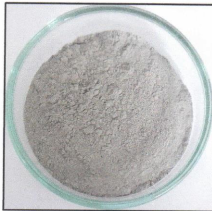
Figura N°2. Fotografía de la muestra de ceniza de carbón.
