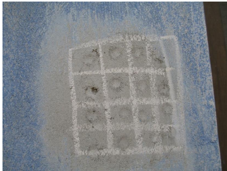
IMAGEN N° - 43: En esta imagen , se observa el patrón previo trazado para la próxima examinación de rebotes de la muestra.
