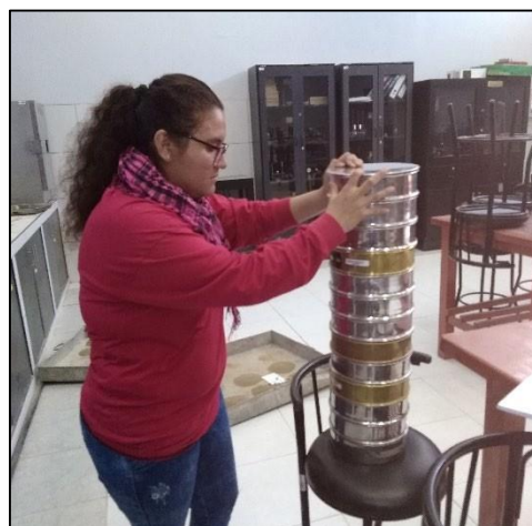
IMAGEN N° - 9: Ensayo Granulométrico
