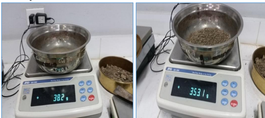
Figura 13: Procedimiento de Ensayo Contenido de Humedad
