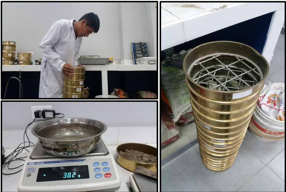
Figura 12: Procedimiento de Ensayo Granulométrico
