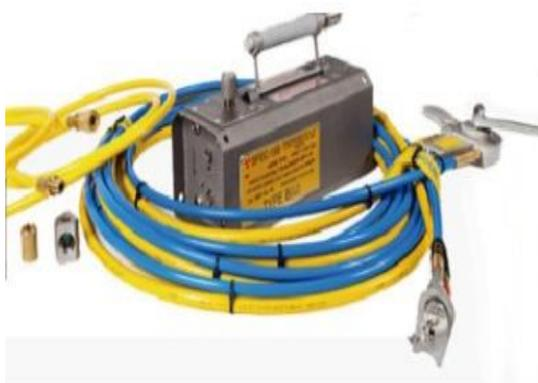
Figura 16. Equipo de gammagrafía industrial
