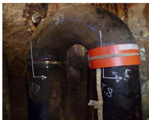
Figura 17. Trabajos de gammagrafía industrial
