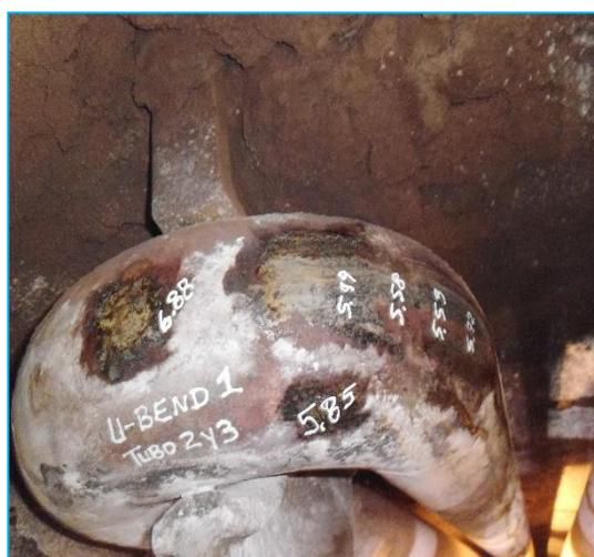
**Figura 13.** Trabajos de medición de espesores.
