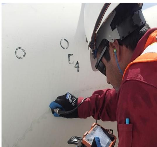
**Figura 12.** Trabajos de medición de espesores.
