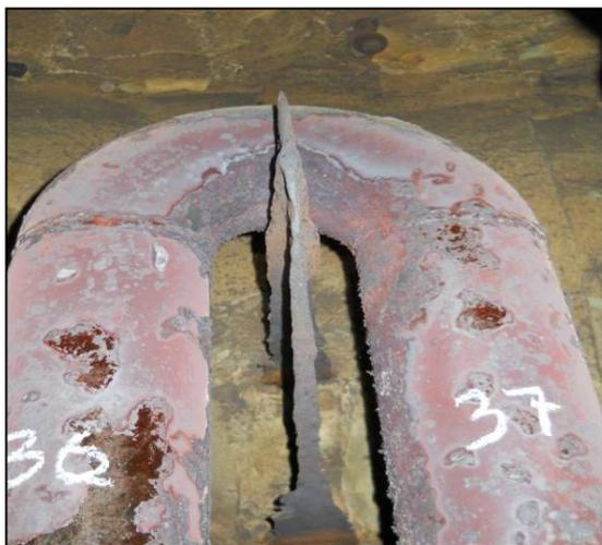
**Figura 10.** Soporte de tubo desgastado
