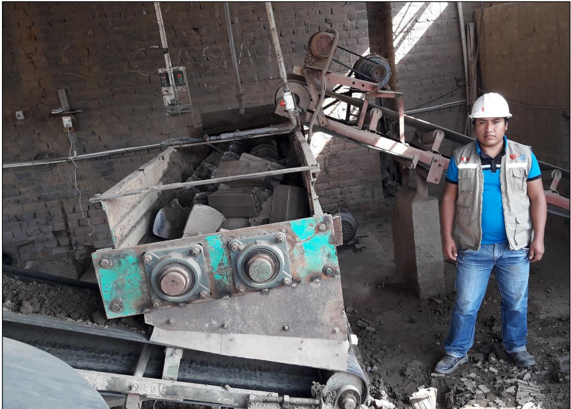
Figura 83. Proceso de mezclado de la arena, la arcilla y el agua.
