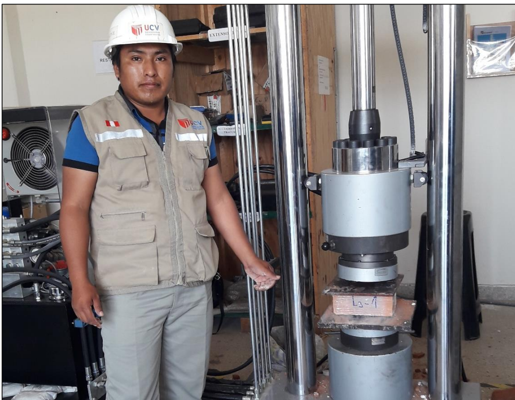
Figura 22. Ensayo de resistencia a la compresión en unidad de la ladrillera 3.
