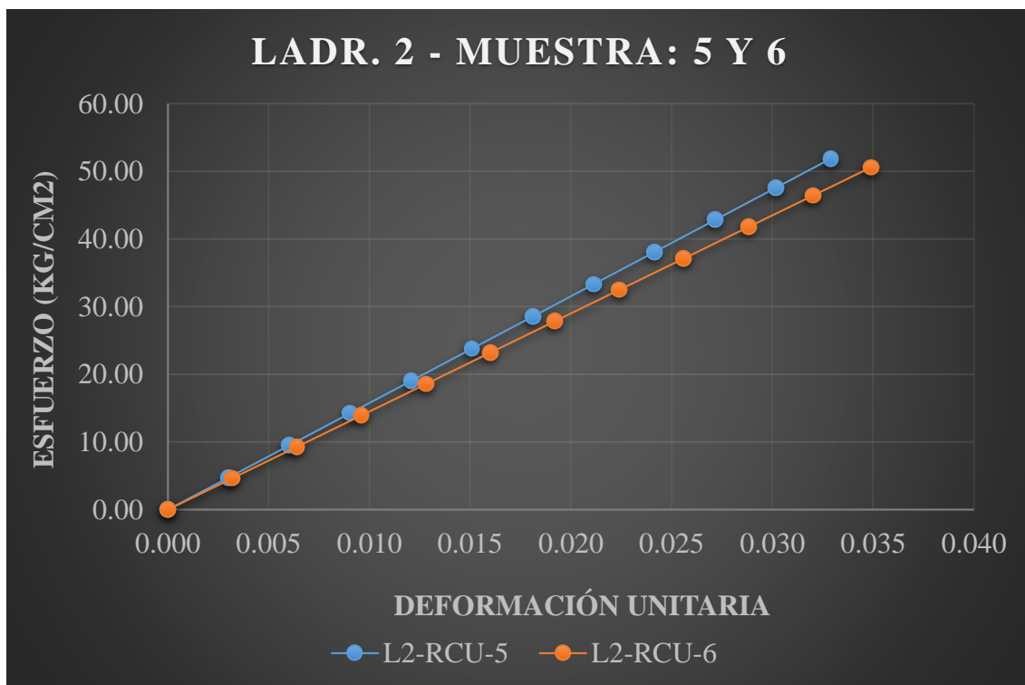
Figura 33. Esfuerzo vs deformación en unidad de la ladrillera 2 – artesanal.
