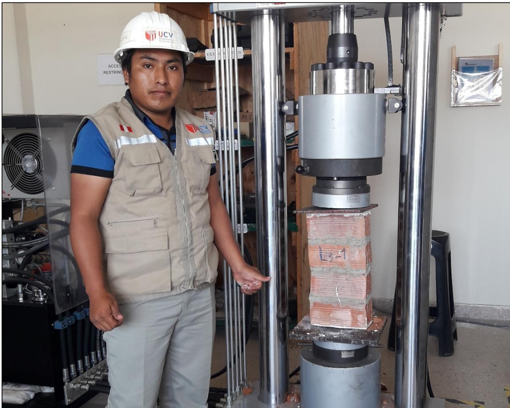
Figura 28. Ensayo de resistencia a la compresión en pila de la ladrillera 3.
