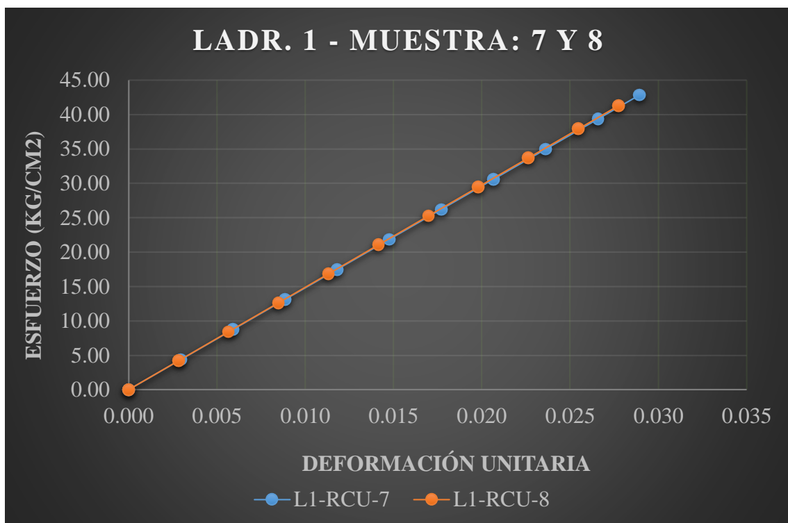
Figura 29. Esfuerzo vs deformación en unidad de la ladrillera 1 – artesanal.
