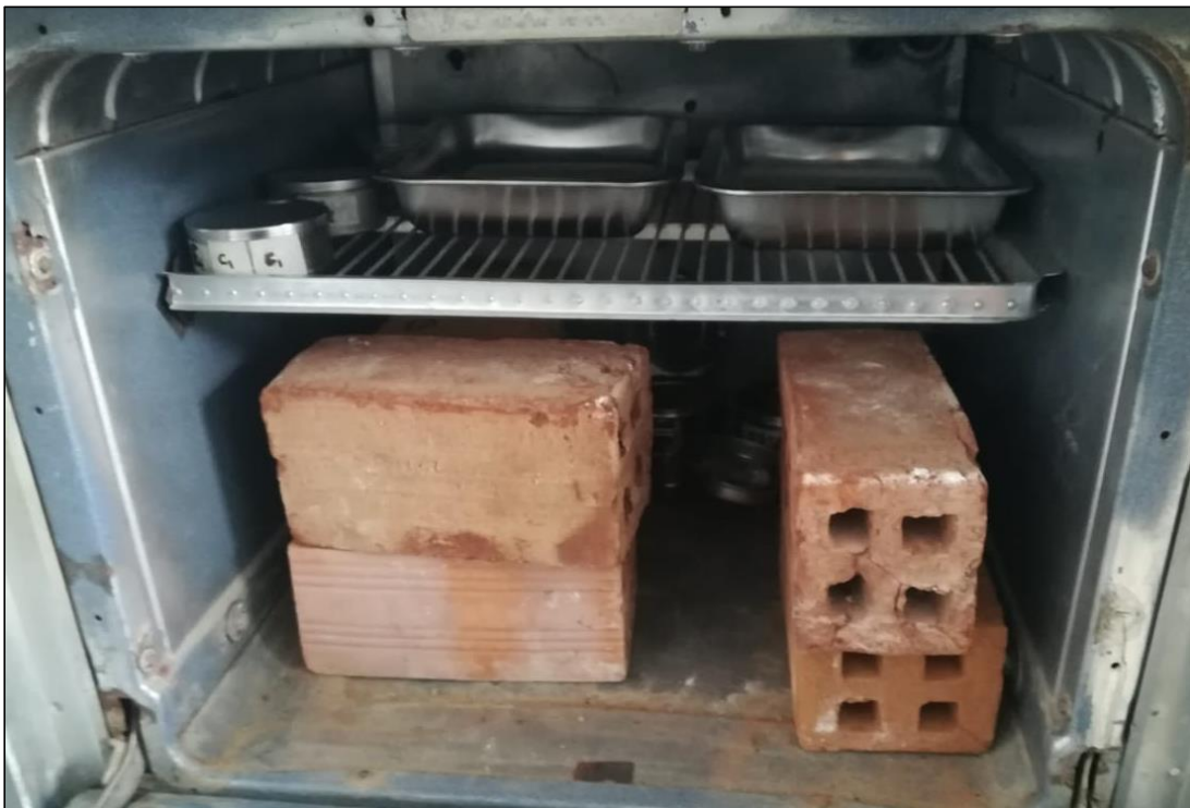
Figura 16. Secado de las unidades de albañilería.
