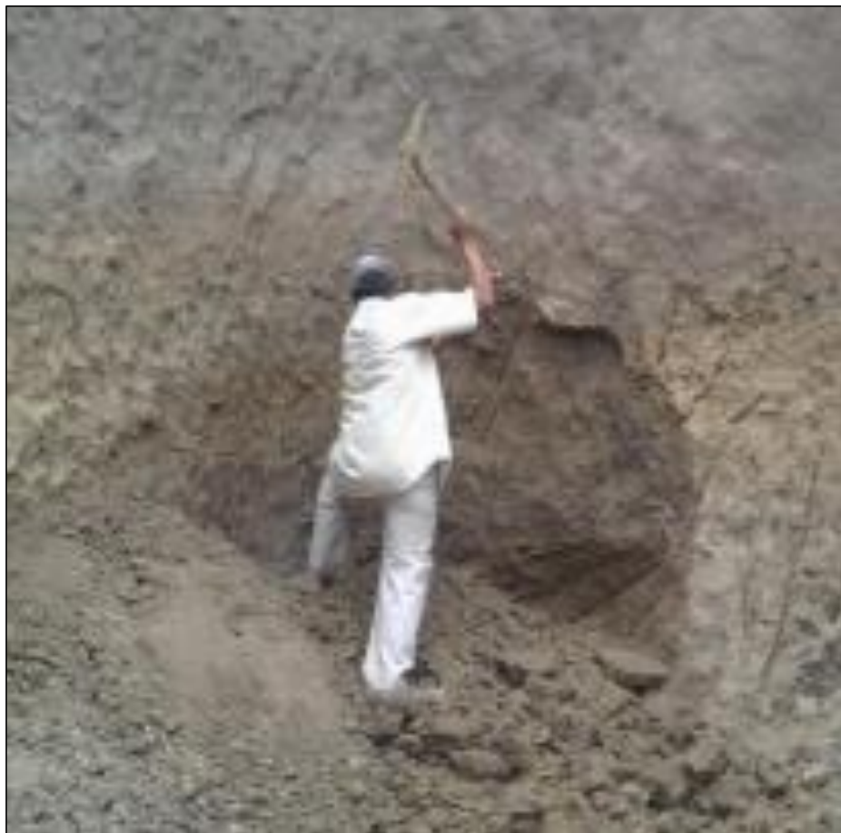
Figura 77. Extracción manual de la arcilla y la arena.
