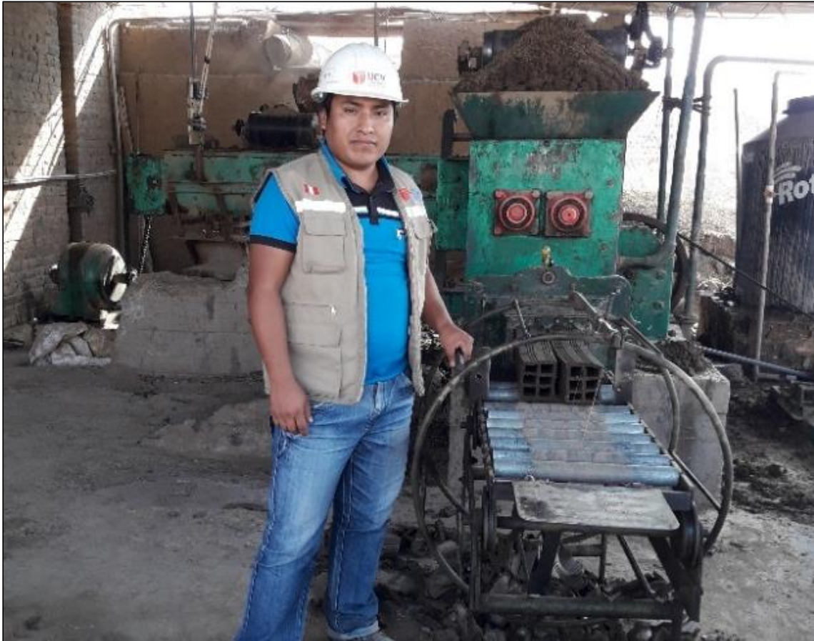
Figura 9. Moldeo y corte final del ladrillo maquinado.
