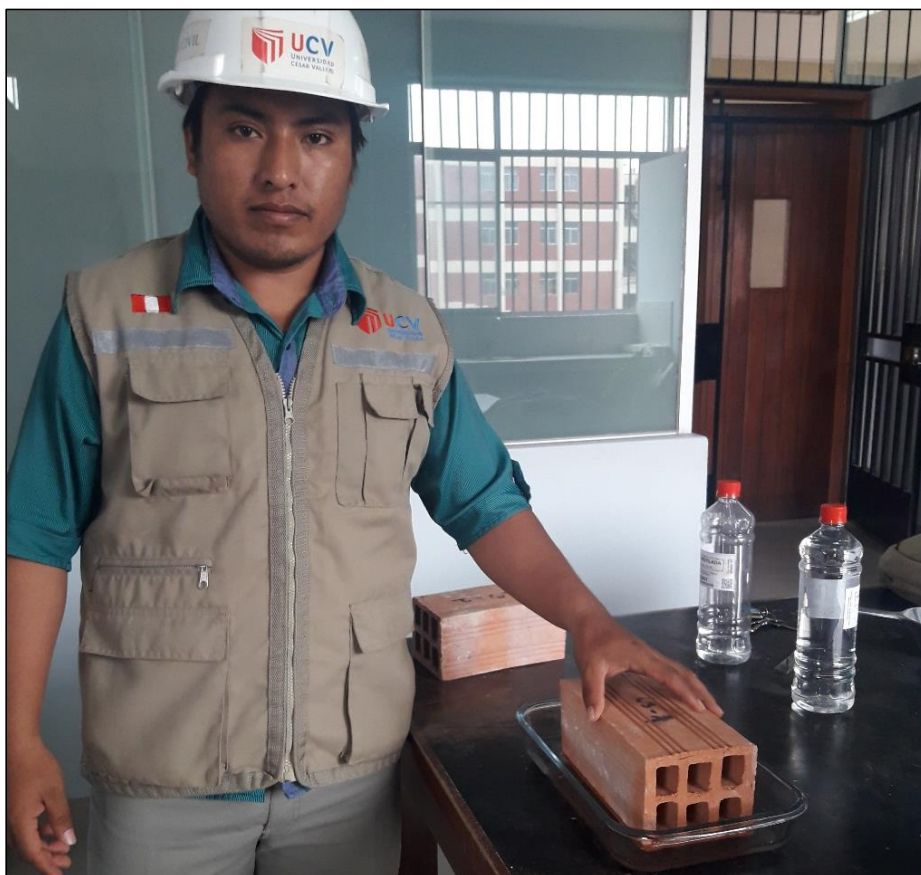
Figura 18. Ensayo de succión, ladrillera 3.
