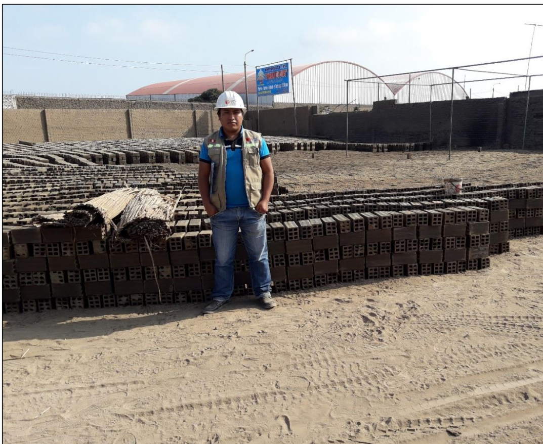
Figura 87. Secado y filado del ladrillo.
