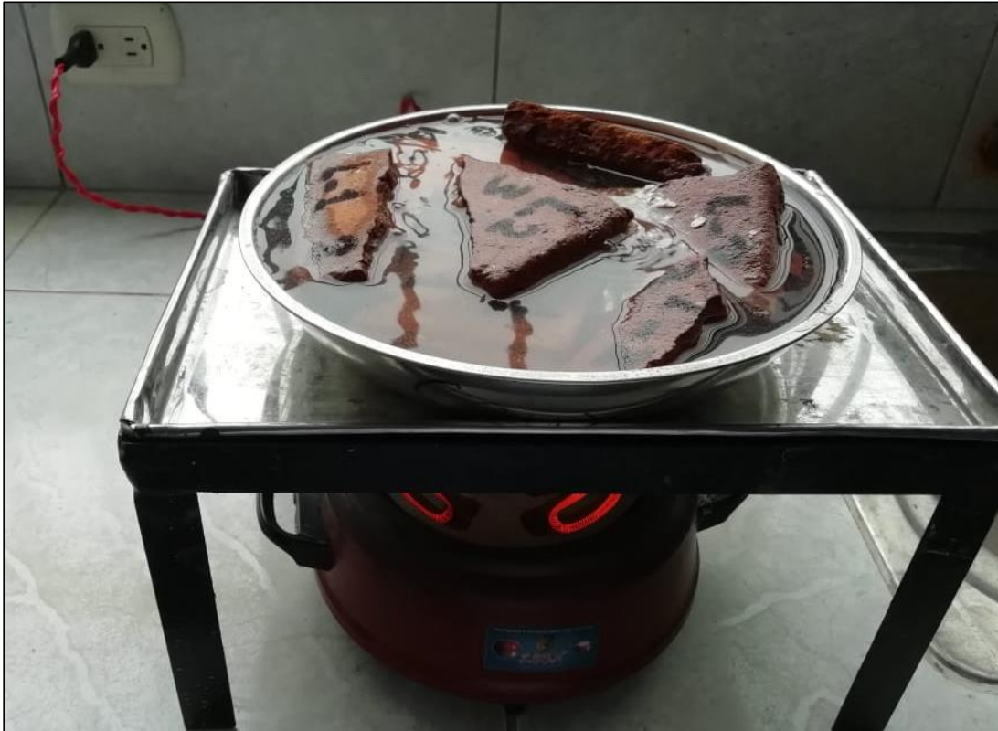
Figura 15. Hervido de las unidades de albañilería para la absorción máxima.
