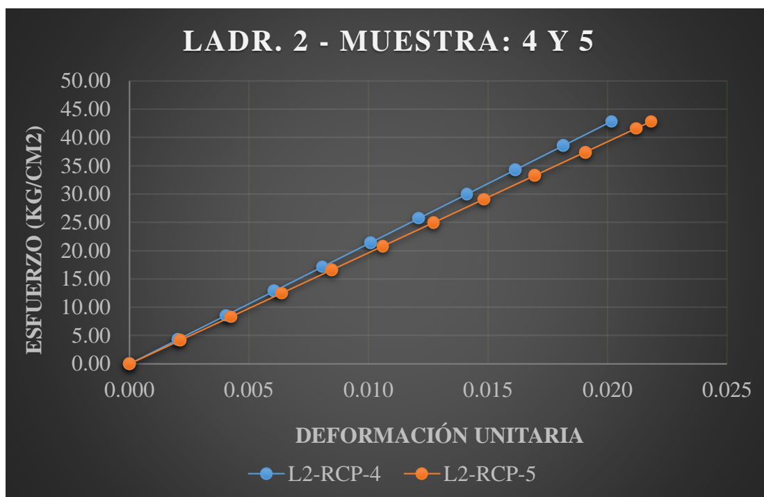
Figura 44. Esfuerzo vs deformación en pila de la ladrillera 2 – artesanal.
