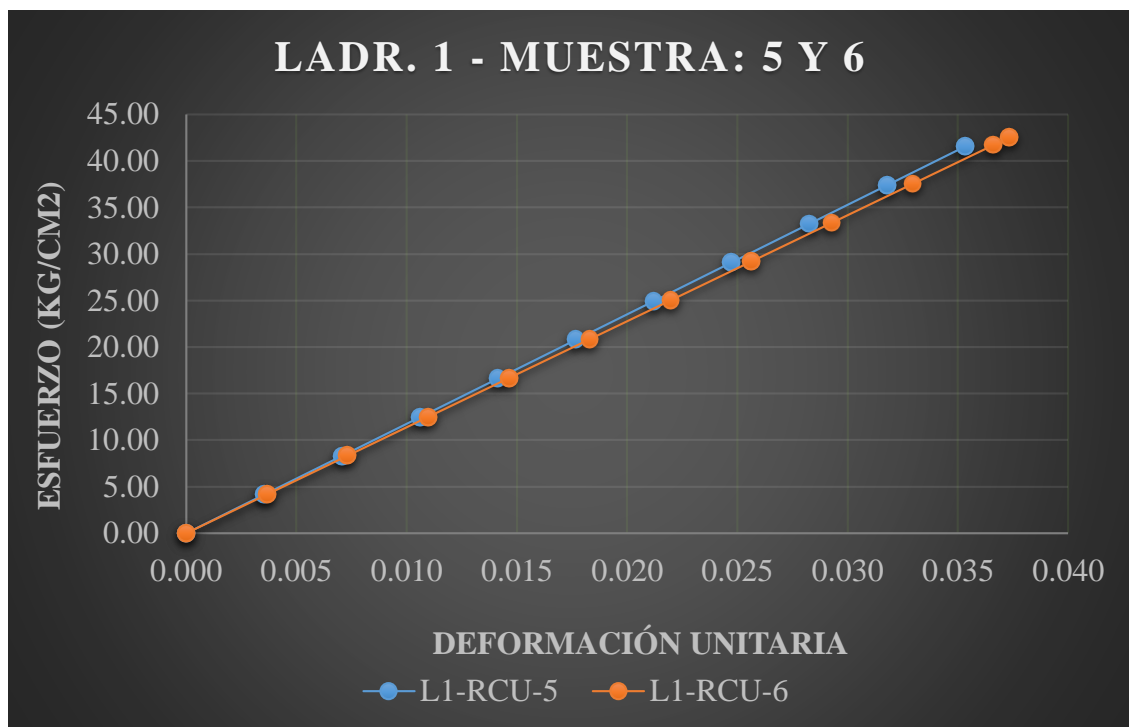
Figura 28. Esfuerzo vs deformación en unidad de la ladrillera 1 – artesanal.
