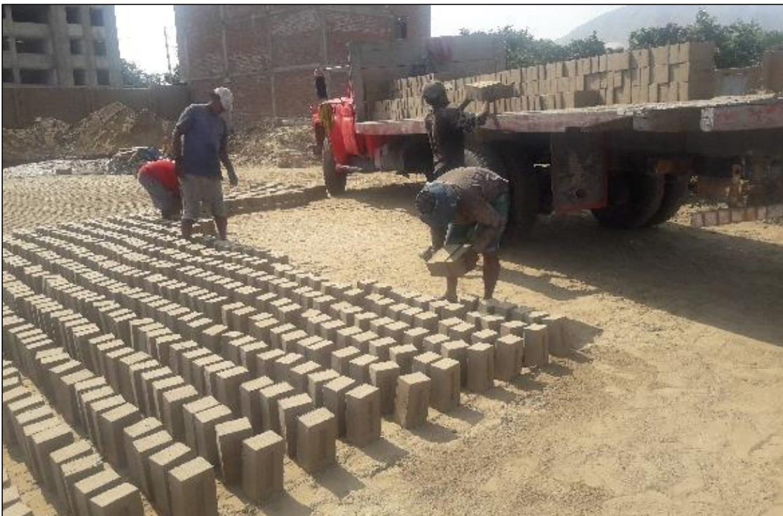
Figura 4. Traslado del ladrillo artesanal al horno.
