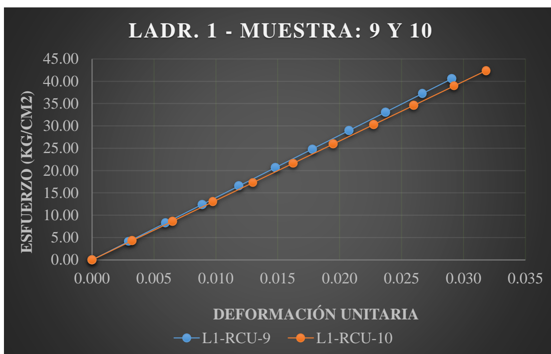
Figura 30. Esfuerzo vs deformación en unidad de la ladrillera 1 – artesanal.
