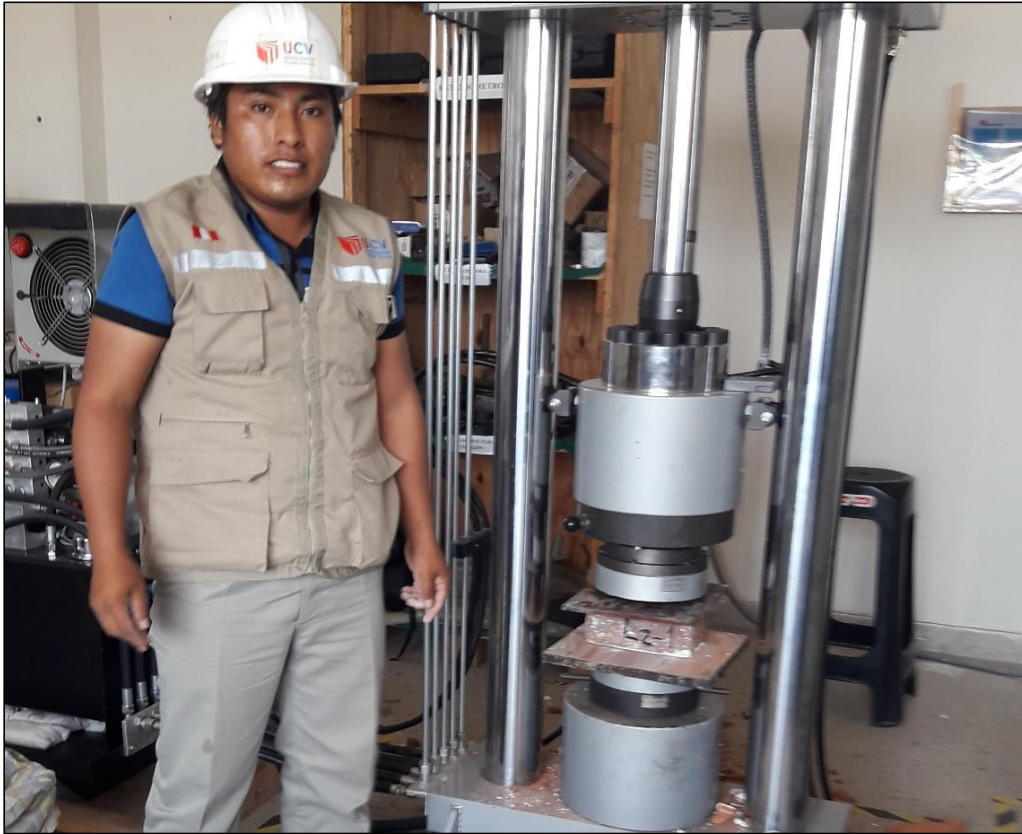
Figura 21. Ensayo de resistencia a la compresión en unidad de la ladrillera 2.
