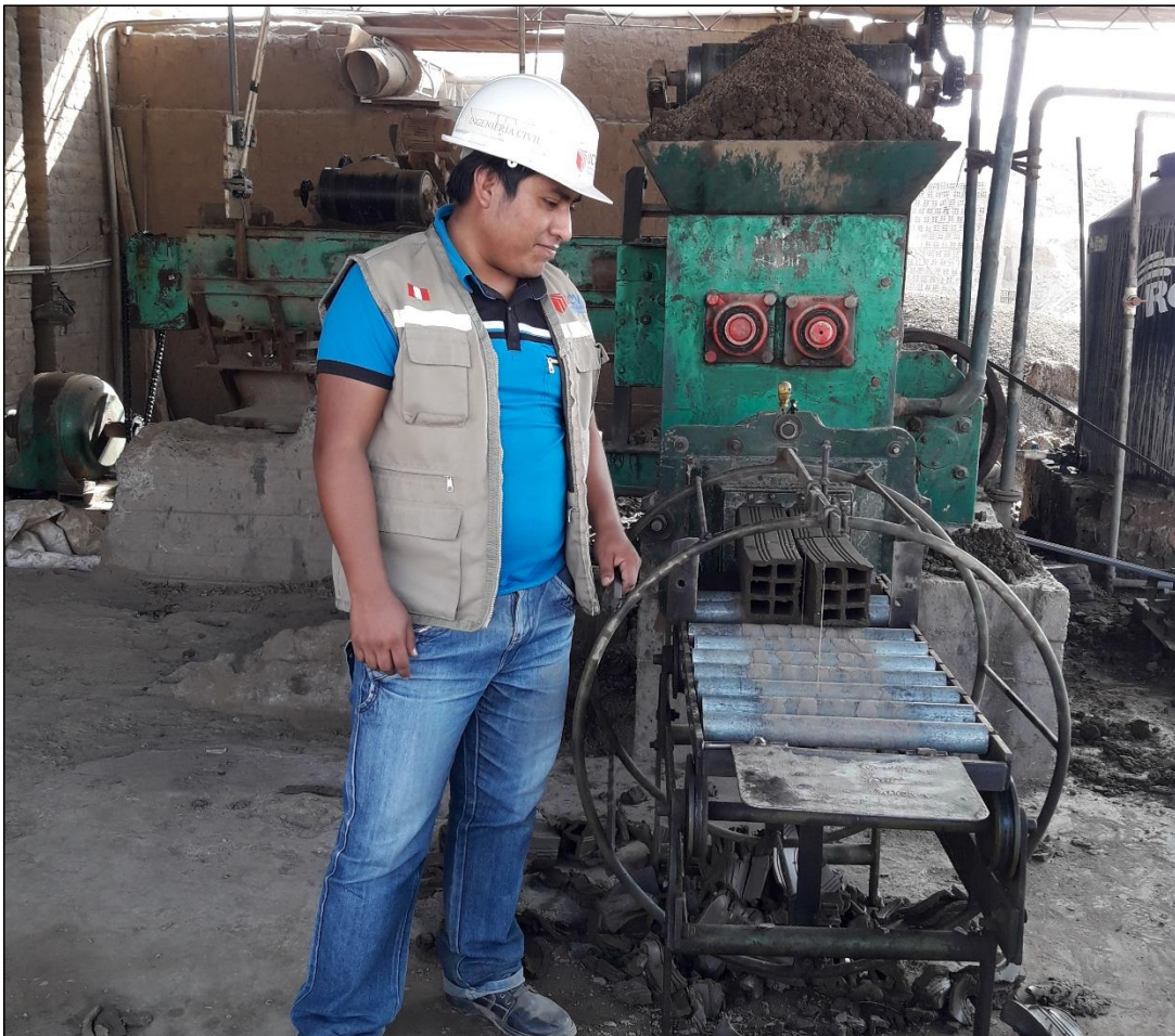
Figura 86. Proceso de mezclado final, moldeo y estrucción.
