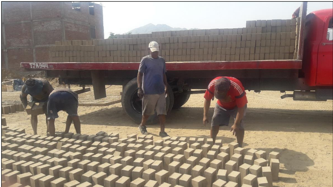
Figura 89. Cargado del ladrillo hacia el horno.
