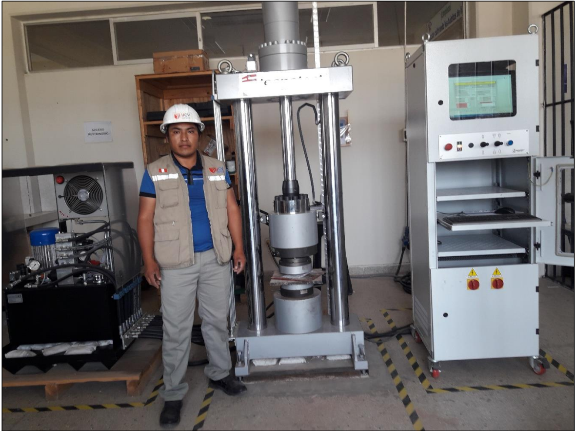
Figura 29. Maquina utilizada para realizar los ensayos de resistencia a la compresión.
