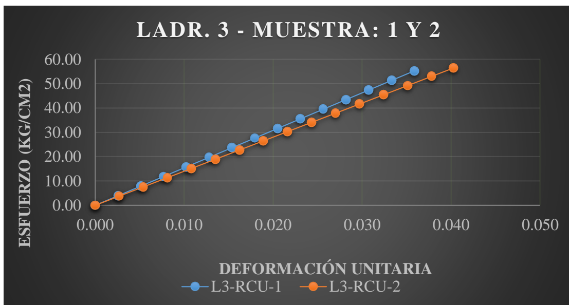
Figura 36. Esfuerzo vs deformación en unidad de la ladrillera 3 – maquinado.
