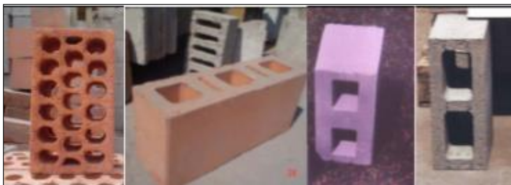
Figura 22. Unidades de albañilería huecas.
