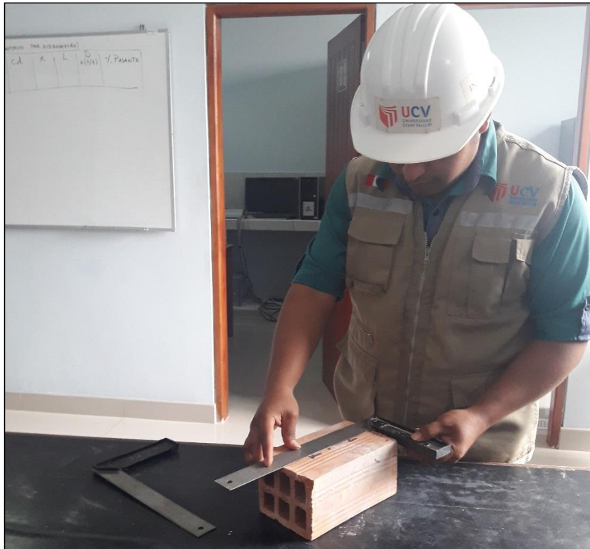
Figura 13. Ensayo de variación dimensional, medición del largo.
