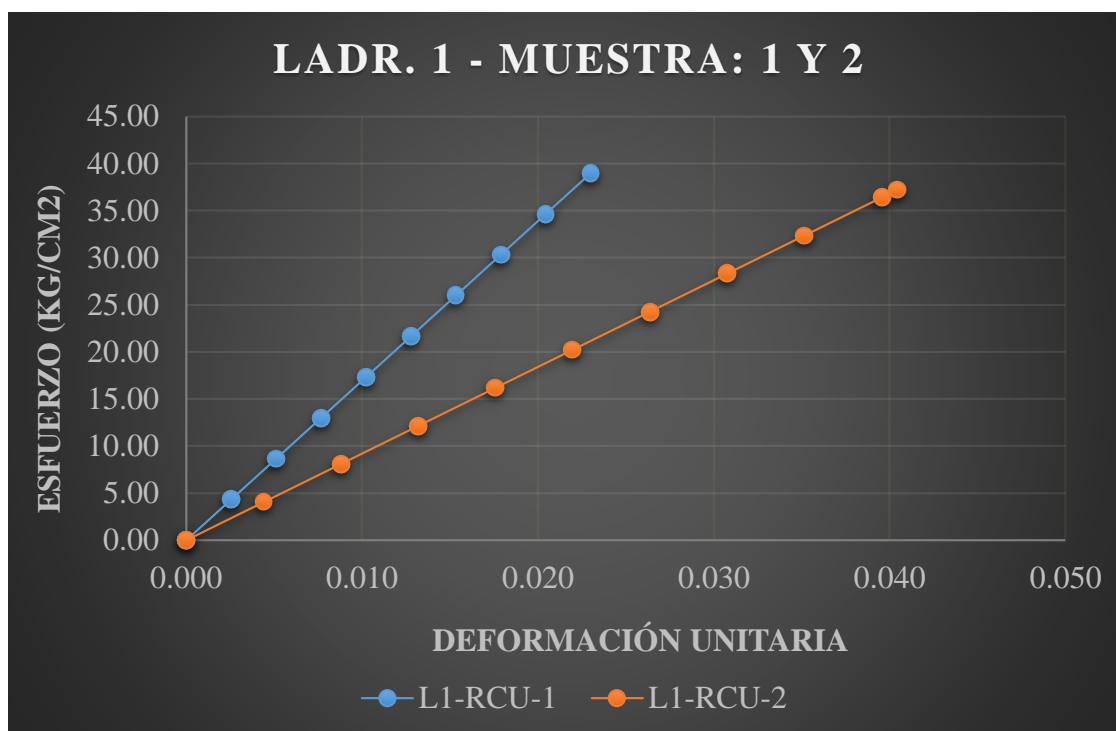
Figura 26. Esfuerzo vs deformación en unidad de la ladrillera 1 – artesanal.
