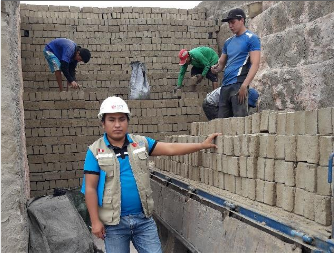
Figura 5. Filado del ladrillo artesanal en el horno.
