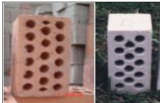
Figura 20. Ladrillo de arcilla y de concreto.
