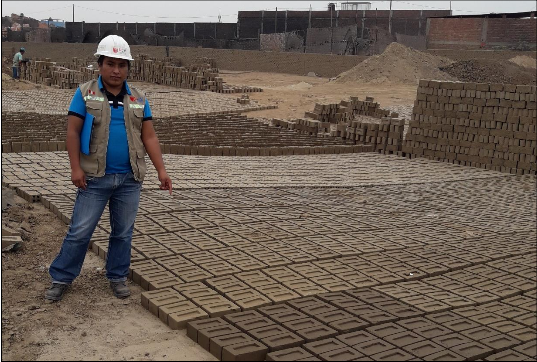
Figura 68. Secado de las unidades de albañilería.
