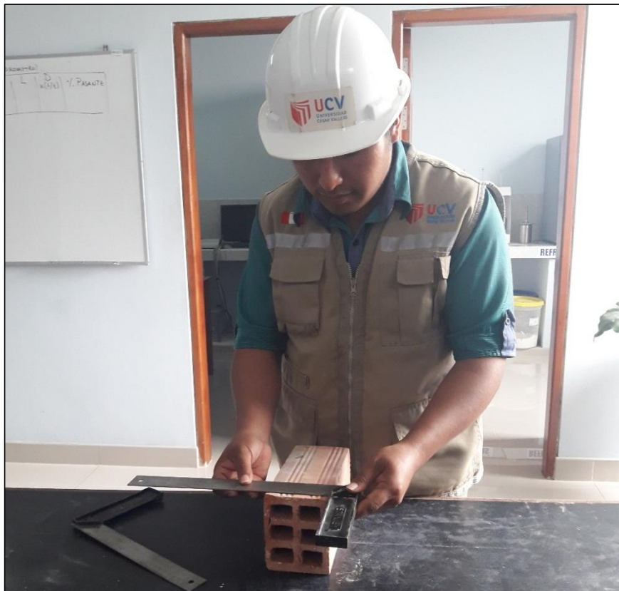
Figura 14. Ensayo de variación dimensional, medición del ancho.
