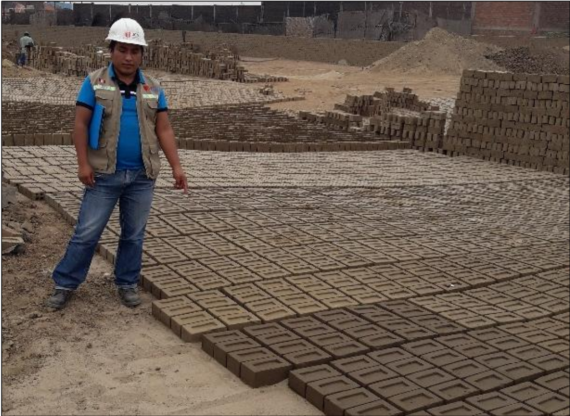
Figura 3. Proceso de secado del ladrillo artesanal.
