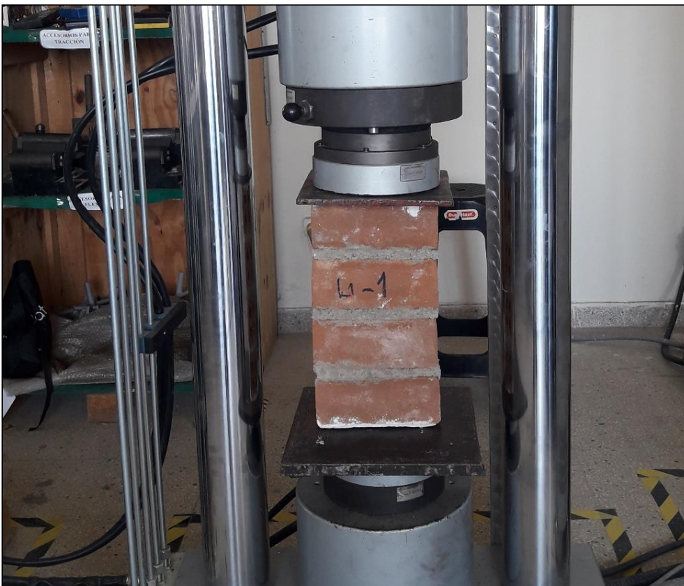
Figura 26. Ensayo de resistencia a la compresión en pila de la ladrillera 1.
