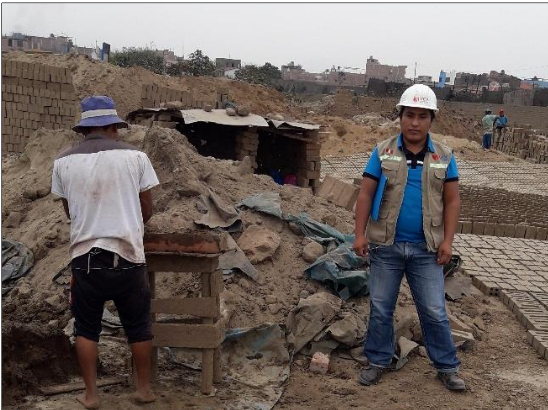
Figura 2. Moldeo y labranza del ladrillo artesanal.
