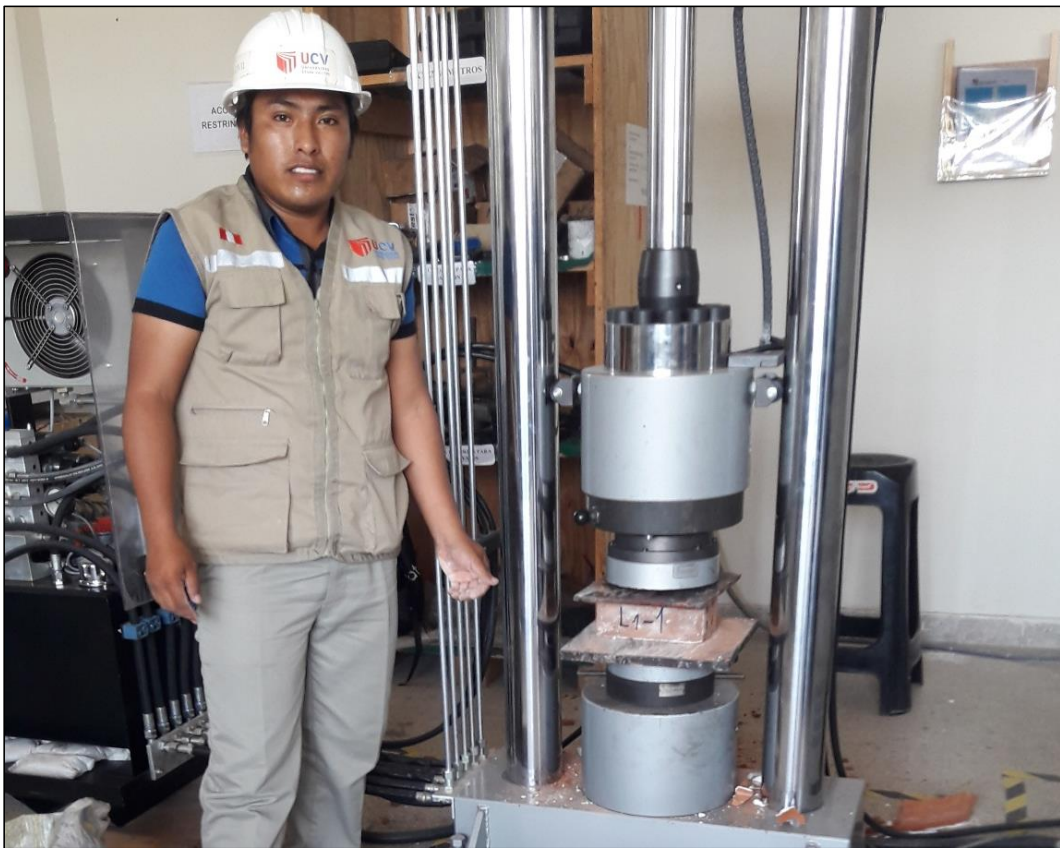
Figura 20. Ensayo de resistencia a la compresión en unidad de la ladrillera 1.
