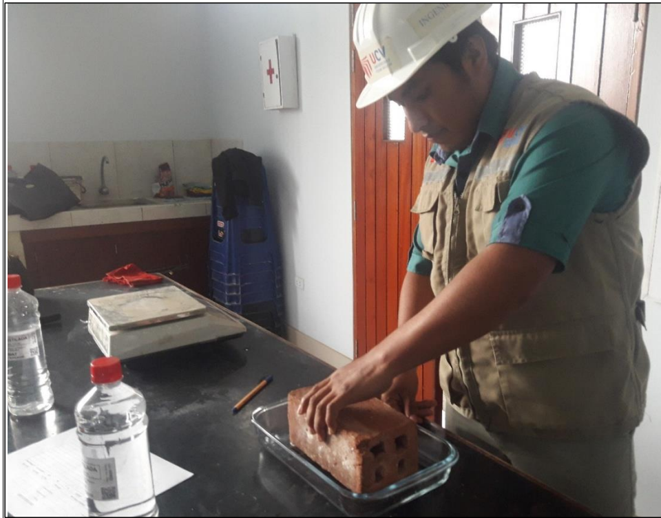
Figura 17. Ensayo de succión, ladrillera 2.
