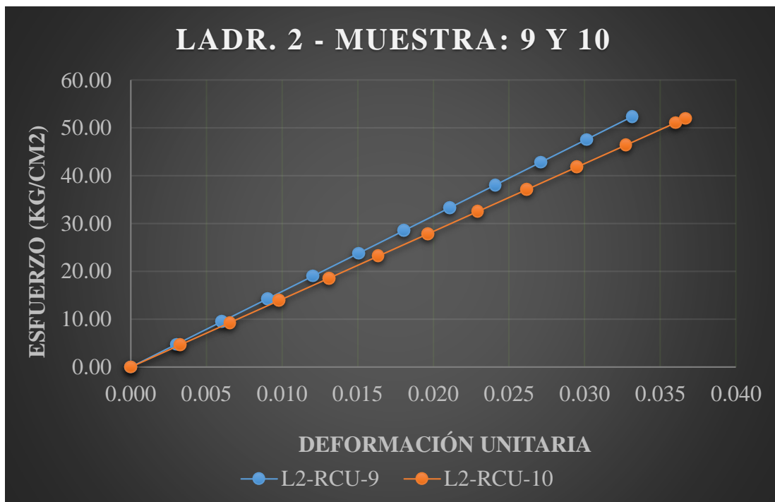
Figura 35. Esfuerzo vs deformación en unidad de la ladrillera 2 – artesanal.
