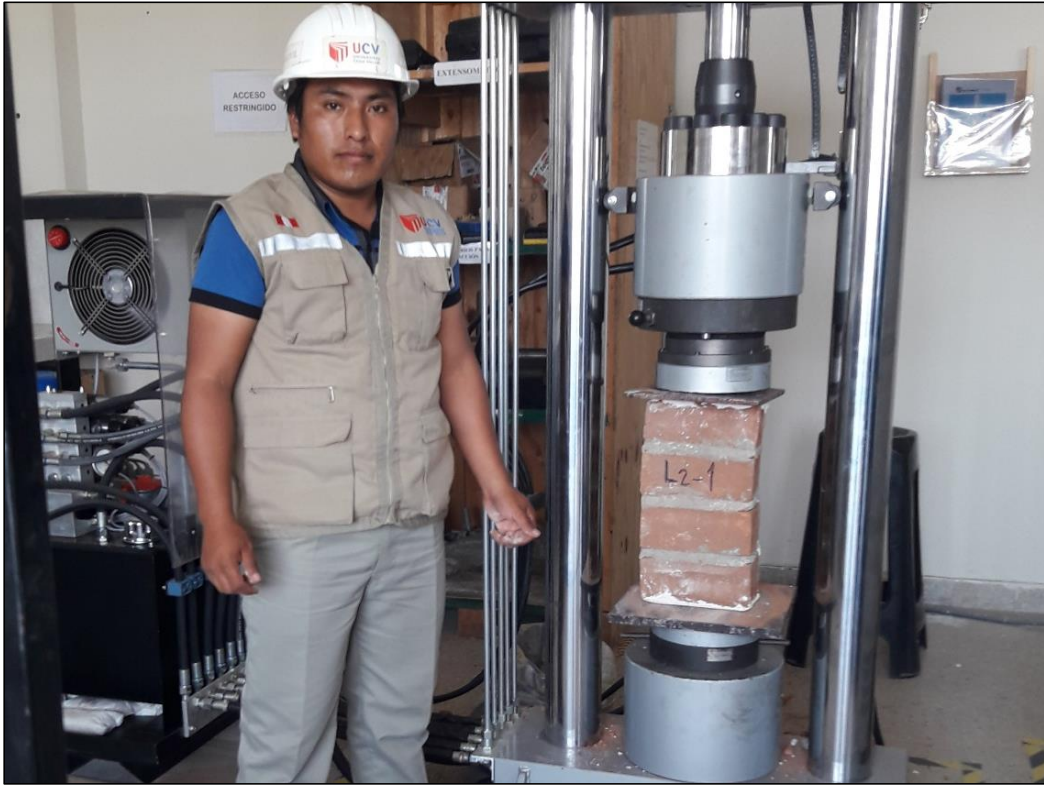
Figura 27. Ensayo de resistencia a la compresión en pila de la ladrillera 2.
