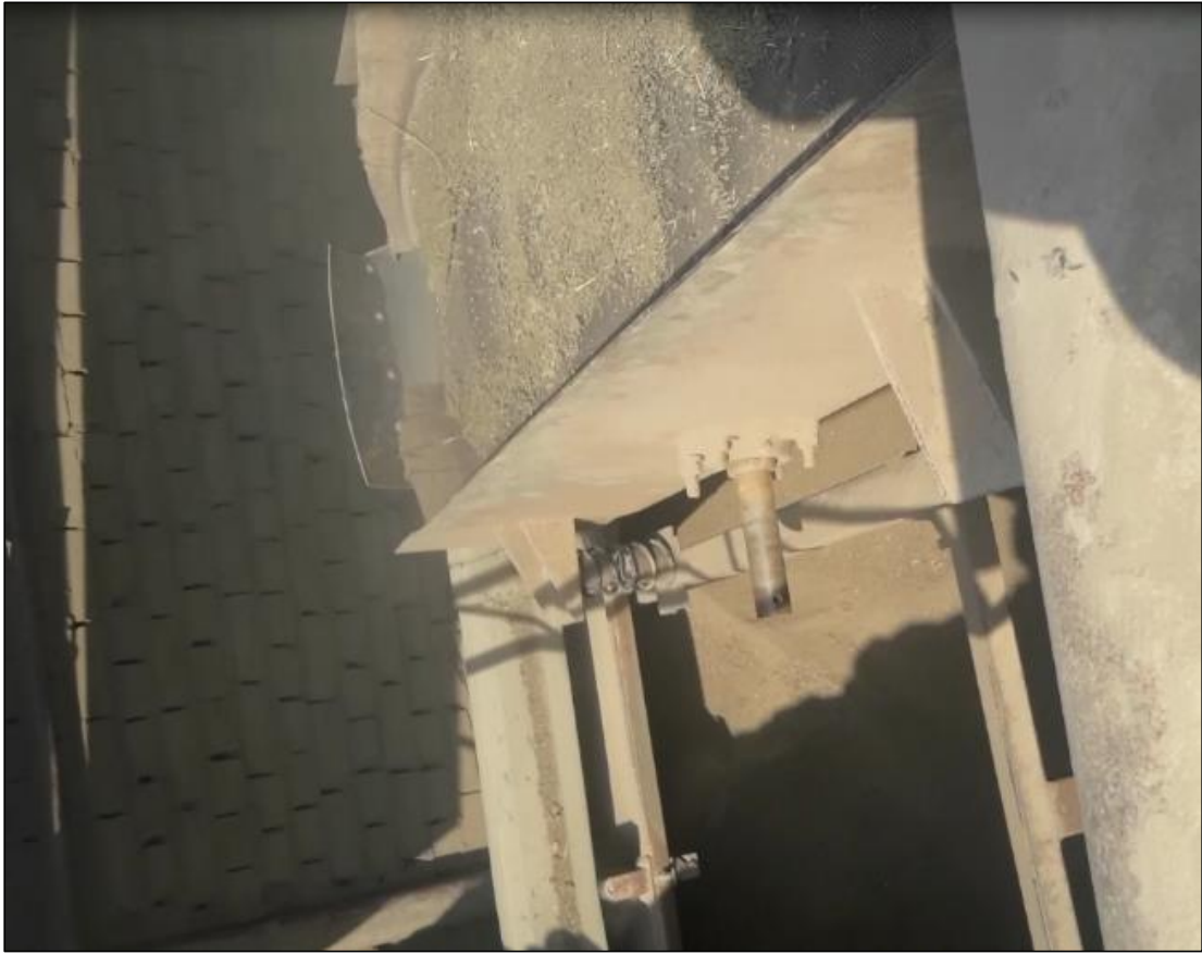
Figura 7. Silo (proceso de cernido del material), para el ladrillo maquinado.
