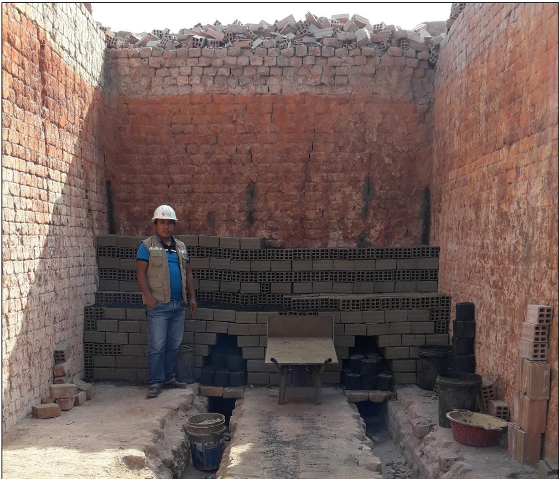
Figura 88. Filado del ladrillo en el horno.
