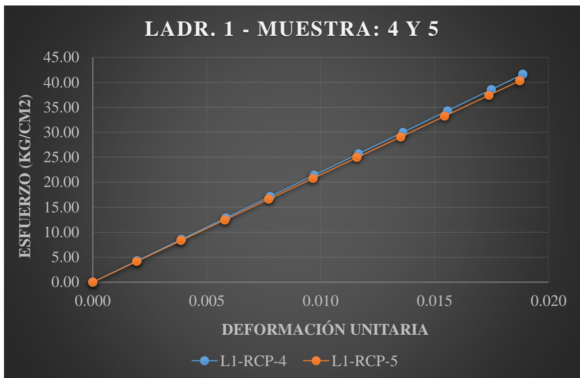
Figura 42. Esfuerzo vs deformación en pila de la ladrillera 1 – artesanal.
