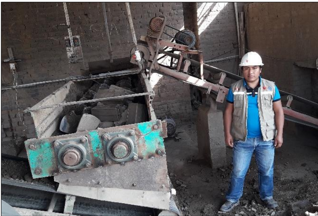
Figura 8. Mezcladora del material, para el ladrillo maquinado.
