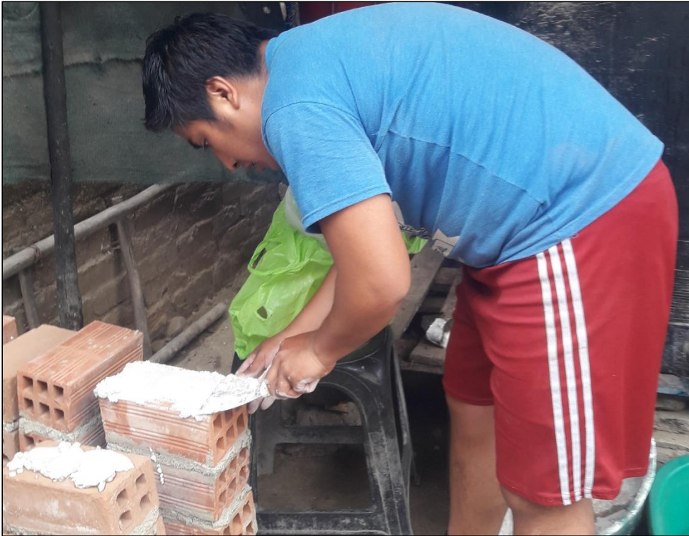
Figura 25. Refrentado de las pilas.
