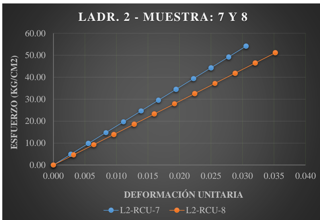
Figura 34. Esfuerzo vs deformación en unidad de la ladrillera 2 – artesanal.
