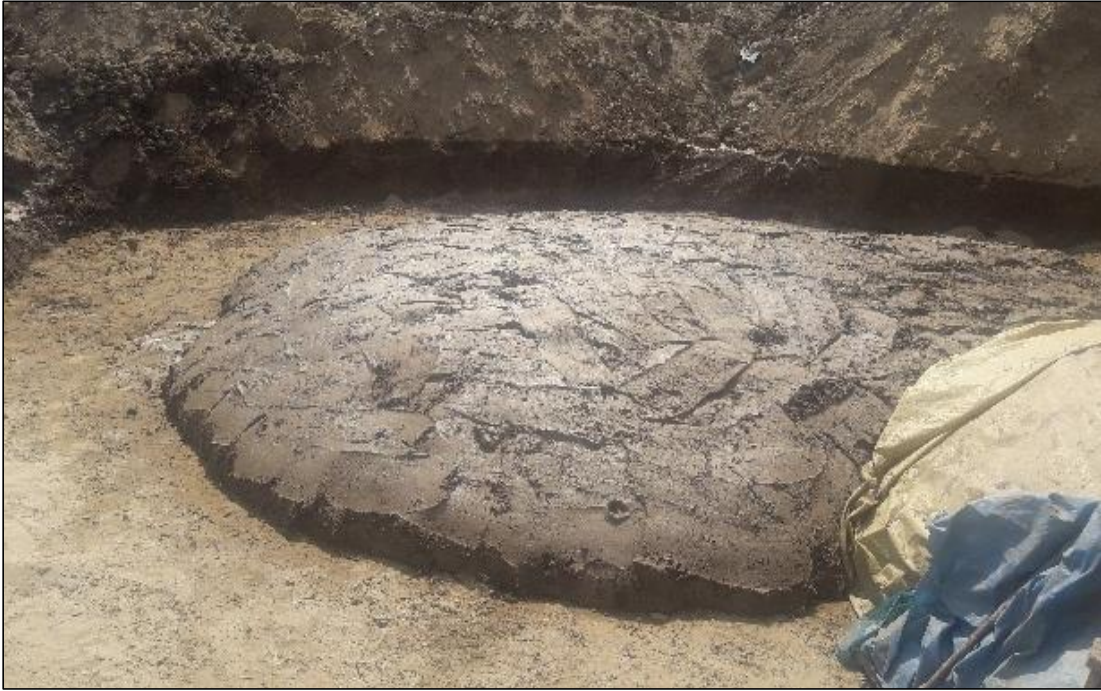
Figura 1. Mezcla preparada en reposo para ladrillo artesanal.
