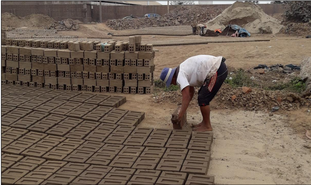
Figura 67. Desmolde de la unidad de albañilería en el área de secado.
