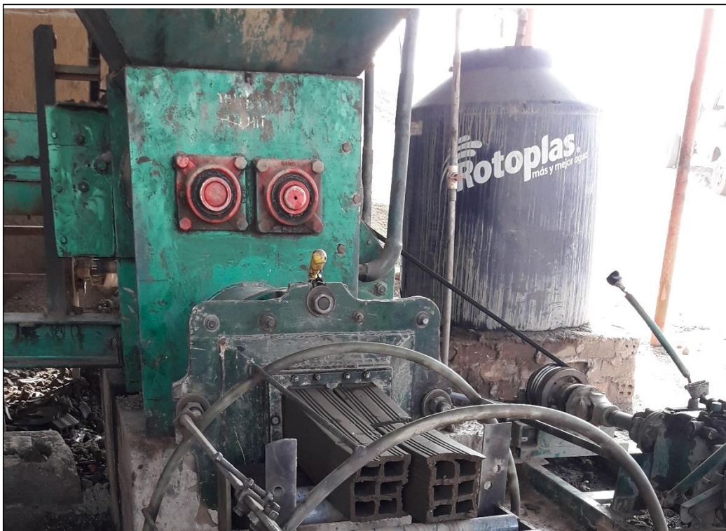
Figura 85. Moldeo y estrucción.
