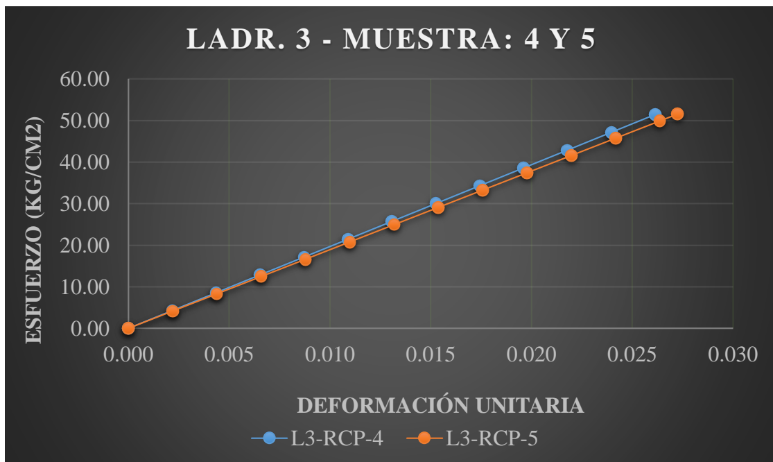
Figura 46. Esfuerzo vs deformación en pila de la ladrillera 3 – maquinado.
