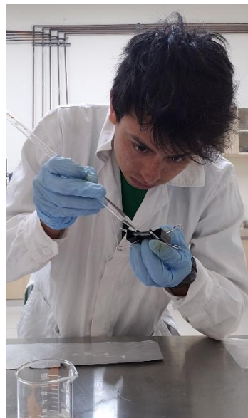
Figura 17. Filtración de la solución electrolítica en la célula fotovoltaica.
