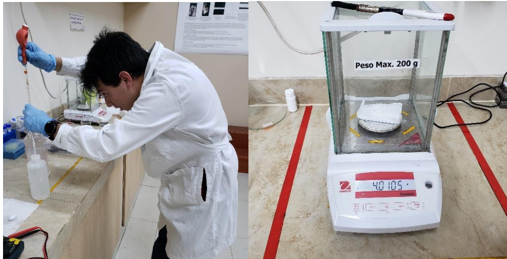
Figura 7. Izquierda: extracción del etanol. Derecha: pesaje del dióxido de titanio.
