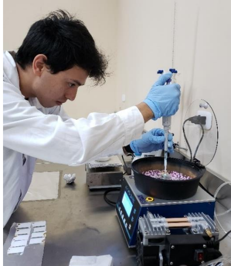
Figura 9. Preparación de las películas delgadas de dióxido de titanio.
