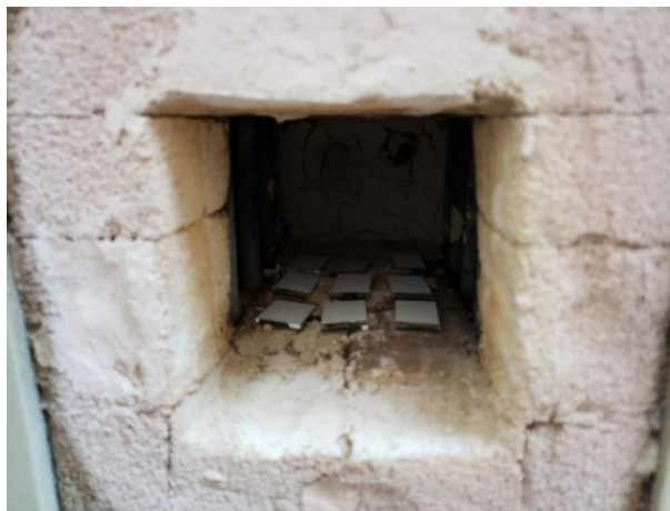
Figura 10. Proceso de sinterizado en el horno.
