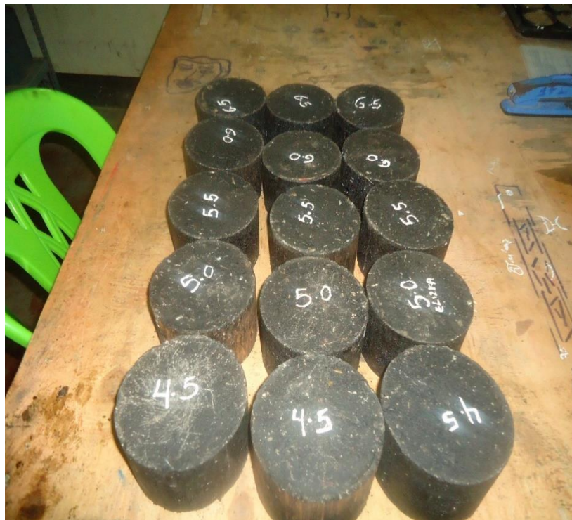
Imagen 49 Se puede observar las 15 briquetas de la mezcla modificada.
