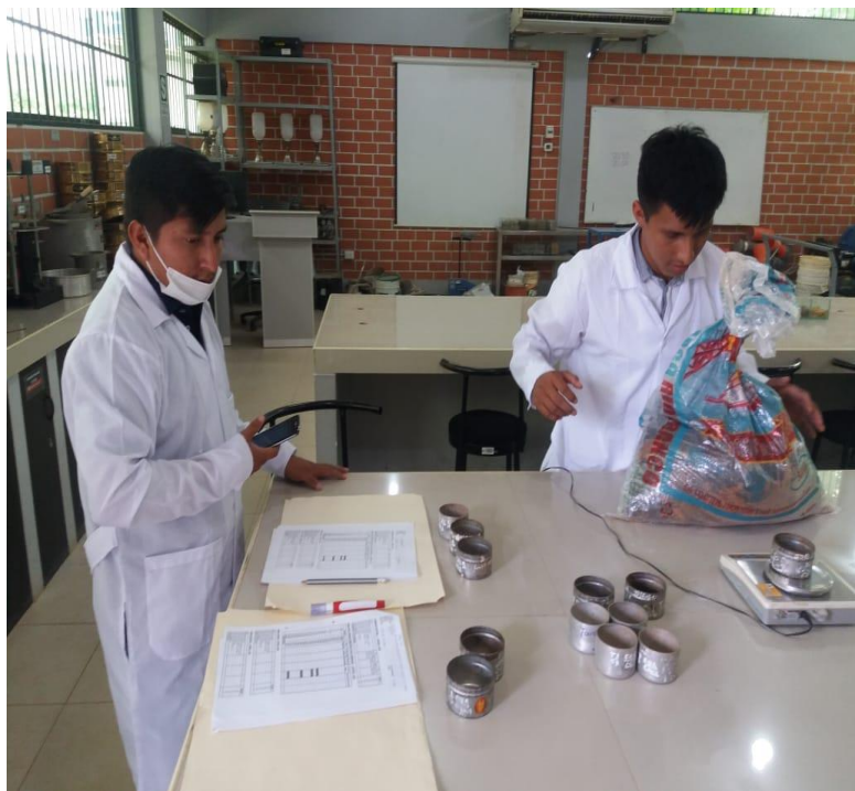
Imagen 41 Se puede observar pesando la muestra para el ensayo de humedad natural
