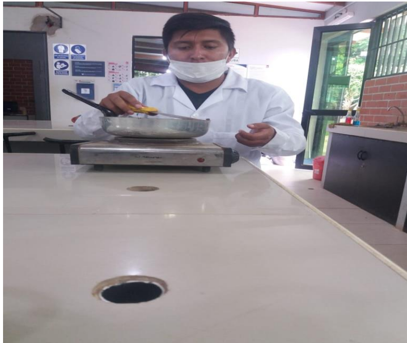
Imagen 47 Se puede observar que se está sumergiendo las briquetas para el baño María.
