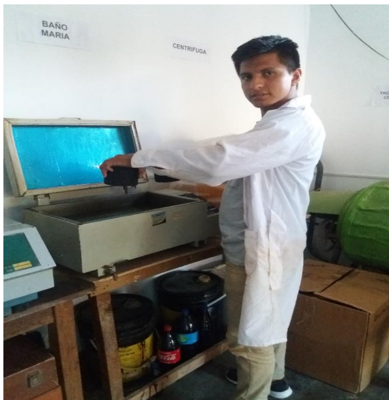
Imagen 47 Se puede observar que se está sumergiendo las briquetas para el baño María.
