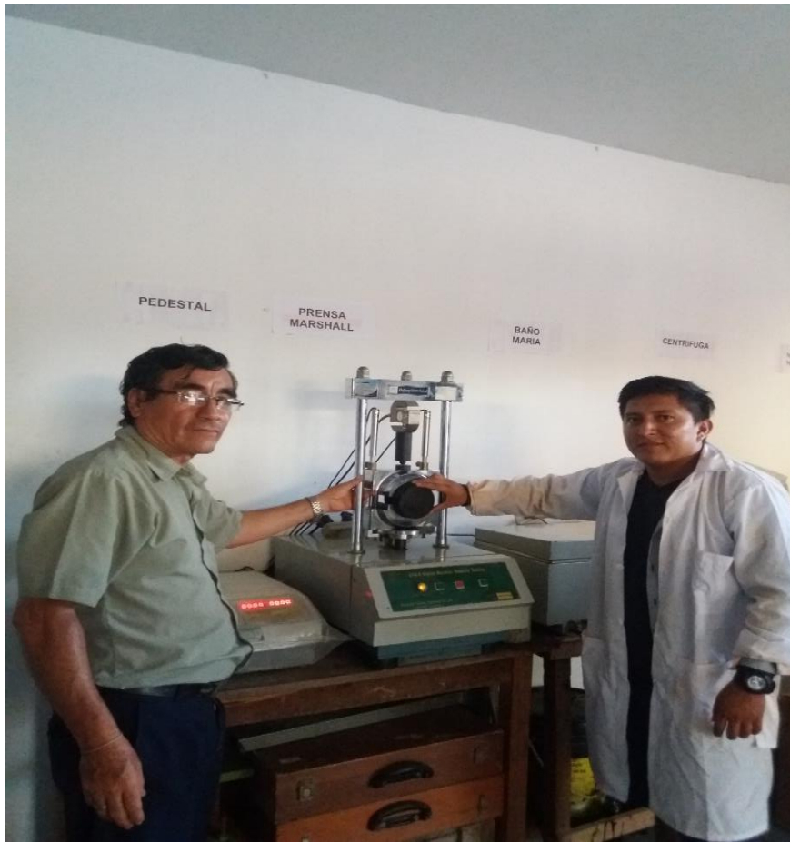
Imagen 50 Se puede observar la briqueta en la prensa Marshall lista para la rotura.
