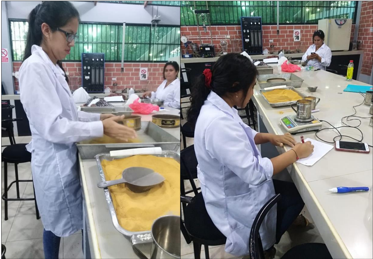
Fotografía 11: Se observa a una de las tésistas cerniendo por el tamiz N° 40 la muestra luego de ser secada al sol y a la otra Tésista pesar 500 gr con los que se realizará los límites líquido y plástico.
