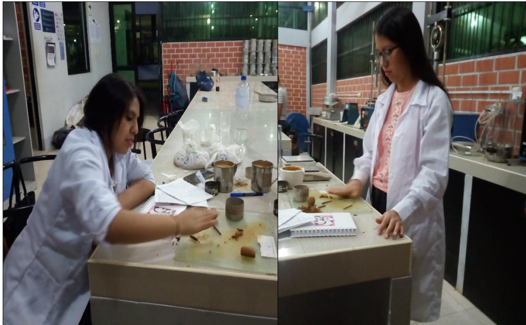
Fotografía 13: Se observa realizar el límite plástico.
