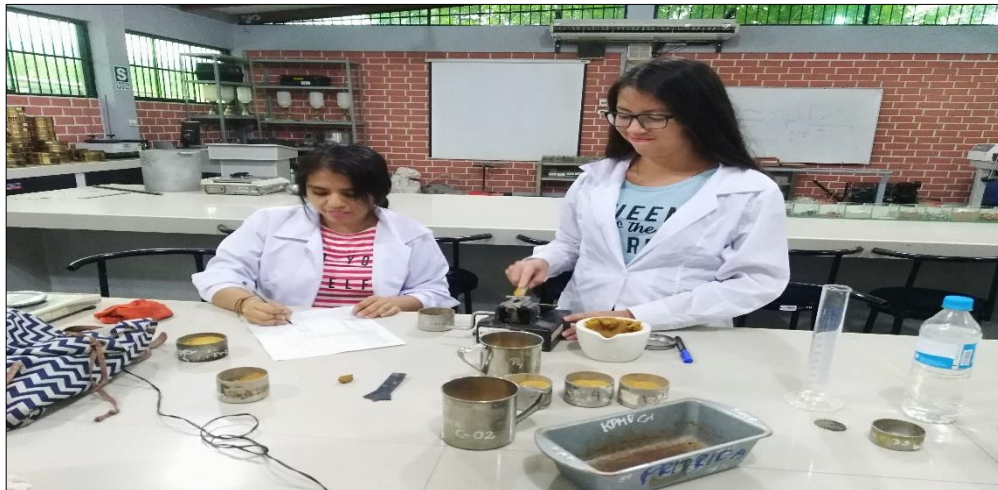
Fotografía 12: Se observa a las tésistas pasar el acanalador por el centro de la copa para cortar en dos la muestra del suelo y la otra tesis apuntar el peso de las latas señaladas
