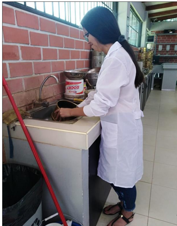
Fotografía 8: Se observa a la Tesista realizar el lavado de la muestra luego de saturar, para el análisis granulométrico.
