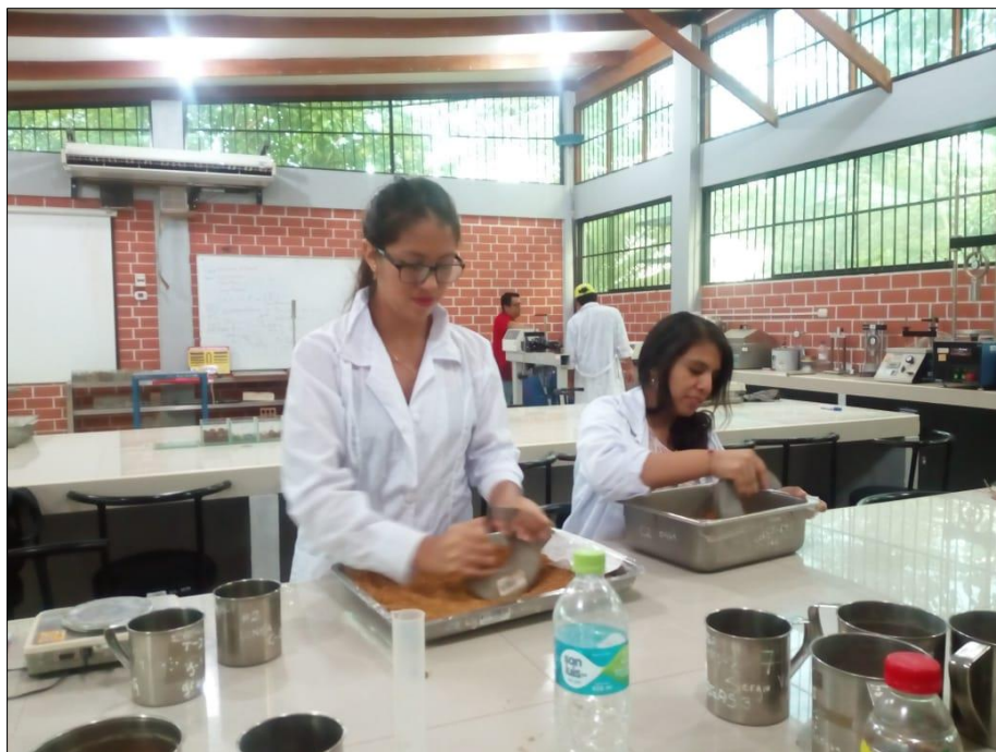
Fotografía 10: Se observa a las tesistas moliendo la muestra secada al sol, para luego cernir para realizar los límites plástico y líquido.
