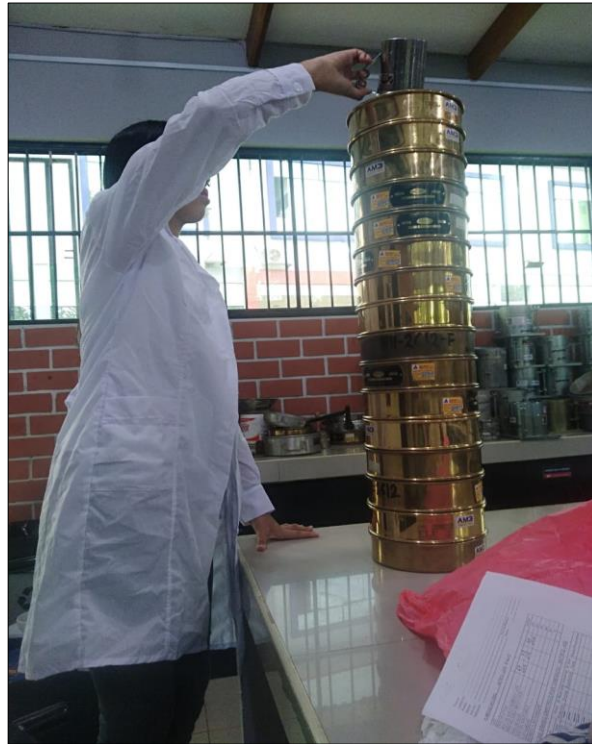
Fotografía 9: Se observa a la Tesista vaciar la muestra seca en los tamices para obtener el peso retenido, para el análisis granulométrico.
