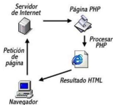
Figura 1: Ejecución de PHP
