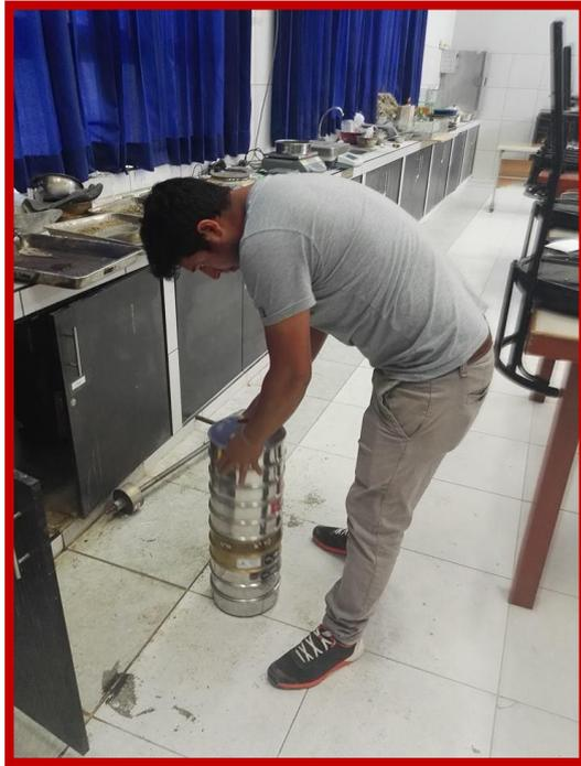
**FOTO N°15.-** VISTA DONDE SE APRECIA EL ENSAYO DE GRANULOMETRIA POR TAMIZADO.
