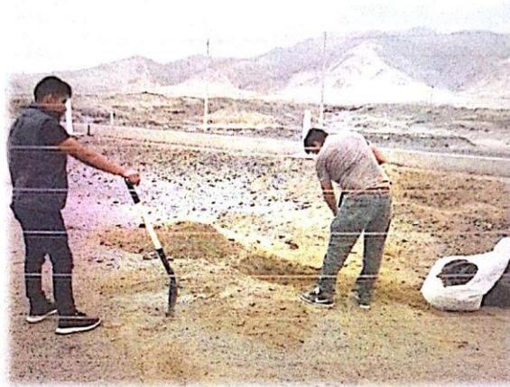
En la imagen se observa la excavación de calicata para la obtención de muestras para ser analizadas en el laboratorio
