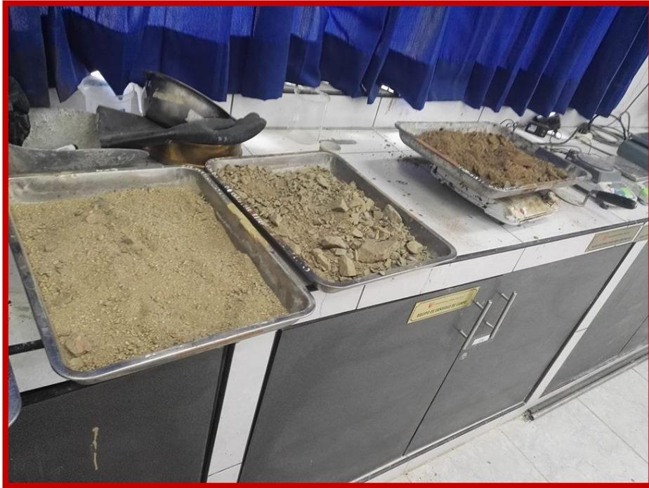
**FOTO N°17.- VISTA DONDE SE APRECIA LA SELECCIÓN DE MUESTRAS POR TIPO EN LAS CUALES ESTAN LA BASE, SUB BASE Y RASANTE.**
