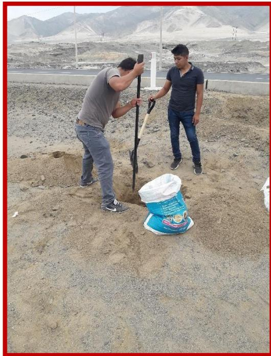
**FOTO N°8.-** VISTA DONDE SE APRECIA LA RECOLECCIÓN DE MUESTRA DE SUELO PARA ENSAYOS DE LABORATORIO.
