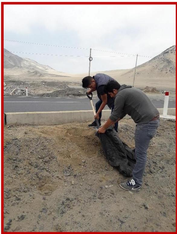
**FOTO N°7.-** VISTA DONDE SE APRECIA LA RECOLECCIÓN DE MUESTRA DE SUELO PARA ENSAYOS DE LABORATORIO.
