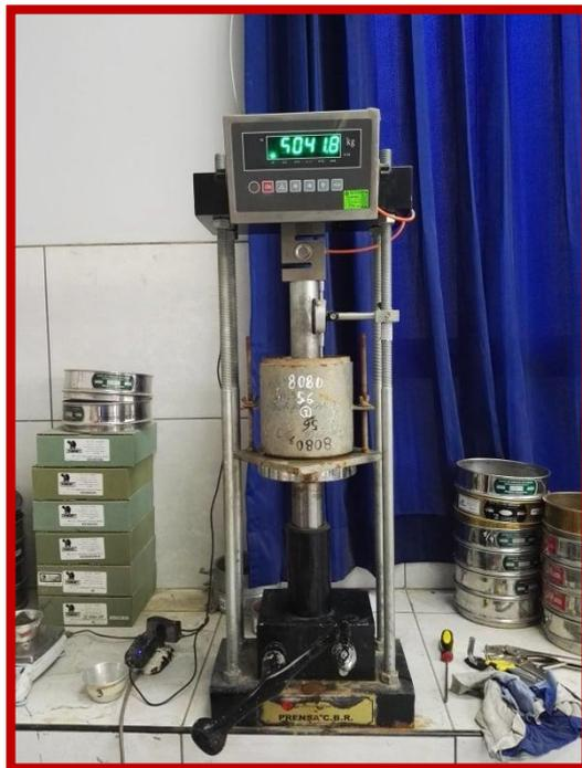
**FOTO N°18.- VISTA DONDE SE APRECIA LA REALIZACIÓN DEL ENSAYO CBR.**
