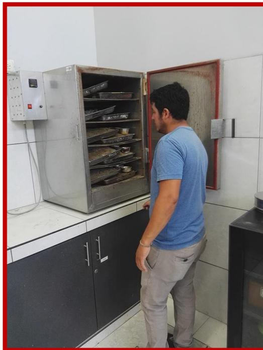
**FOTO N°12.- VISTA DONDE SE APRECIA EL SECADO DE LA MUESTRA PARA ENSAYOS PROCTOR Y CBR.**
