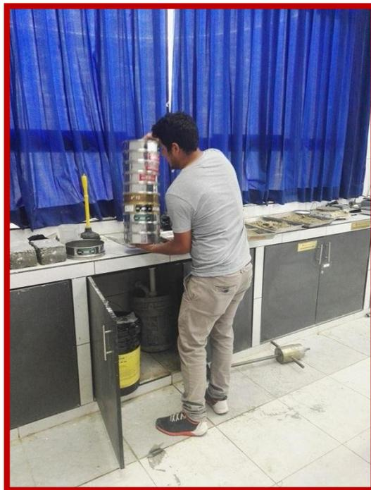
**FOTO N°16.-** VISTA DONDE SE APRECIA EL ENSAYO DE GRANULOMETRIA POR TAMIZADO.
