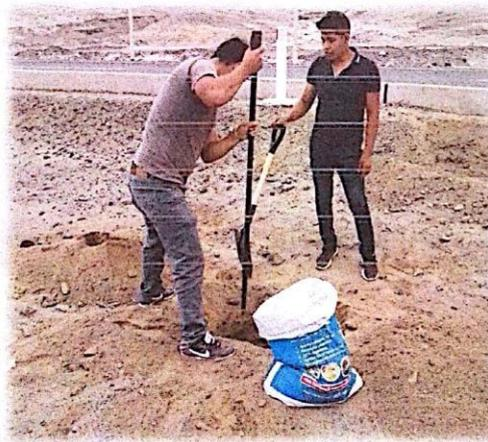
En la imagen se aprecia la toma de muestra aproximadamente 30 kg para realizar los ensayos correspondientes.
