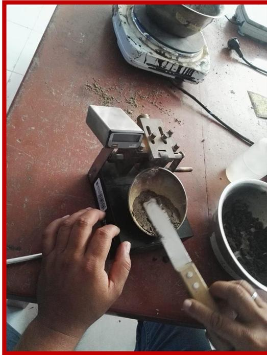
**FOTO N°11.- VISTA DONDE SE APRECIA EL ENSAYO DE PLASTICIDAD CON LA CUCHARA DE CASA GRANDE.**
