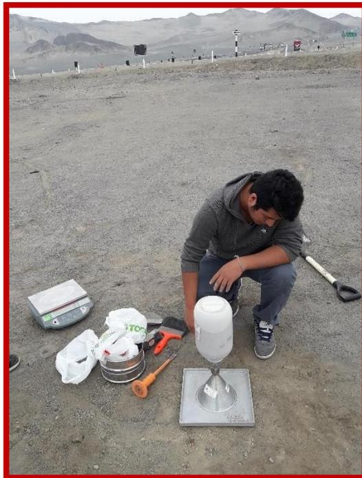
**FOTO N°10.-** VISTA DONDE SE APRECIA EL ENSAYO DE DENSIDAD DE CAMPO CON EL CONO DE ARENA.
