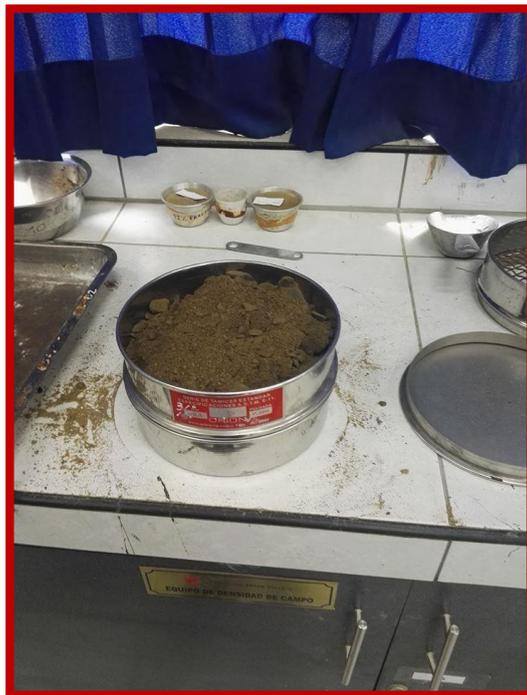
**FOTO N°14.-** VISTA DONDE SE APRECIA EL ENSAYO DE GRANULOMETRIA POR TAMIZADO.
