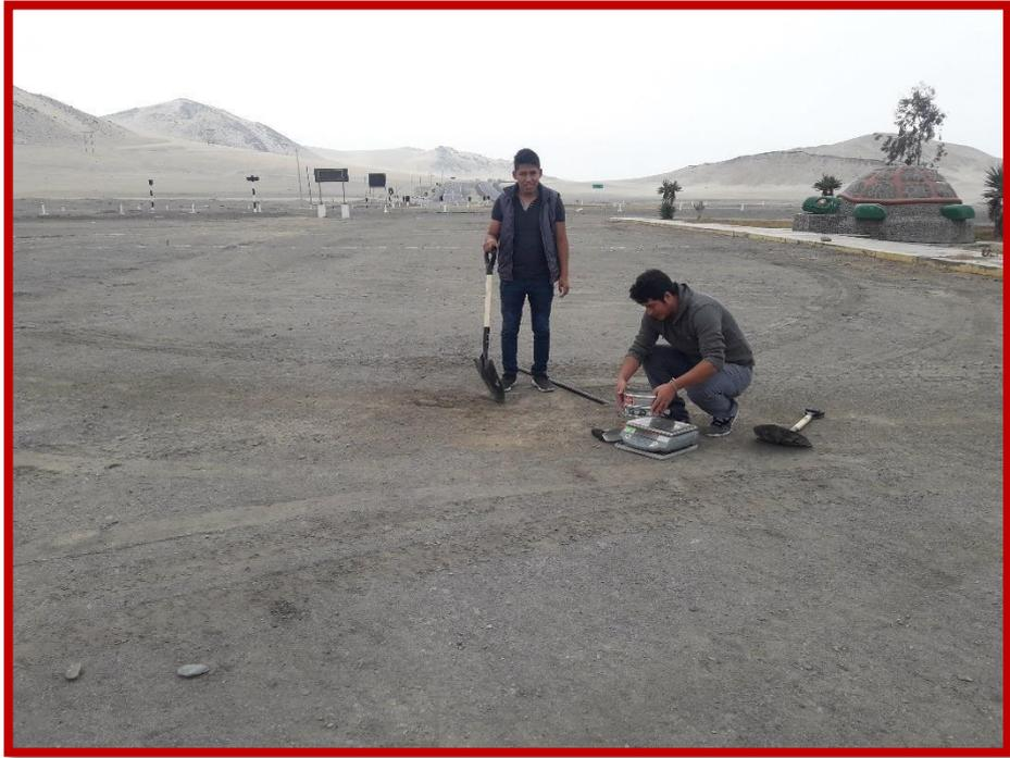
**FOTO N°9.-** VISTA DONDE SE APRECIA EL ENSAYO DE DENSIDAD DE CAMPO DE LA MUESTRA EXTRAIDA.
