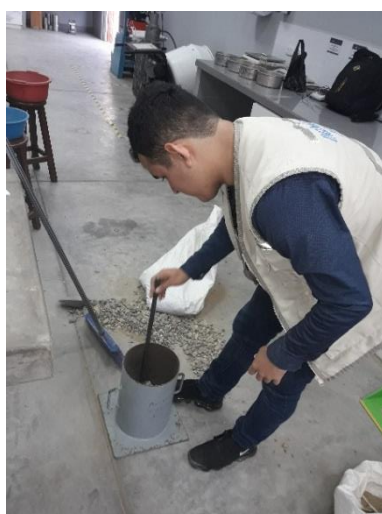
Figura 8. Varillado al agregado grueso para el peso unitario compactado
