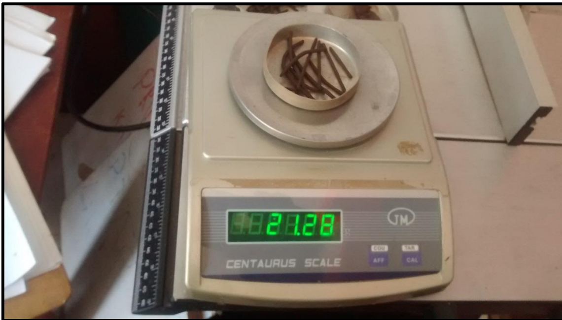
Figura N° 23: Pesaje de muestra de límite plástico.
