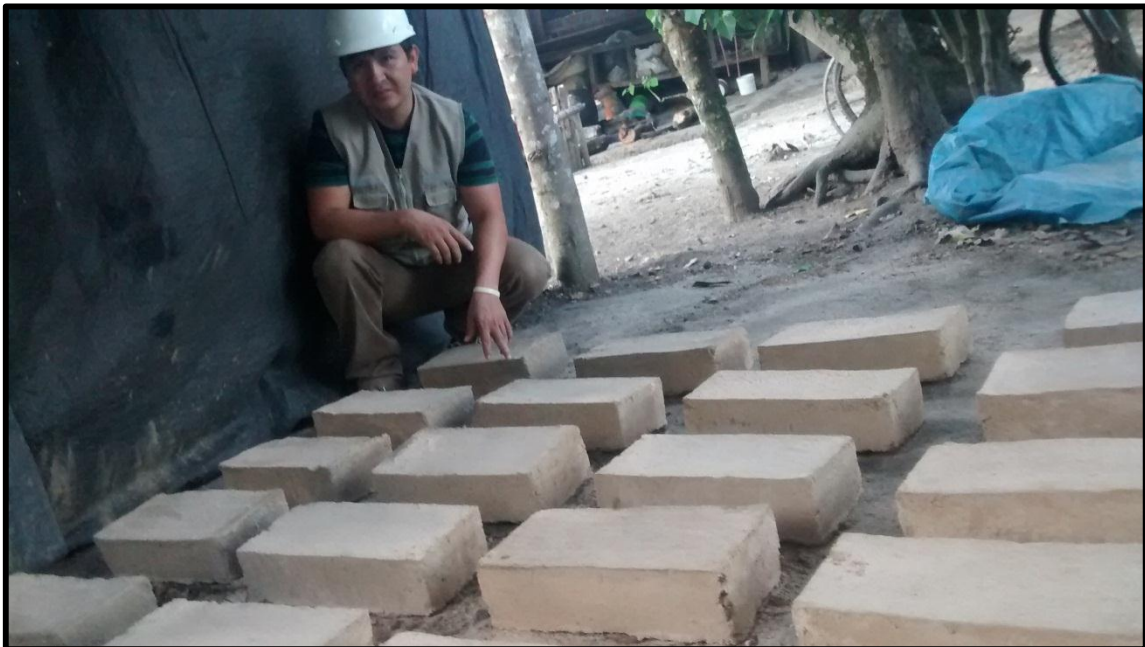
Figura N° 40: Especímenes después de 28 días de secado.
