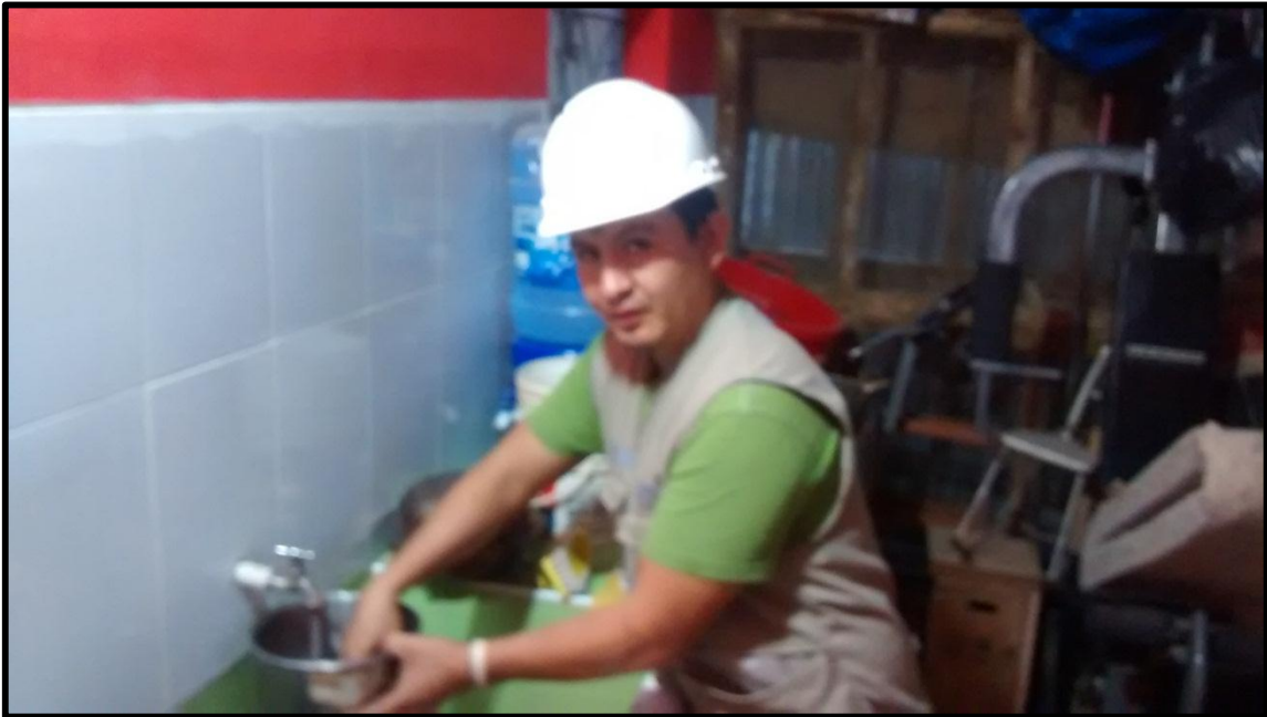
Figura N° 29: Lavado de material en tamiz N°200 para ensayo de granulometría.
