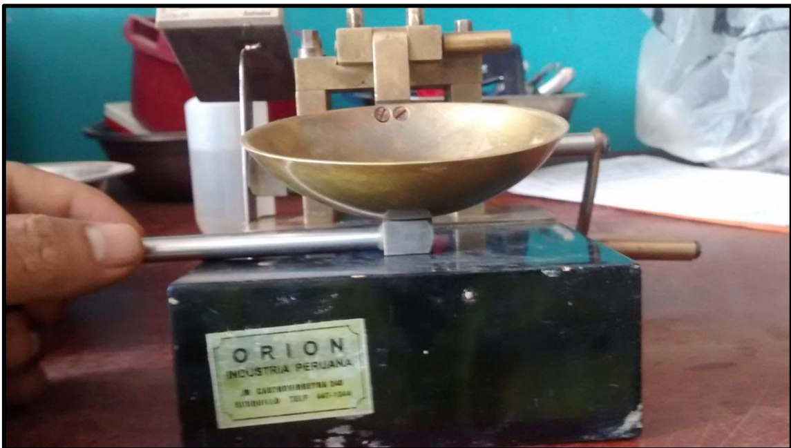
Figura N° 20: Calibración de Copa Casagrande.
