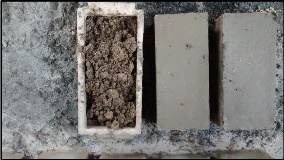
Figura N° 37: Fabricación de adobes con 2% de aserrín de Romerillo.
