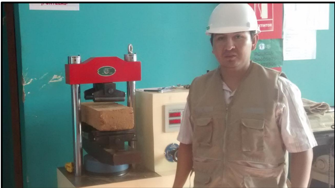
Figura N° 42: Realizando ensayo a flexión.
