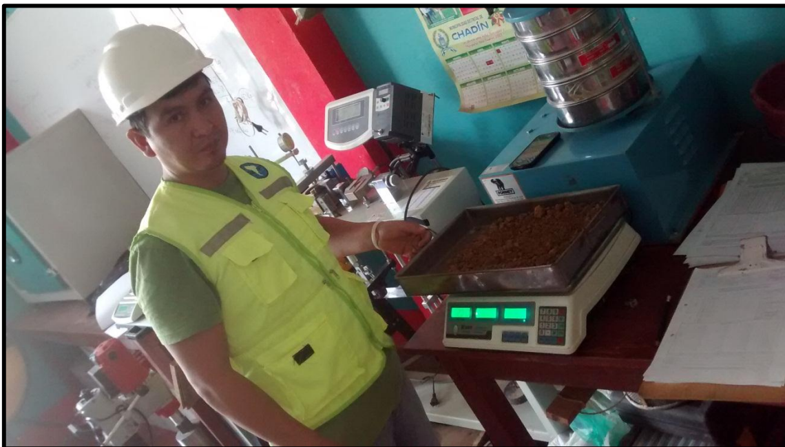
Figura N° 24: Pesaje de material para ensayo de proctor modificado.
