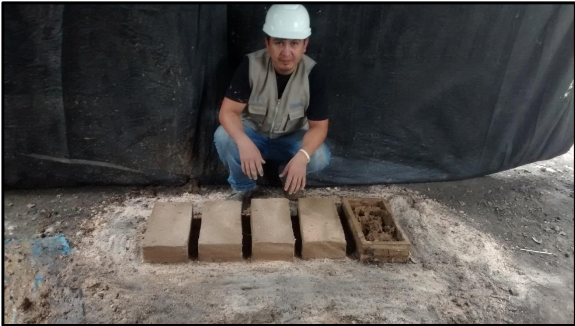
Figura N° 39: Fabricación de adobes patrón.
