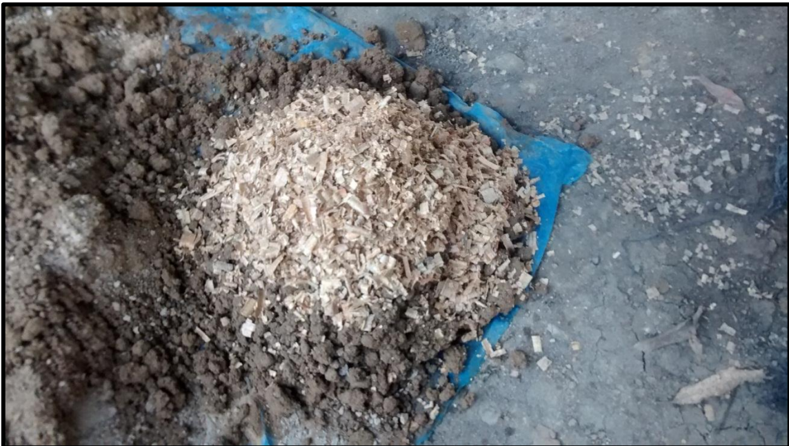
Figura N° 38: Adicionamiento de 4% de viruta de Romerillo al suelo.
