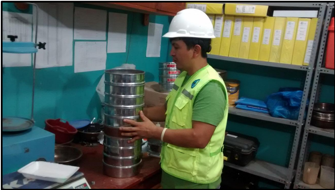
Figura N° 31: Ensayo de granulometría.
