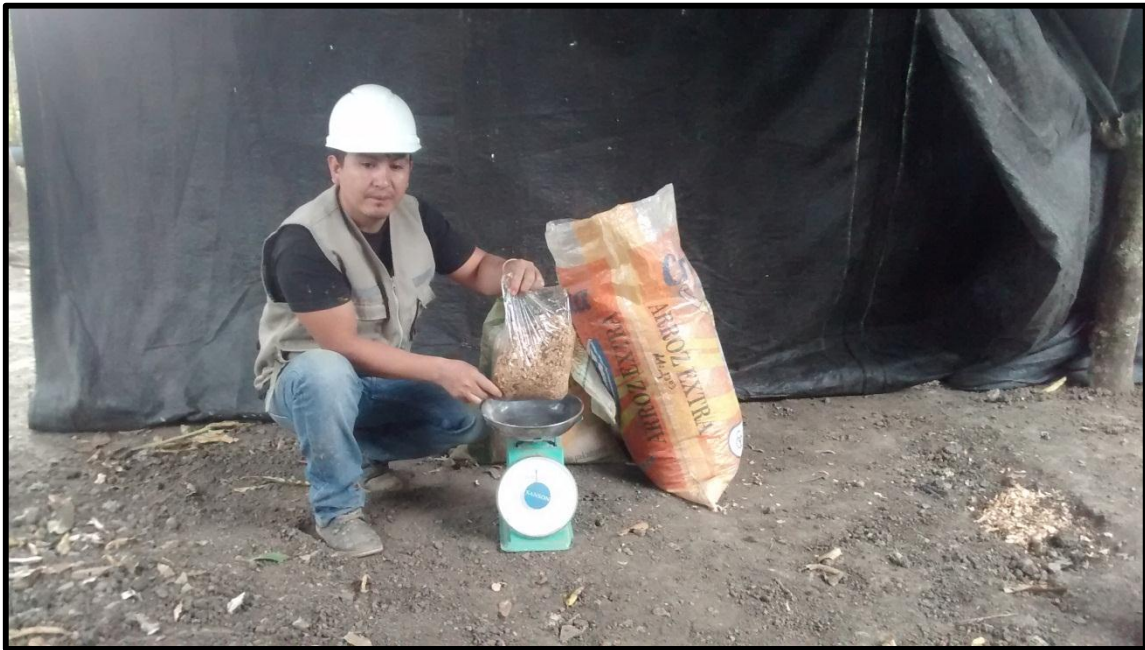
Figura N° 35: Pesaje de viruta de Romerillo para un adobe.
