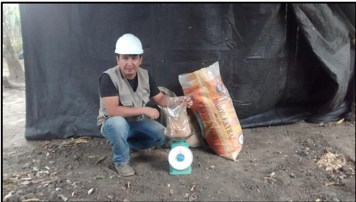
Figura N° 36: Pesaje de aserrín de Romerillo para un adobe.
