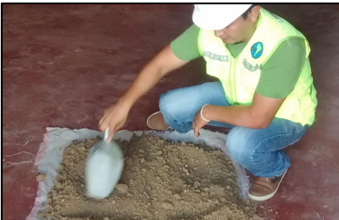
Figura N° 18: Cuarteo del material en el laboratorio.
