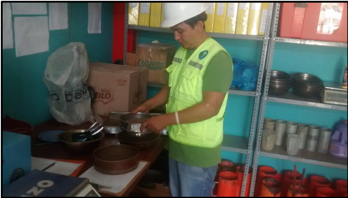
Figura N° 19: Tamizado de material para límites de consistencia.
