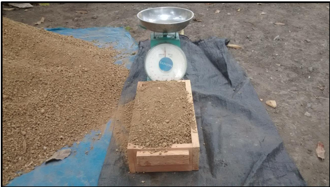
Figura N° 33: Pesaje de suelo seco aproximado en un adobe.
