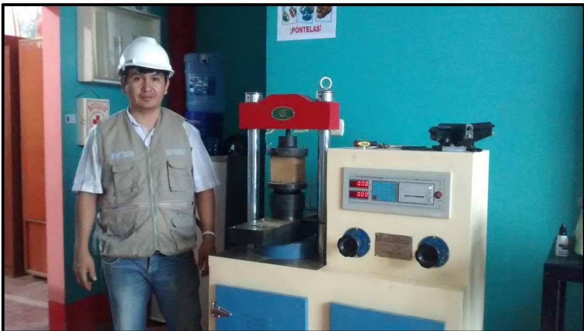
Figura N° 44: Muestra de adobe lista para el ensayo a compresión.
