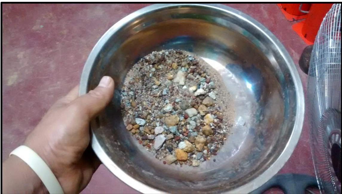
Figura N° 30: Material seco lavado en tamiz N°200 para ensayo de granulometría.
