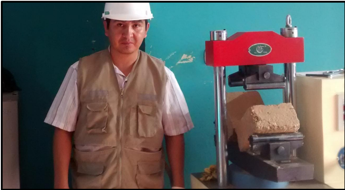
Figura N° 43: Muestra de adobe rota por el ensayo de flexión.
