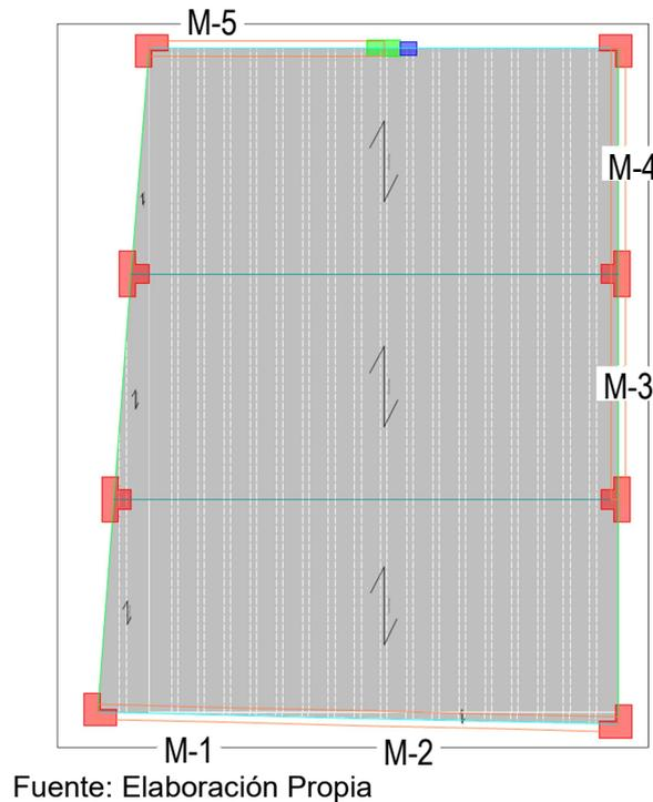
En la Figura N° 48, se muestra los esfuerzos de corte en los muros de corte de mampostería considerando un coeficiente de reducción de fuerza sísmica  $R = 3$ , que equivale según la normativa vigente al análisis para un sismo severo. Se aprecia que los máximos esfuerzos alcanzan el orden de 2.78 Kg/cm<sup>2</sup>.
