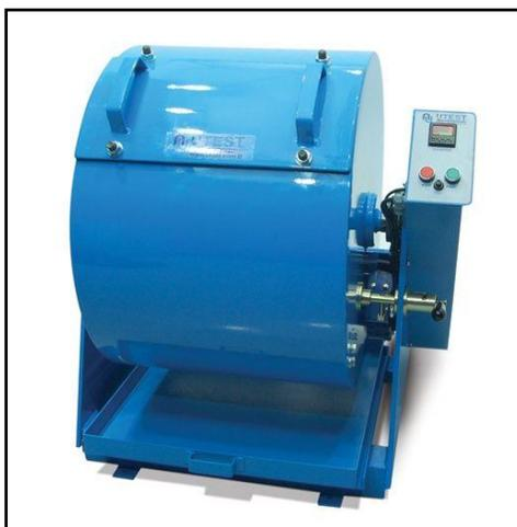
Figura 11: Máquina de abrasión tipo Los Ángeles
