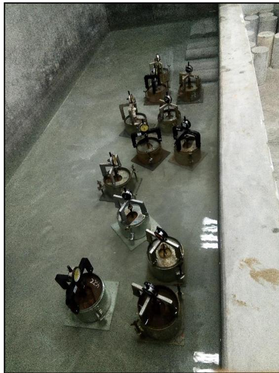
Figura 49: Ensayo de CBR, medición de expansión.
