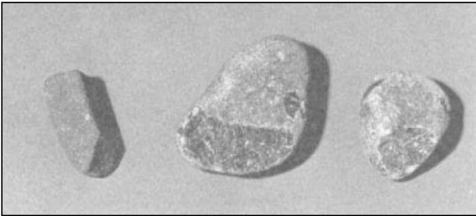
Figura 35: Partículas fracturadas (centro) flanqueadas por dos partículas no fracturadas (solo astillada)
