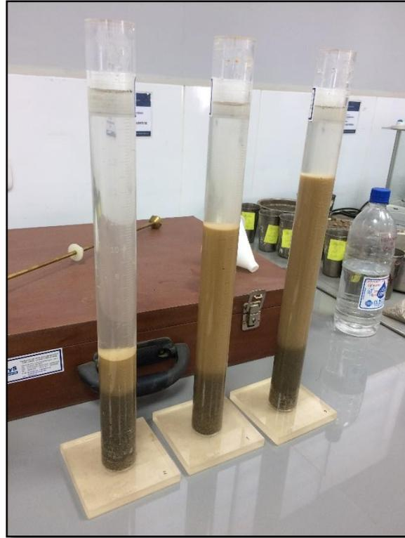
Figura 50: Ensayo de Equivalente de Arena
