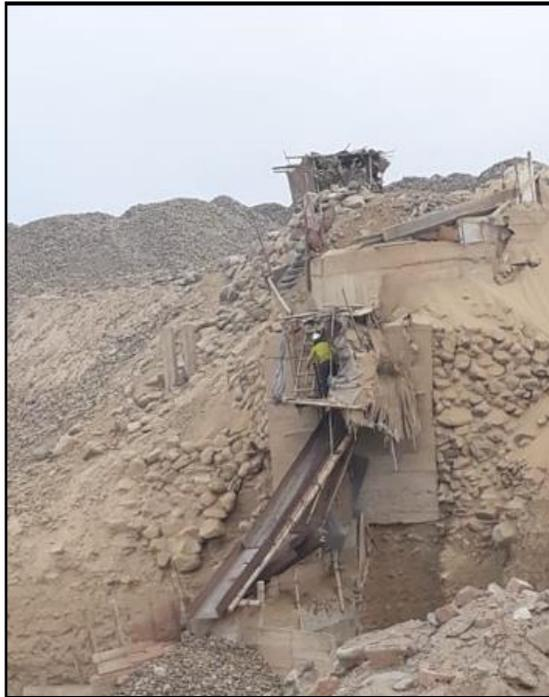
Figura 18: Maquina Clasificadora de Agregados de la Cantera Oasis
