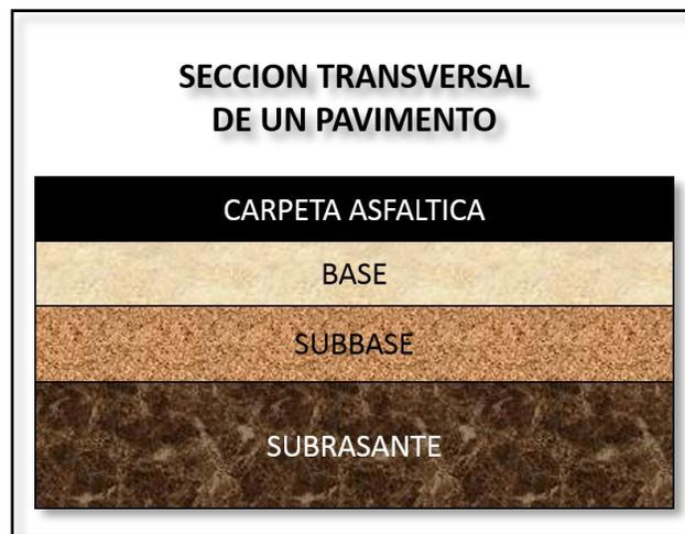
Figura 1: Sección Transversal de un Pavimento.
