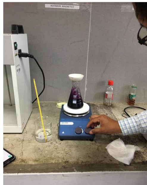
Figura 10: Agitación constante de la Mezcla
