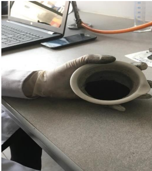
Figura 15: Obtención Final de Oxido de Grafeno
