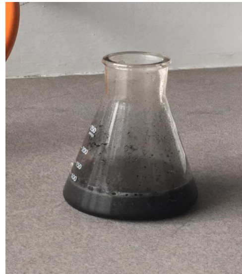
Figura 8: Homogenización de Grafito y H 2 SO 4
