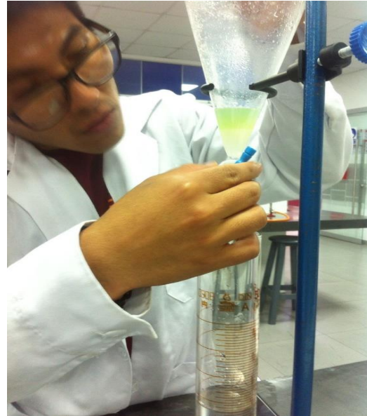
Figura 23: Extracción de aceites y grasas
