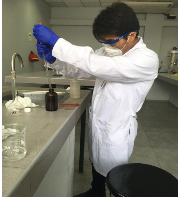
Figura 14: Preparación de la solución 1:10 (HCl)
