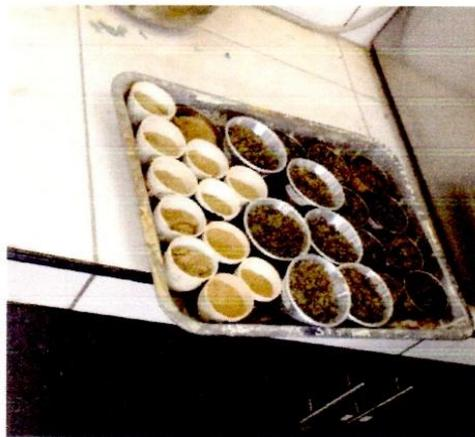
Colocación de las muestras en fuentes al horno a  $110\text{ }^{\circ}\text{C} \pm 5^{\circ}\text{C}$ .
