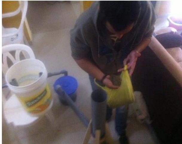
**Figura N° 24: Se introduce la arena gruesa**
