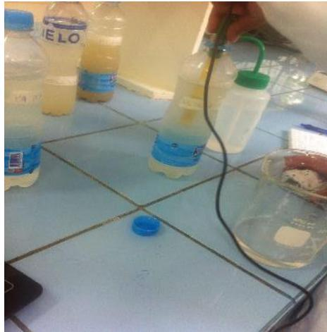
**Figura N° 13: Medición de Conductividad**
