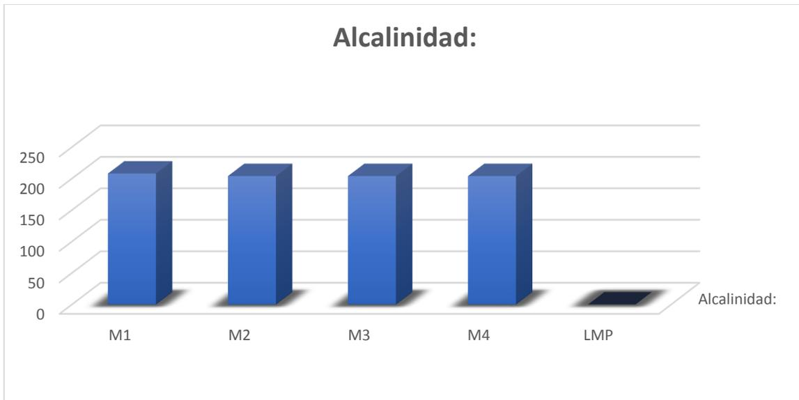
**Figura N° 05: Medida de la alcalinidad de las aguas residuales tratadas en el sistema de tratamiento de aguas grises para el regado de áreas verdes en la I.E. N°15509 – Talara – Piura.**
