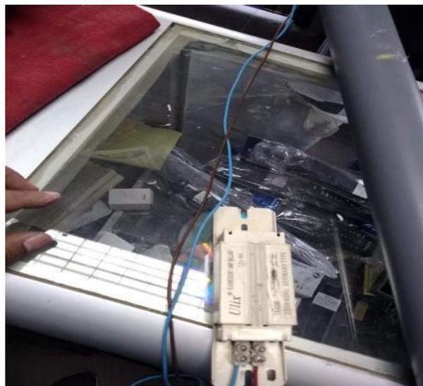
**Figura N° 30: Arrancador del sistema de Lux Uv**
