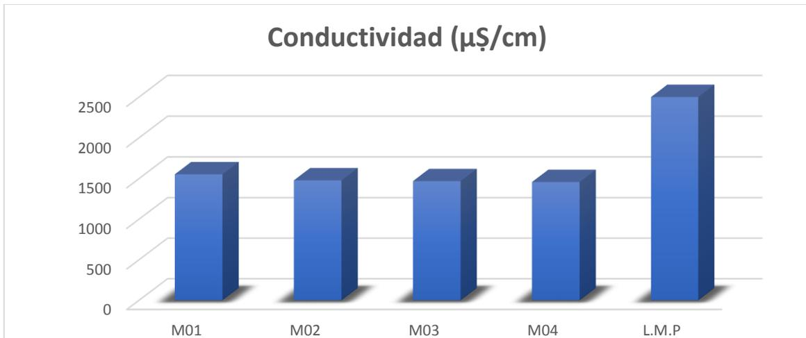
**Figura N° 03: Medida de la conductividad de las aguas residuales tratadas en el sistema de tratamiento de aguas grises para el regado de áreas verdes en la I.E. N°15509 – Talara – Piura.**
