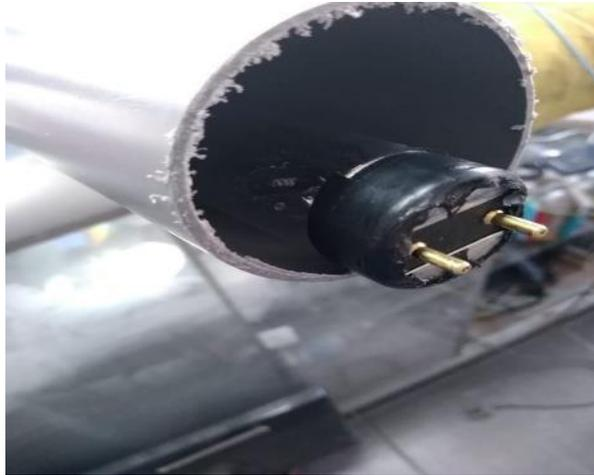
**Figura N° 27: Introducción del tubo luz Uv**
