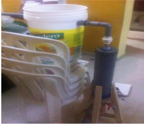
**Figura N° 19: Filtro compuesto por (algodón, gasa, piedra mediana, gasa, piedra chica, gasa, arena gruesa, gasa, arena fina)**
