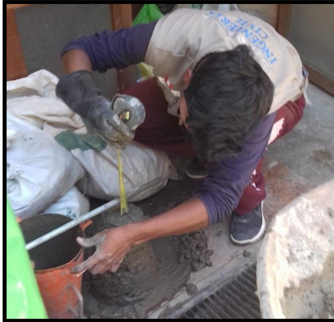
Foto N° 14: Trabajo en laboratorio, determinando el asentamiento de la mezcla del concreto al adicionar fibras de acero trefilados para una resistencia de f'c=280 \text{ kg/cm}^2 .
