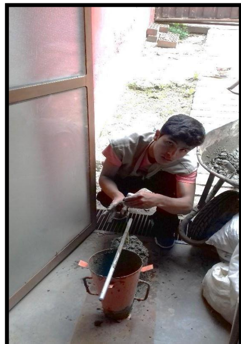
Foto N° 9: Trabajo en laboratorio, determinando el asentamiento de la mezcla del concreto patrón para una resistencia de f'c=280 \text{ kg/cm}^2 .
