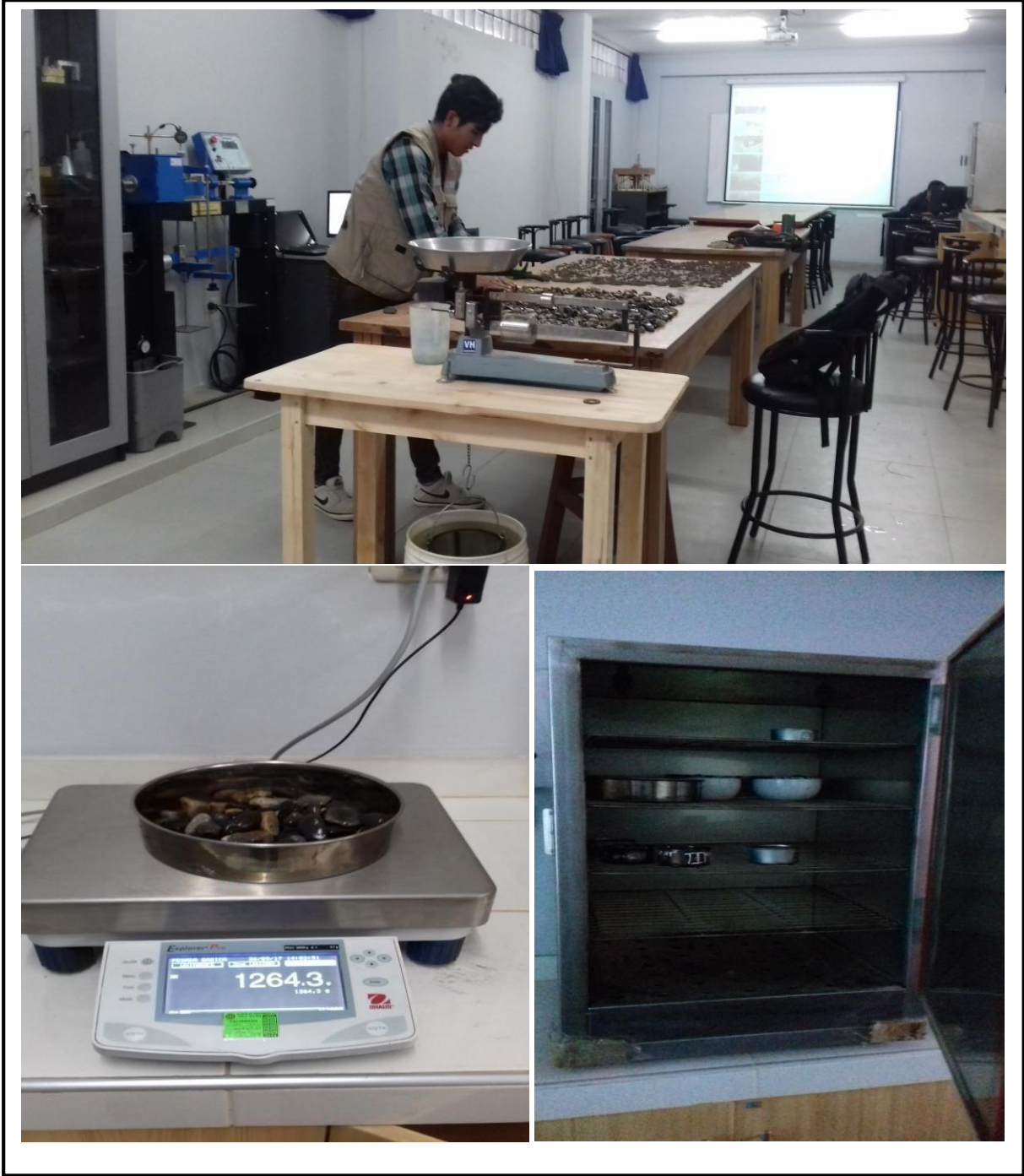
Foto N° 7: Trabajo en laboratorio, realizando el ensayo de peso específico y absorción de los agregados gruesos (piedra chancada).
