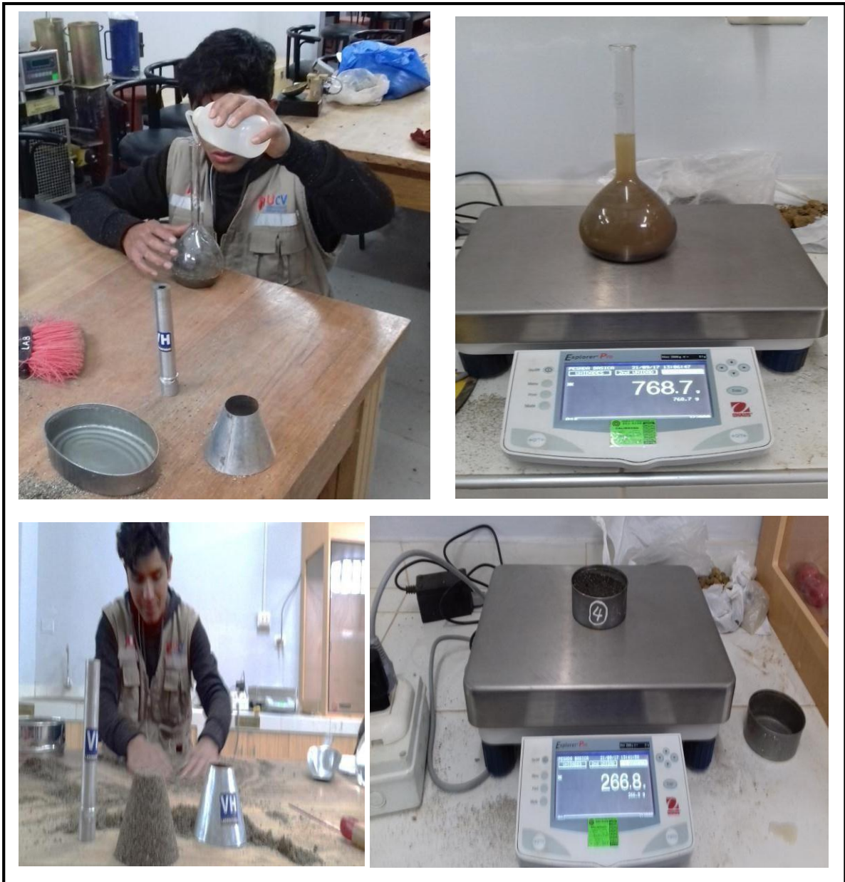
Foto N° 6: Trabajo en laboratorio, realizando el ensayo de peso específico y absorción de los agregados finos (arena gruesa).
