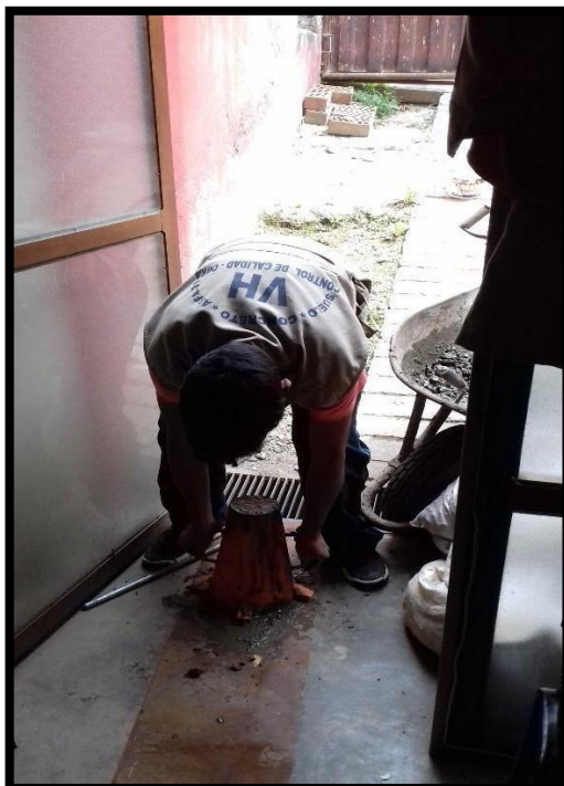
Foto N° 9: Trabajo en laboratorio, determinando el asentamiento de la mezcla del concreto patrón para una resistencia de f'c=280 \text{ kg/cm}^2 .
