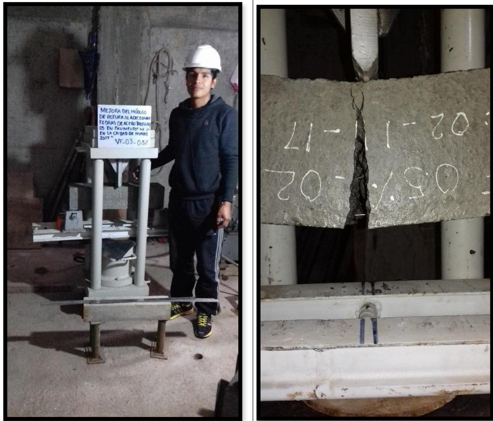
Foto N° 16: Trabajo en laboratorio, rotura de las vigas del concreto al adicionar fibras de acero trefilados para una resistencia de f'c=280 \text{ kg/cm}^2 a los 28 días.
