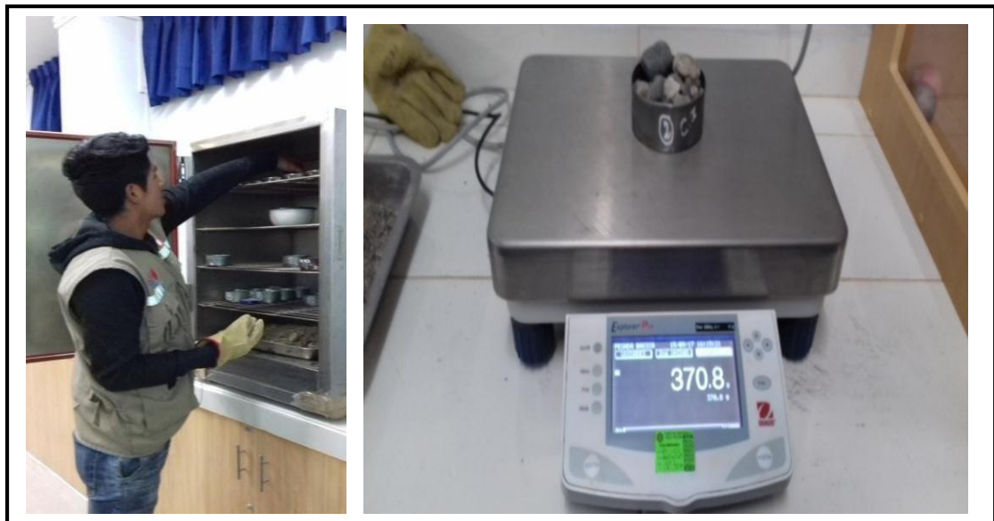
Foto N° 4: Trabajo en laboratorio, llevando la muestra al horno para determinar el contenido de humedad natural.
