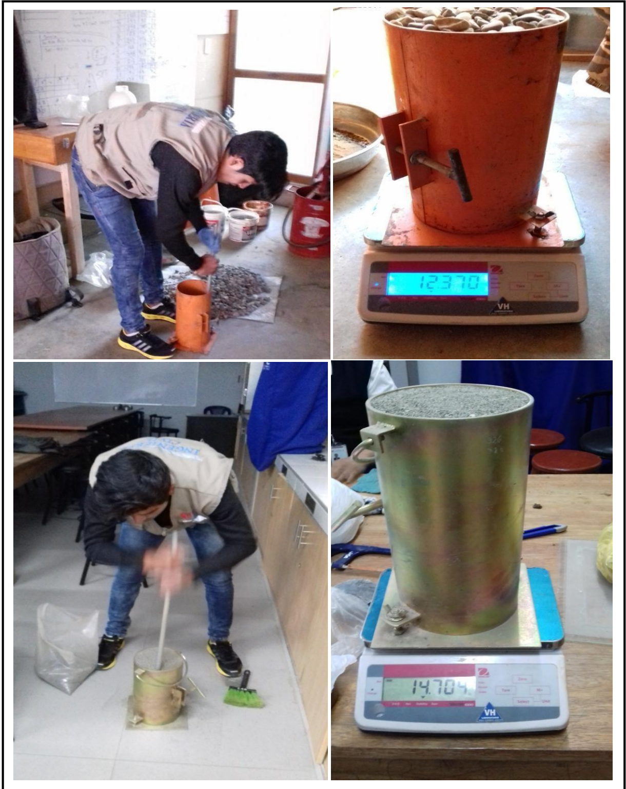
Foto N° 5: Trabajo en laboratorio, realizando el peso unitario varillado de los agregados.
