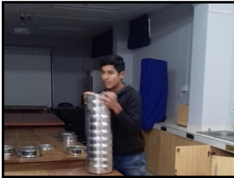
Foto N° 3: Trabajo en laboratorio, análisis granulométrico de los agregados
