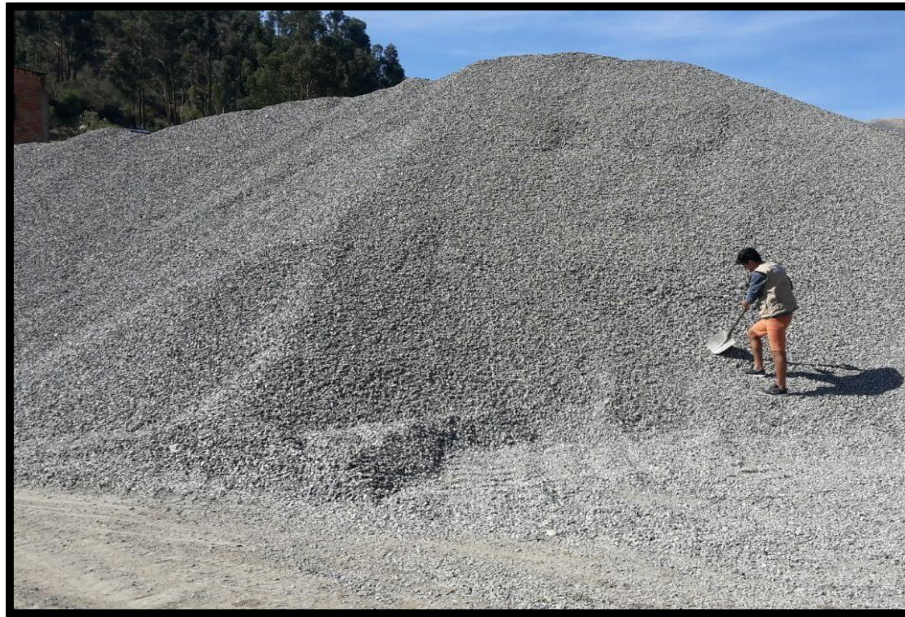
Foto N° 1: Trabajo en campo, toma de muestras de agregados gruesos de la cantera Tacllàn.
