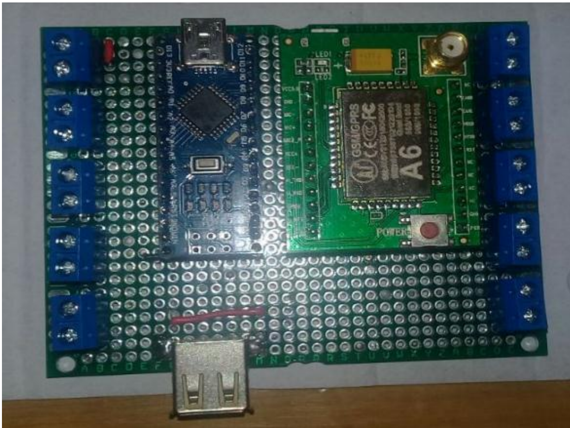
Terminal principal de donde se conectara con el sistema WEB
