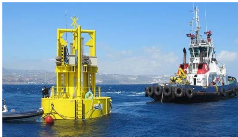
Prototipo OPT. Dispositivo absorbedor puntual
